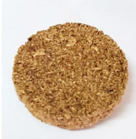
Figura 5: Material elaborado con Bagazo caña de Azúcar
