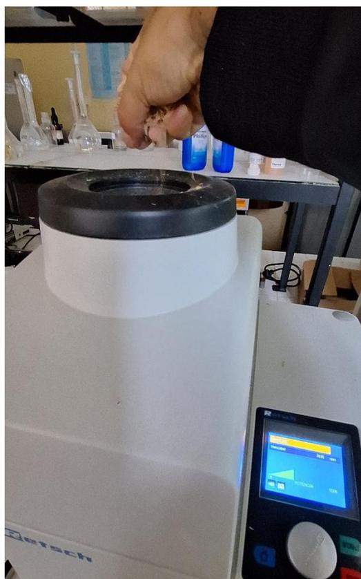
Figura 4: Molienda de Muestra Cascarilla de Arroz y Bagazo caña de Azúcar
