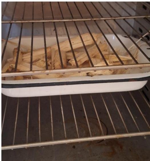
Figura 2: Secado de Muestra Bagazo caña de Azúcar
