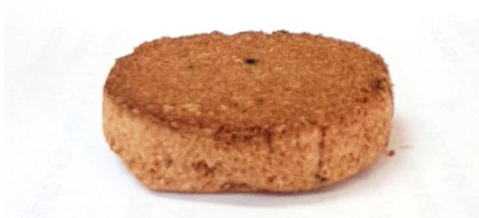
Figura 7: Material elaborado con Cascarilla de Arroz
