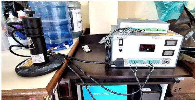
Figura 8: Modulo de Conducción Lineal de Calor H112A
