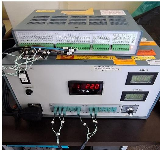
Figura 11: lecturas tomadas en el Módulo de Conducción Lineal de Calor H112A
