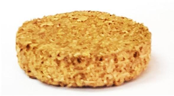
Figura 8: Material elaborado con Bagazo caña de Azúcar
