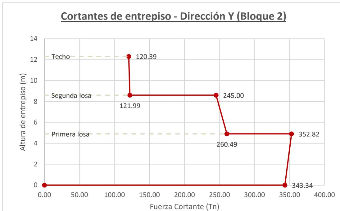
La Figura 134 mostró los valores de cortantes de entrepiso obtenidos de un análisis dinámico lineal considerando un espectro elástico, pudiendo obtener así el valor del Cortante basal elástico “Ve” en la dirección de análisis Y.
