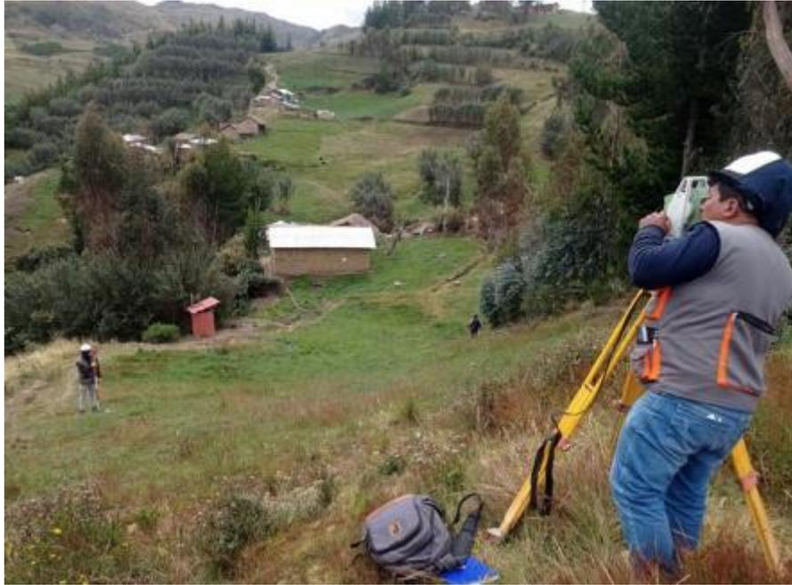
Foto 3: Se aprecia al topógrafo realizando la lectura del prisma en una parcela beneficiaria del sistema de riego
