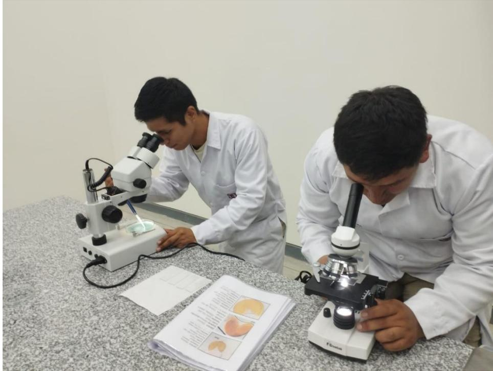
Anexo 39: Equipo investigador buscando micorrizas mediante estereoscopio y microscopio.
