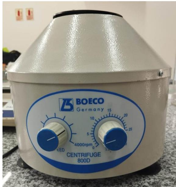
Figura 16: Centrífuga programada a 3500 rpm por 3 minutos.
