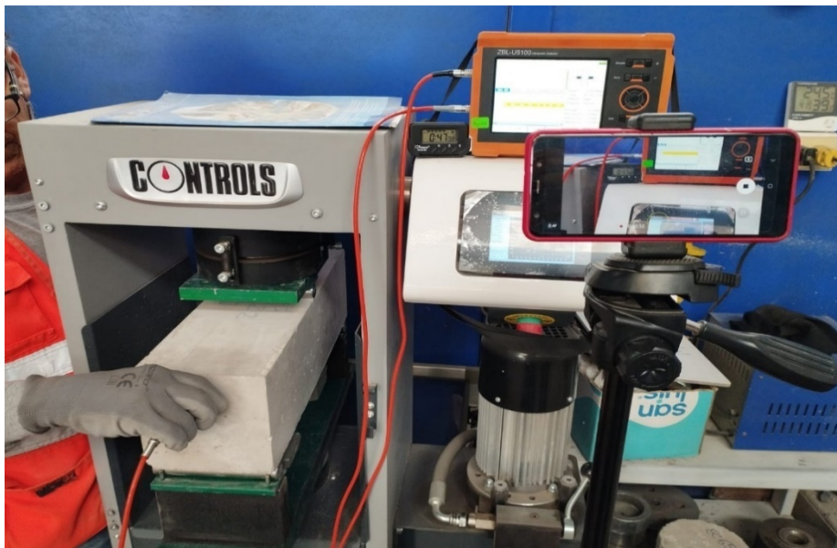
Figura 20. Ensayo de carga vs velocidad de ultrasonido
