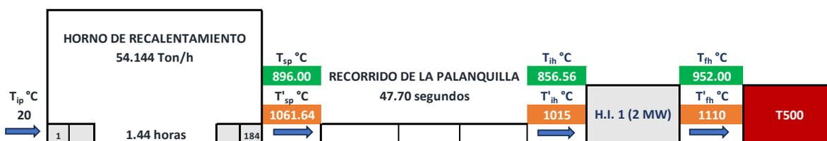
Figura 14. Diagrama de flujo del balance de energía con 01 H.I.
