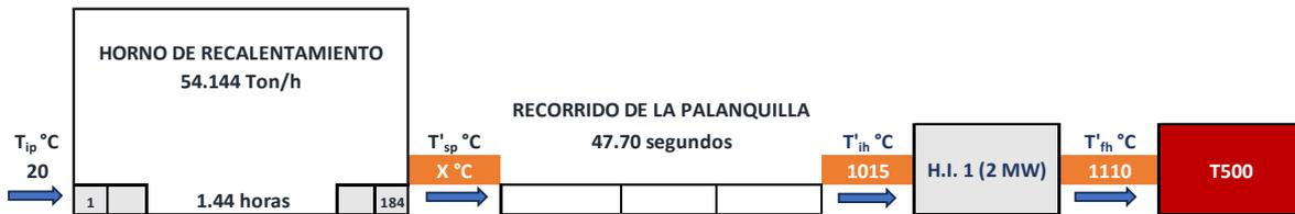
Figura 13. Diagrama de flujo proceso con H.I.
