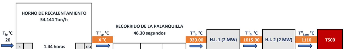
Figura 16. Diagrama de flujo proceso con 02 H.I.
