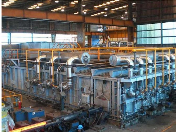
Figura 07. Horno Tipo Empuje.
