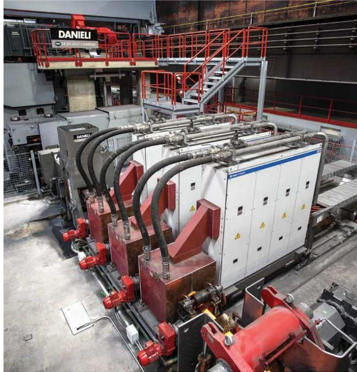
Figura 4. Hornos de Inducción para Recalentamiento de Palanquillas de Acero.
