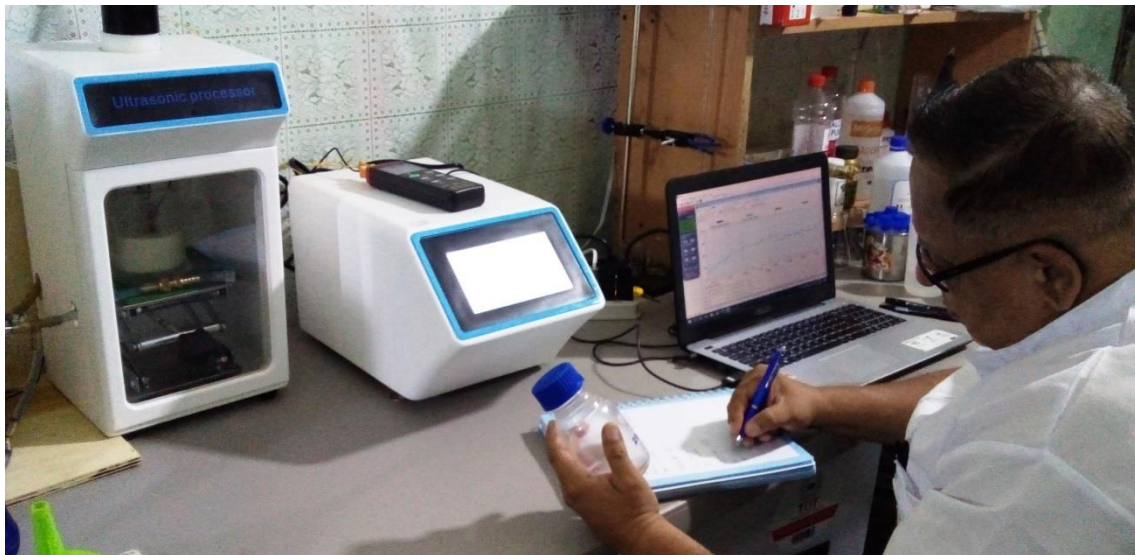
Imagen 6A1. Sonicación Isotérmica de leche (Octubre 2022)
