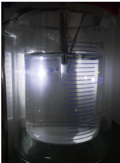
Imagen 3A1. Posición de la sonda en el reactor y posiciones relativas de los sensores térmicos del equipo sonicador y del termoregistrador.
