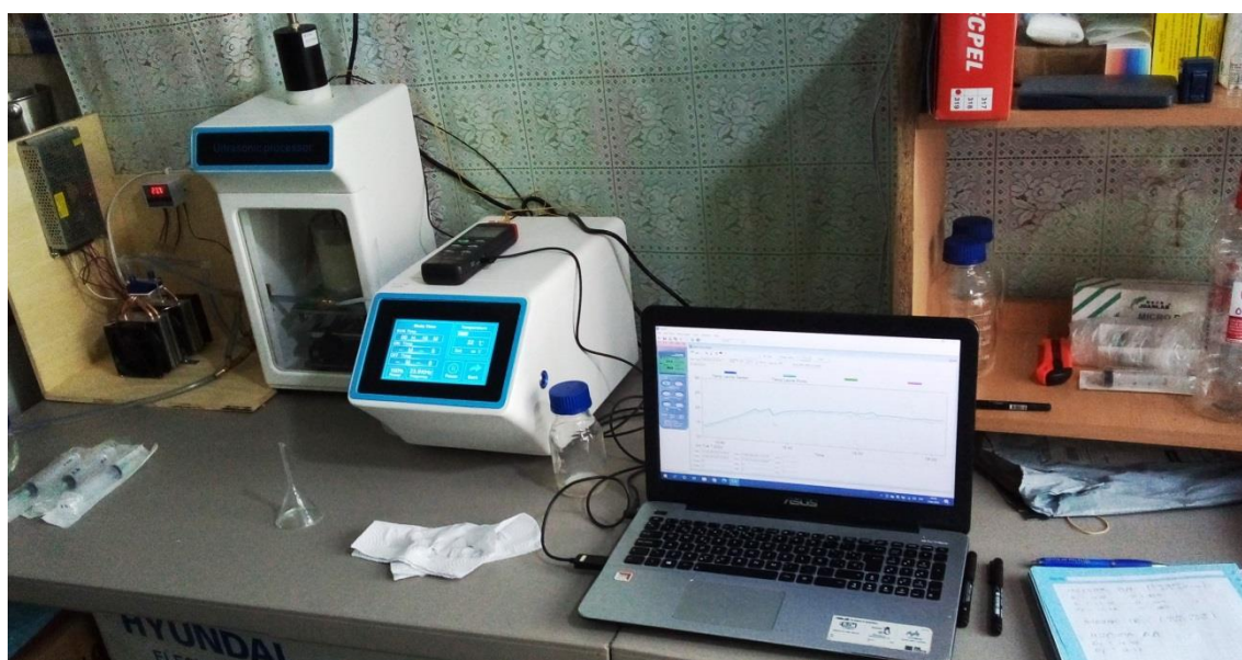
Imagen 4A1. Sonicador con equipo de refrigeración de reactor y termoregistrador en tratamiento ultrasónico isotérmico de leche.
