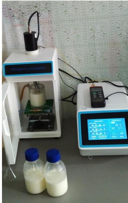
Imagen 5A1. Detalle del Sonicador cargado y programado para tratamiento ultrasónico isotérmico de leche.
