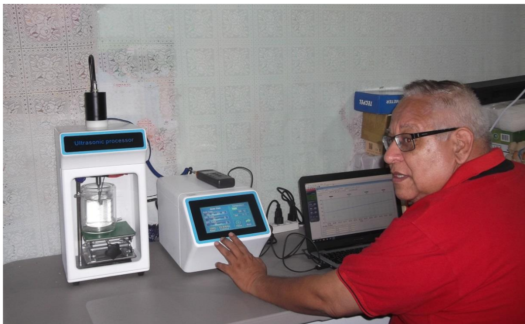
Imagen 2A1. Equipo de ultrasonidos montado y en proceso de calibración de potencia entregada
