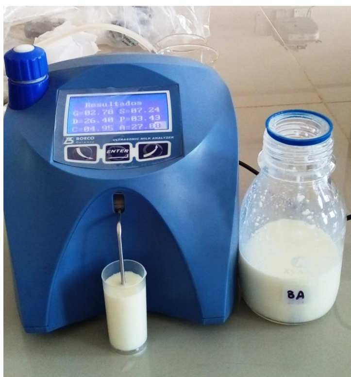
Imagen 8A1. LactoScan BOECO trabajando muestra de leche
