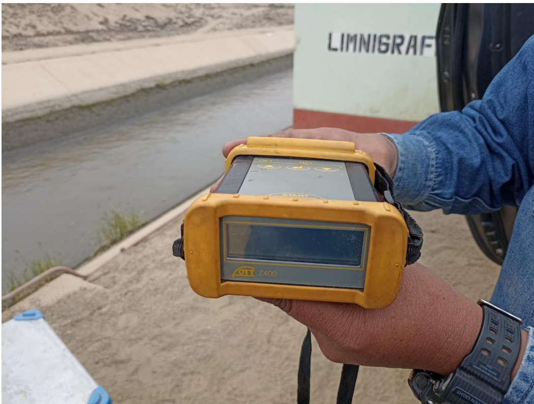
Figura 32 Vista panorámica del contador de señales para las mediciones del correntómetro
