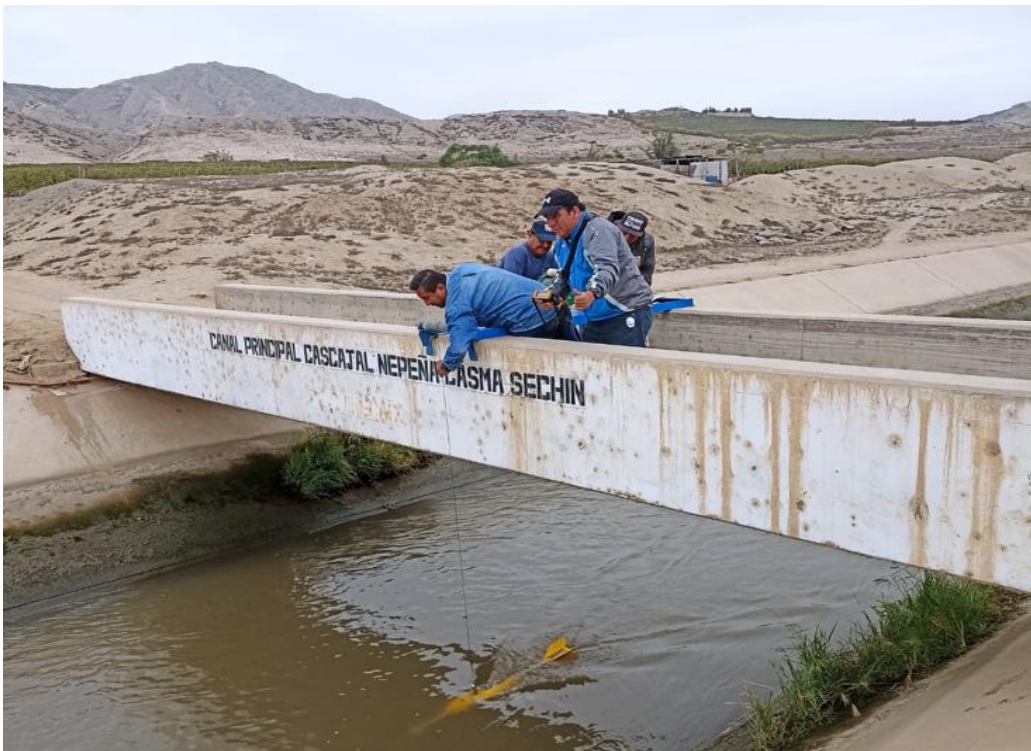
Figura 30 tomando datos (aforar) con el correntómetro del canal
