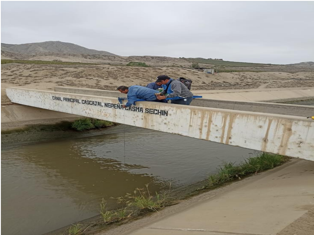
Figura 27: Realizando el aforado del canal principal Cascajal – Nepeña – Casma – Sechin
