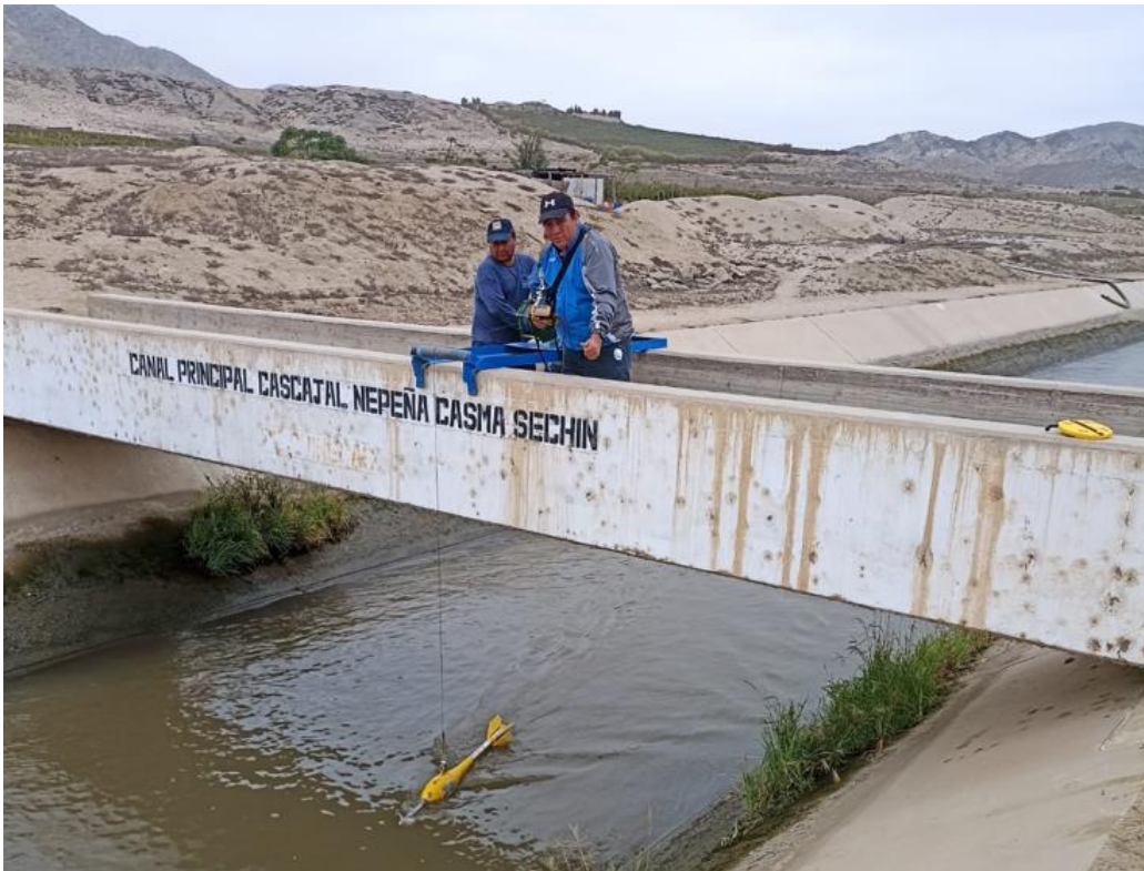
Figura 29 Vista panorámica donde se va colocando el molinete con lastre al canal para aforar
