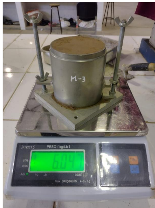
Foto 10: Pesando la muestra compactada y enrasada para determinar la densidad del material
