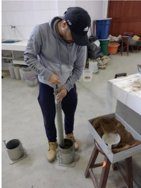
Foto 09: Realizando el ensayo de Proctor Modificado
