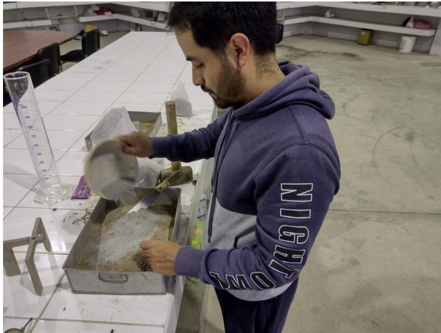
Foto 07: Preparación de la mezcla de suelo natural con Cemento
