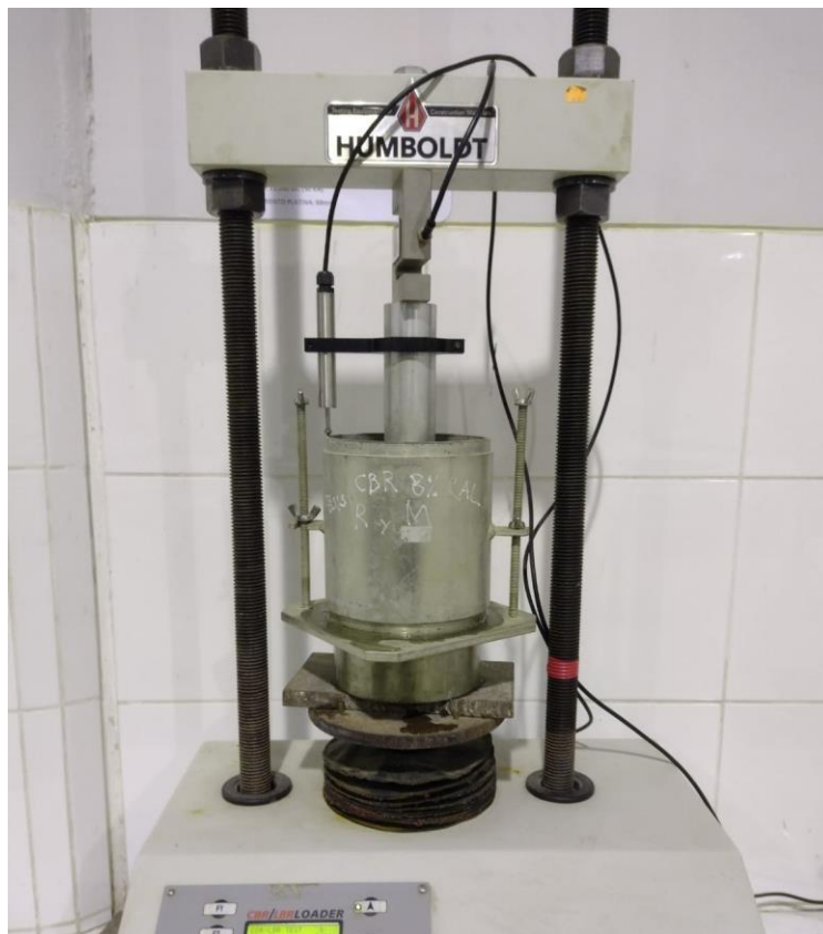
Foto 16: Ensayo De penetración a las muestras de CBR
