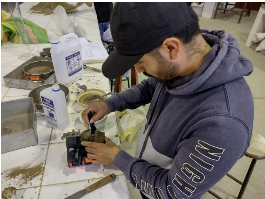
Foto 04: Tesistas realizando el ensayo de límite líquido mediante la copa Casagrande
