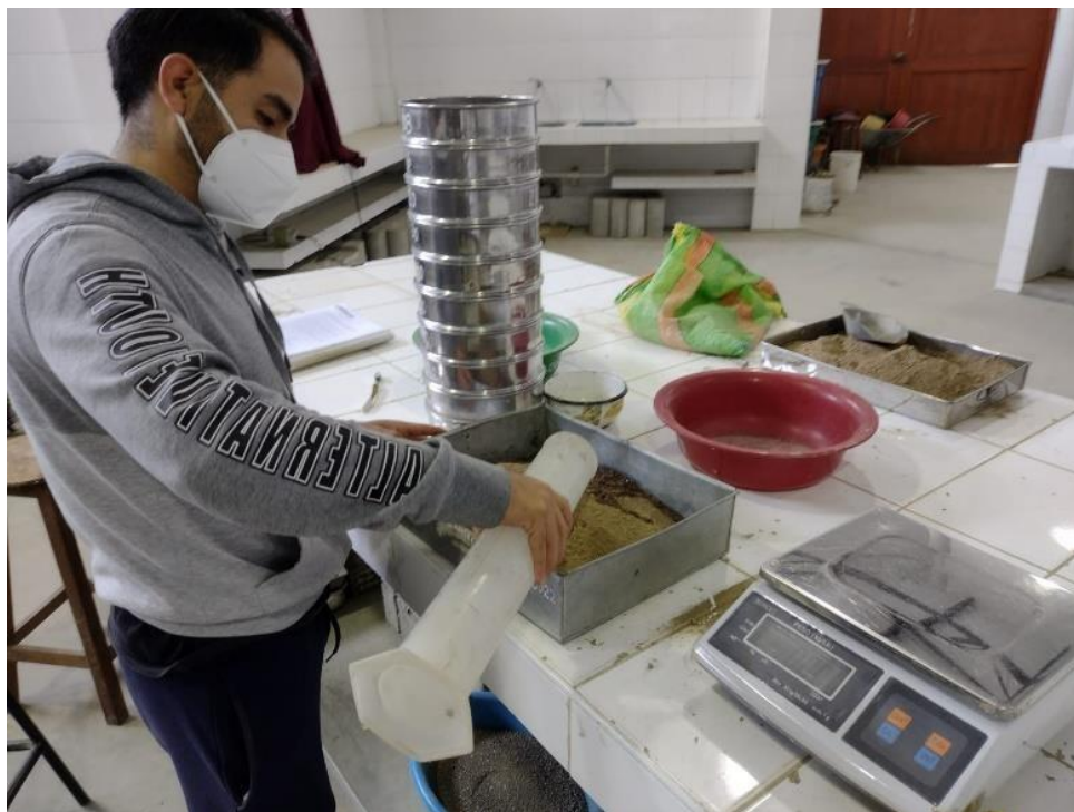
Foto 08: Agregando agua a las muestras con cal y cemento
