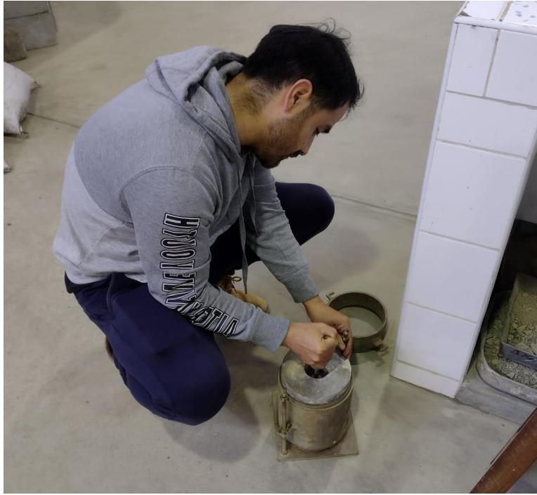
Foto 13: Colocando la sobrecarga a la muestra compactada de CBR para sumergir en agua
