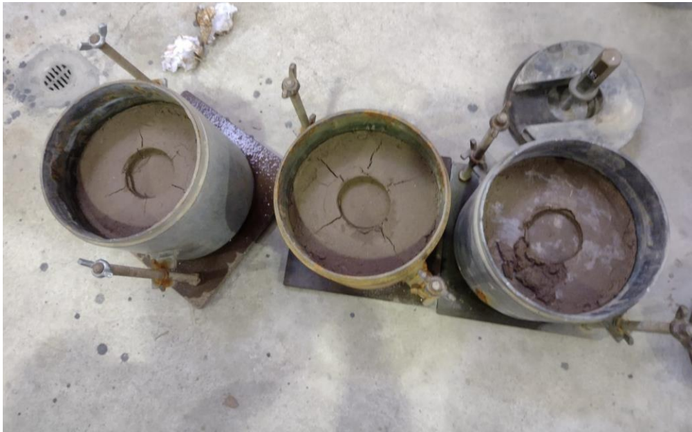
Foto 17: Muestras de CBR luego de los ensayos de penetración
