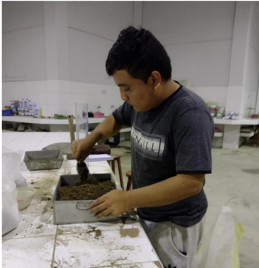
Foto 11: Muestra Con El Óptimo Contenido De Humedad
