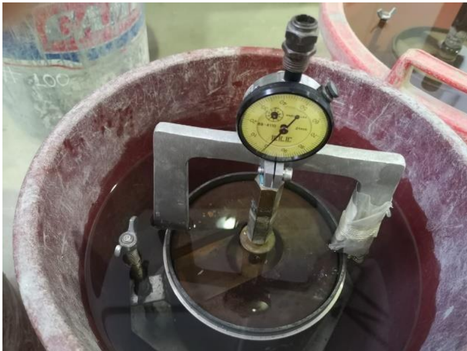
Foto 14: Colocando el exposímetro al ensayo de CBR para medir la expansión del material al sumergirlo por 96 horas
