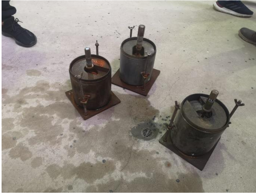
Foto 15: Las muestras de CBR saturadas luego de estar sumergidas por 96 horas y esperando se oreen para realizar el ensayo de penetración.
