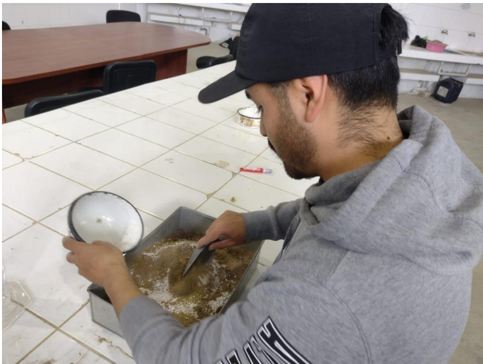
Foto 06: Preparación de la Mezcla De Suelo Natural Con Cal
