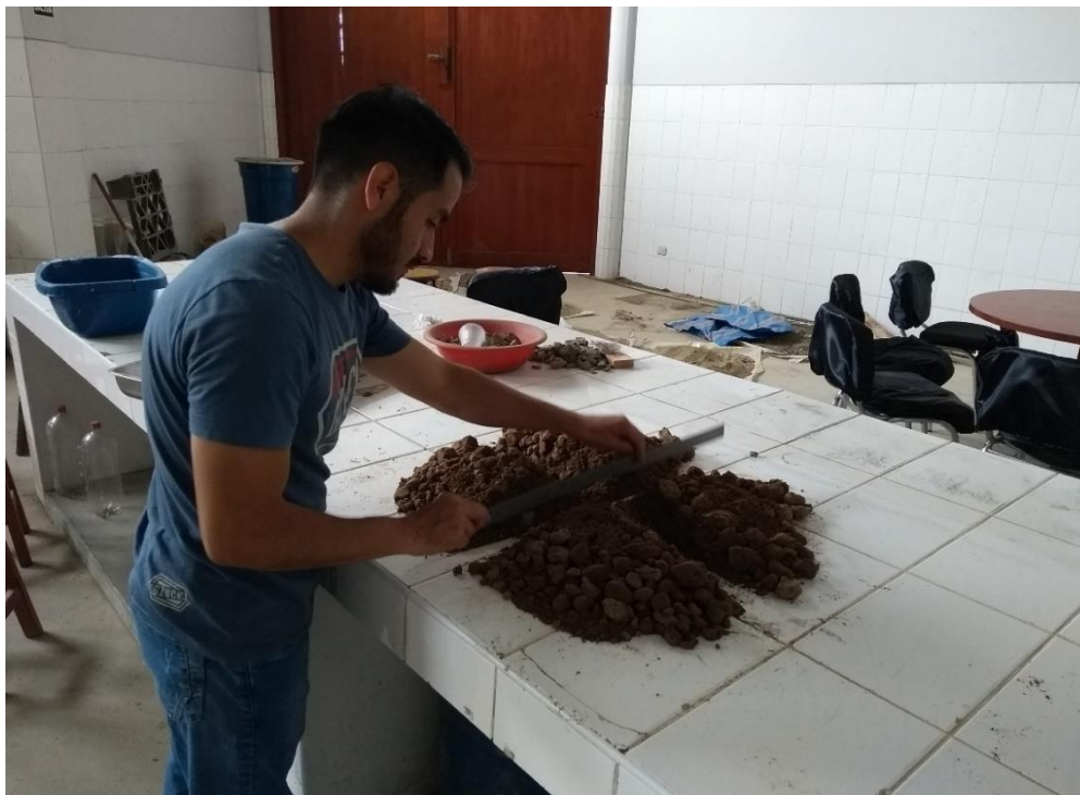
Foto 02: Iniciando con el cuarteo de la muestra del suelo natural para realizar los ensayos respectivos en los laboratorios de UNS.
