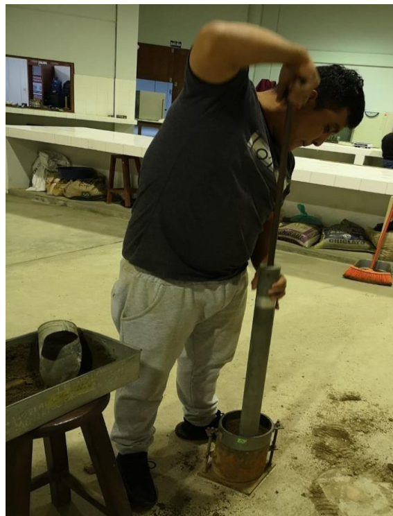
Foto 12: Realizando el ensayo de CBR
