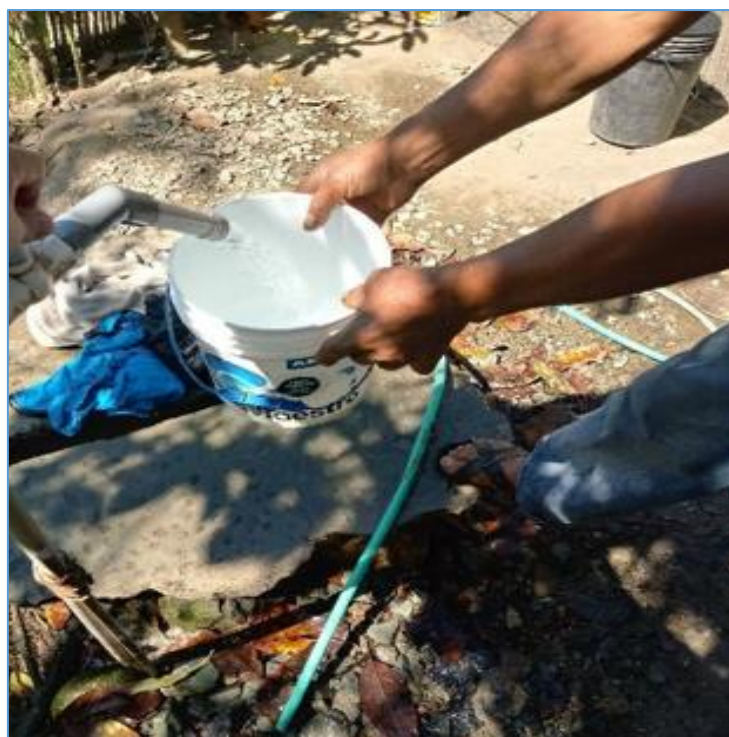
Aforo volumétrico de vivienda del C.P. Salitre
