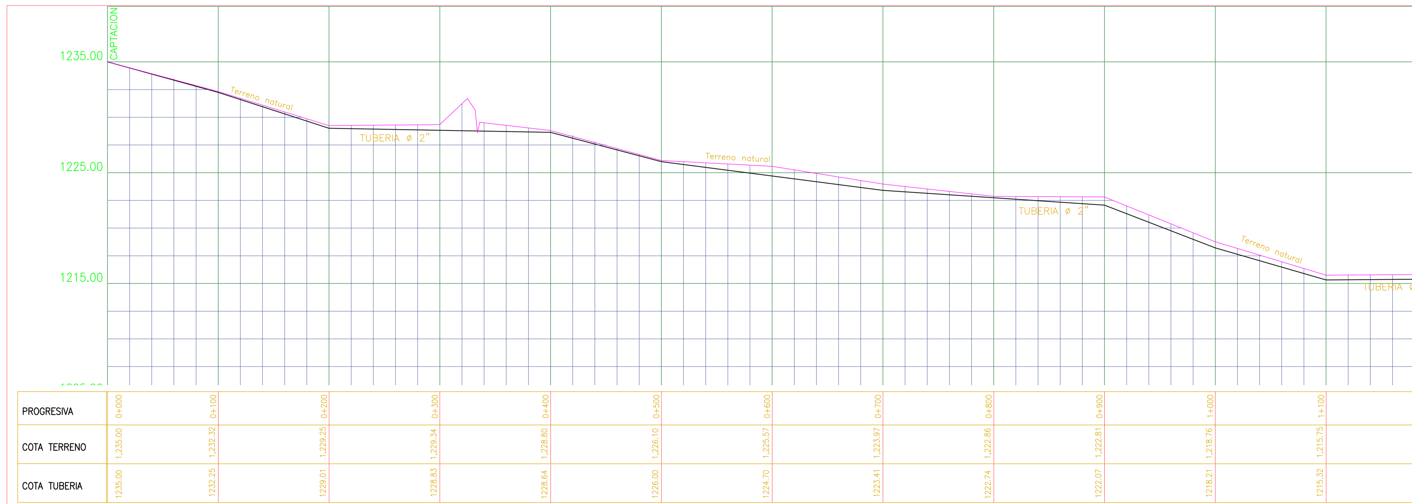
PERFIL LONGITUDINAL: TRAMO 0+000 - 1+000 ESC. H.: 1/2500 ESC. V.: 1/250
