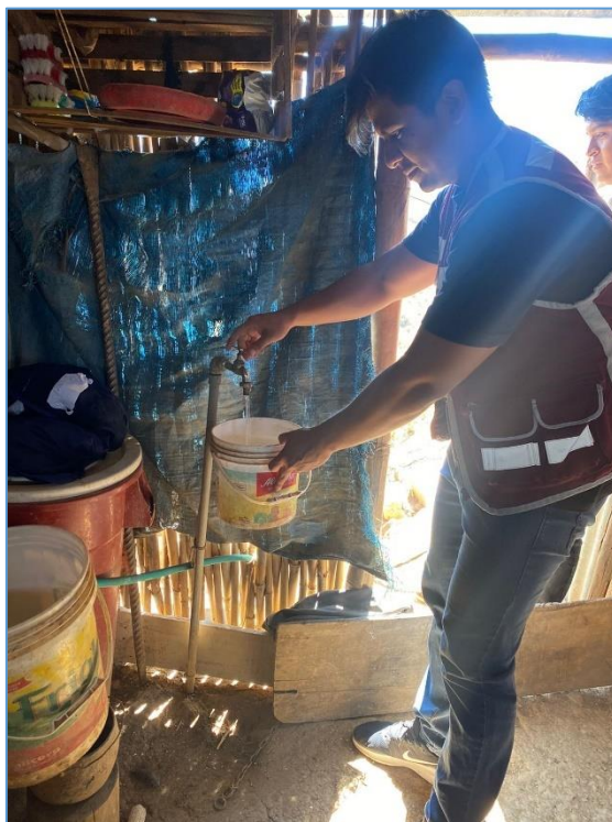
Aforo volumétrico de vivienda 02 en C.P. Jimbe
