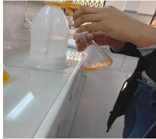
Medición de Acidez (%) usando NaOH al 0.1 N.
