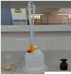
Medición de Acidez (%) usando NaOH al 0.1 N.
