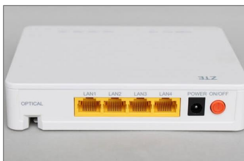
Figura 54. ONU de 4 puertos Ethernet.
