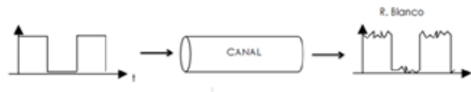
Figura 14. Ruido en fibra óptica. Fuente: (Gómez López, Puerto López, & Guevara Ibarra, 2015)
