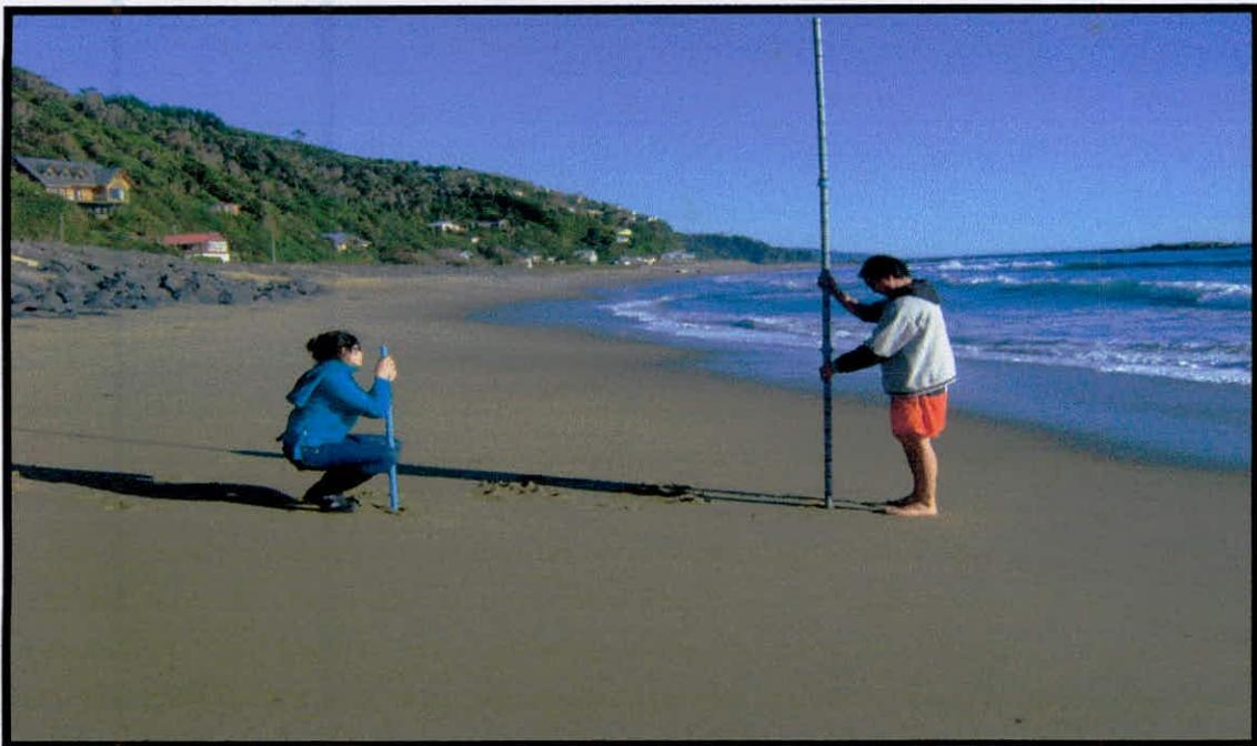
**Fig. 4** Determinación del perfil de playa por el método Emery (1961).
