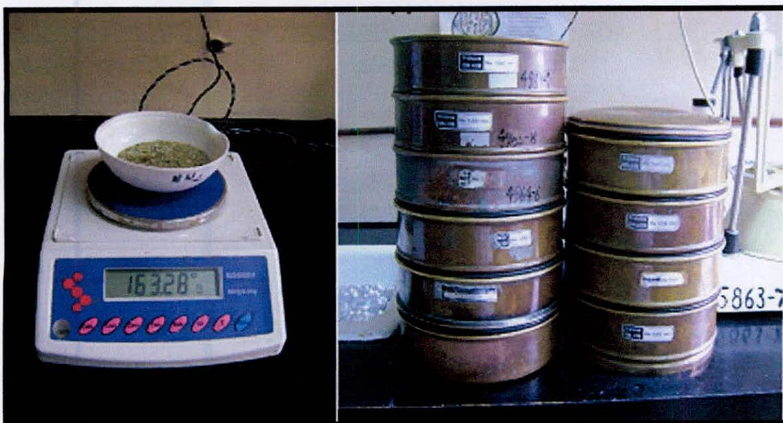
**Fig. 3** (Izquierda) Balanza analítica y (Derecha) sets de tamices empleados para analizar el sedimento.
