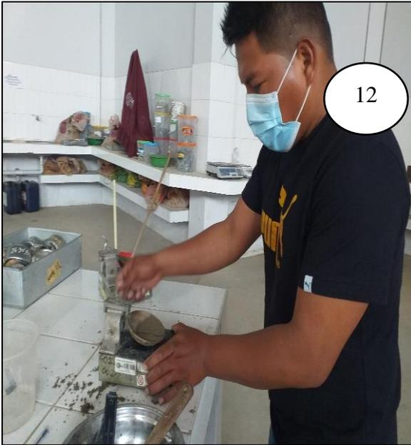
FOTOGRAFÍA N° 12: Ensayos de límite líquido usando la copa de Casagrande para la muestra C1.
