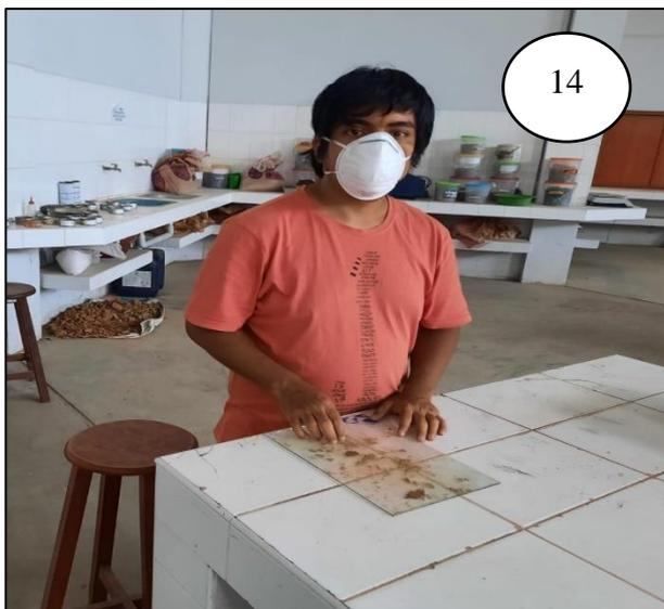
FOTOGRAFÍA N° 14: Ensayo del límite plástico de la muestra C1.
