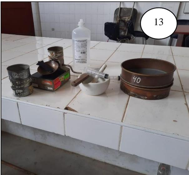
FOTOGRAFÍA N° 13: Materiales utilizados para el ensayo de límite líquido.
