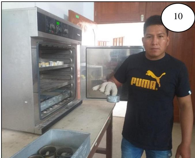
FOTOGRAFÍA N° 10: Secado de muestras para determinar el porcentaje de contenido de humedad.
