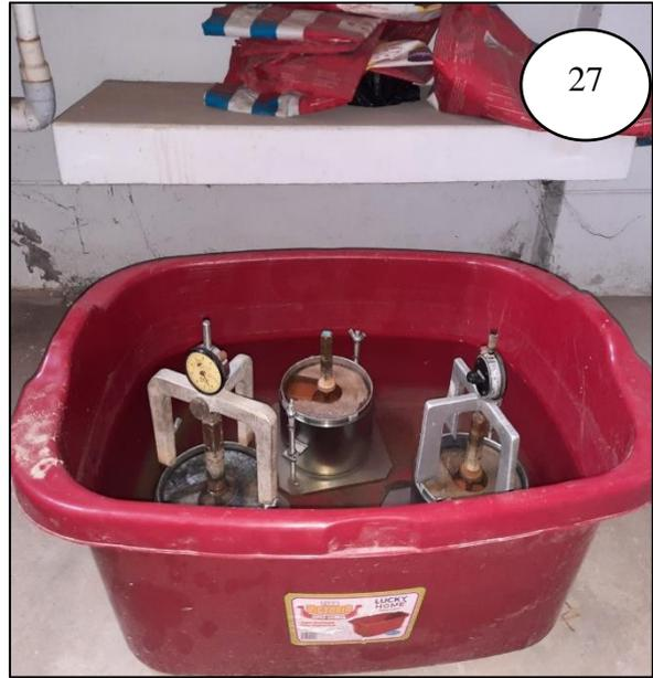
FOTOGRAFÍA N° 26 y 27: Se colocó los moldes con muestras de suelo con adición de cal o cemento para el proceso de saturación.
