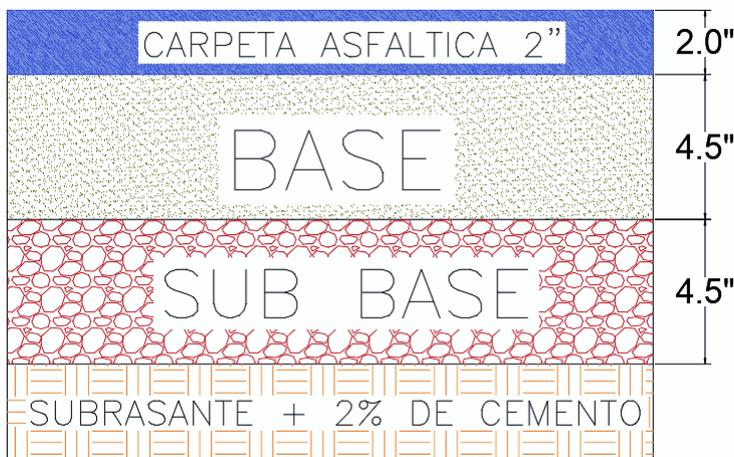
**Figura 57:** Estructura del pavimento adecuado, para una subrasante con adición de cemento
