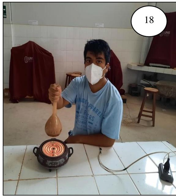
FOTOGRAFÍA N° 17: Llenado con agua destilada y vertido de una muestra representativa, hasta la marca de calibración en el picnómetro.
