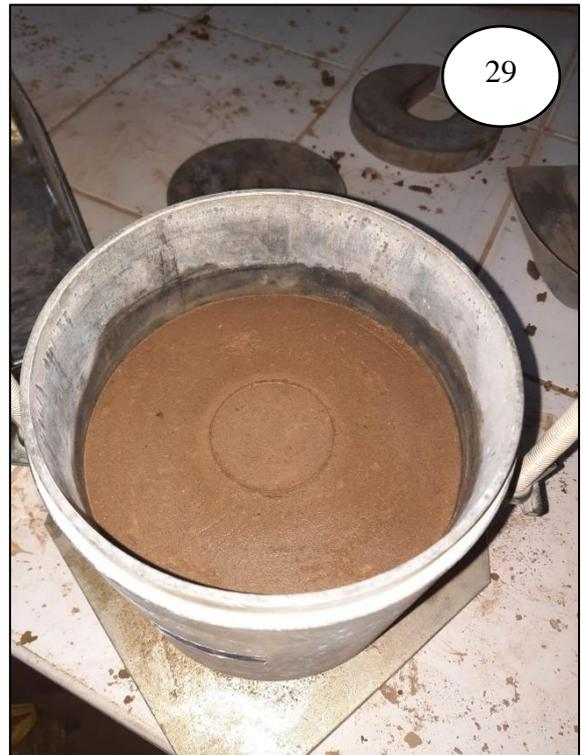
FOTOGRAFÍA N° 28 y 29: Se colocó el molde, con muestra de suelo más cal o cemento, en la máquina para el ensayo de C.B.R.
