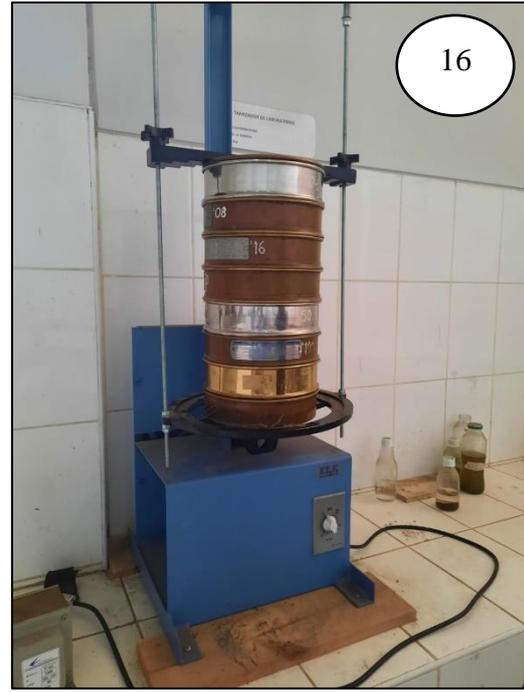
FOTOGRAFÍA N° 15 y 16: Realización de tamizaje, para determinar su análisis granulométrico.
