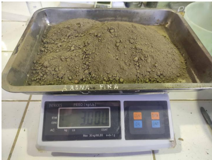
Fotografías N° 42, 43 y 44. Pesaje y medición de los materiales para realizar el ensayo Proctor modificado de terreno natural.
