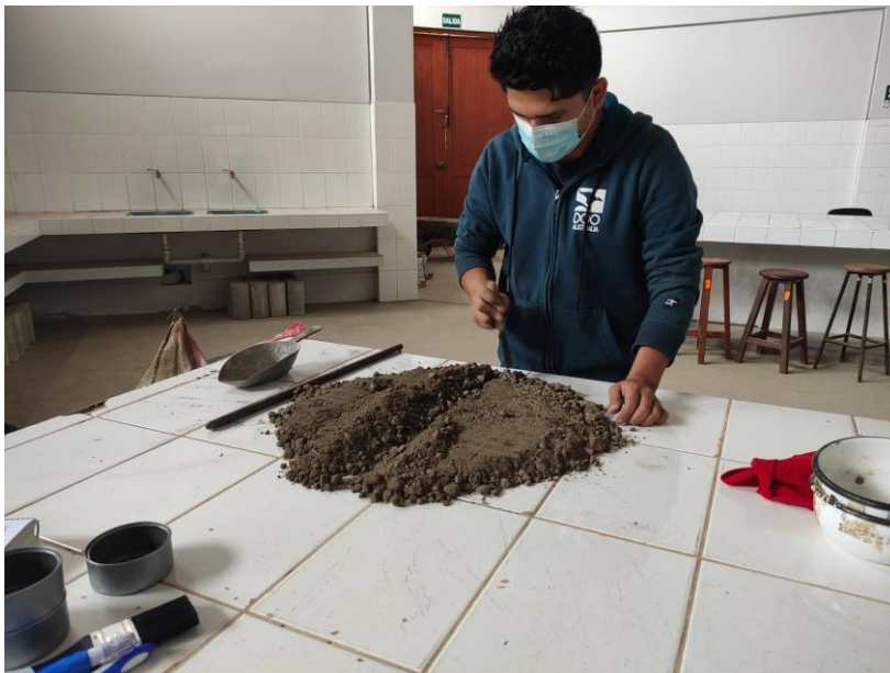
Fotografías N° 9, 10 y 11. Obtención de muestra representativa de cada calicata mediante la técnica de cuarteo (MTC E 105)
