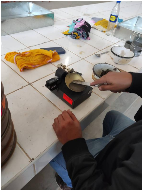
Fotografías N° 29, 30 y 31. Preparación de la pasta uniforme adicionando al material agua destilada para su posterior colocación en la copa de Casagrande con ayuda de una espátula.
