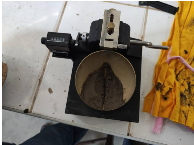
Fotografía N°33. Vista de la muestra cerrada una longitud aproximada de 13mm indicando el término del ensayo en la copa de Casagrande.
