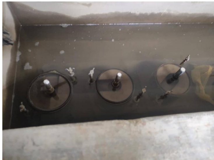
Fotografía N° 66. Sumersión de los moldes en agua por un periodo de 96 horas para inicio del proceso de saturación del CBR realizado a las muestras de suelo natural combinadas con emulsión asfáltica.
