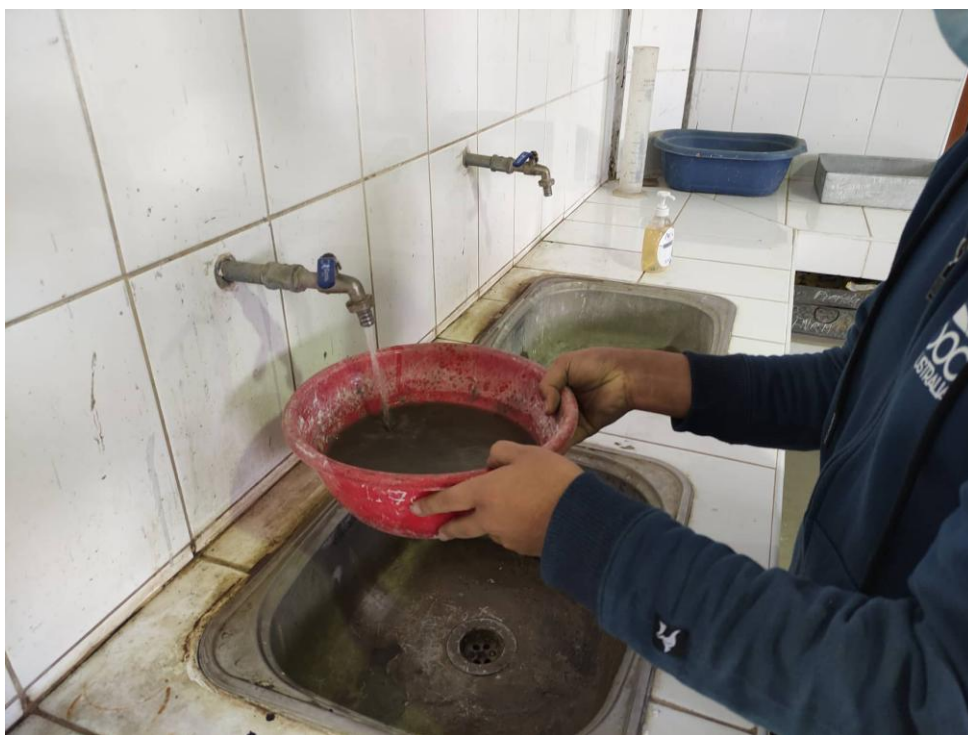
Fotografía N°16. Adición de agua en la muestra representativa para disgregar terrones
