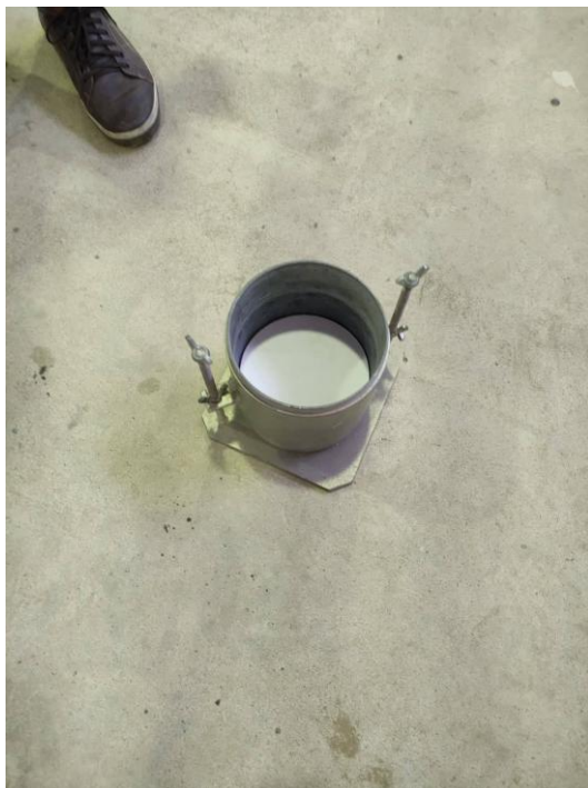
Fotografías N° 50, 51 y 52. Elaboración del espécimen del suelo natural para el ensayo CBR, pesaje del molde junto a la base, y ensamblaje de este con el collarín de extensión, además de la colocación interior de un disco espaciador y un papel filtro del mismo diámetro.
