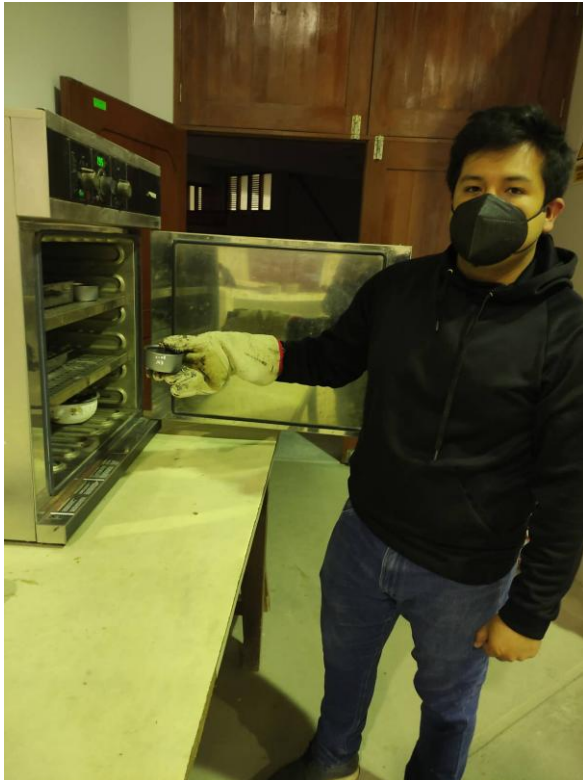
Fotografías N° 34, 35 y 36. Obtención de una porción representativa de la pasta uniforme luego del ensayo para su posterior colocación en el horno eléctrico con el fin de determinar el contenido de humedad correspondiente. (MTC E 110)
