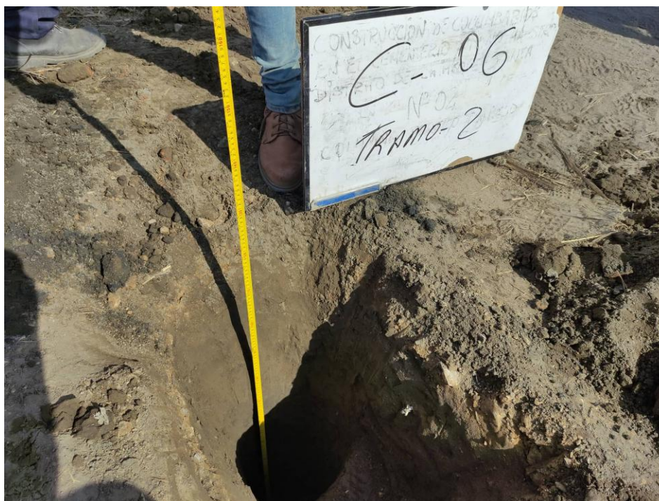
Fotografía N°6. Medición de la profundidad alcanzada debido al nivel freático.
