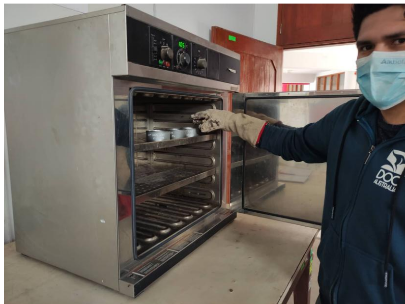
Fotografías N° 12, 13 y 14. Procedimiento para determinar el contenido de humedad natural de cada calicata (MTC E 108)
