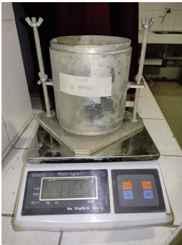
Fotografías N° 56, 57 y 58. Procedimiento de volteo del molde para quitar el disco espaciador y dejar espacio para las sobrecargas, así también como su posterior pesaje del molde conteniendo el espécimen compactado.
