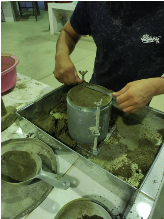
Fotografías N° 53, 54 y 55. Compactación del espécimen dentro del molde en 5 capas, en este específicamente con 56 golpes por capa, los restantes dos moldes se compactan con 25 y 10 golpes por capa con ayuda del pisón, además en todos estos luego se les retira el collar para la realización del enrasado.
