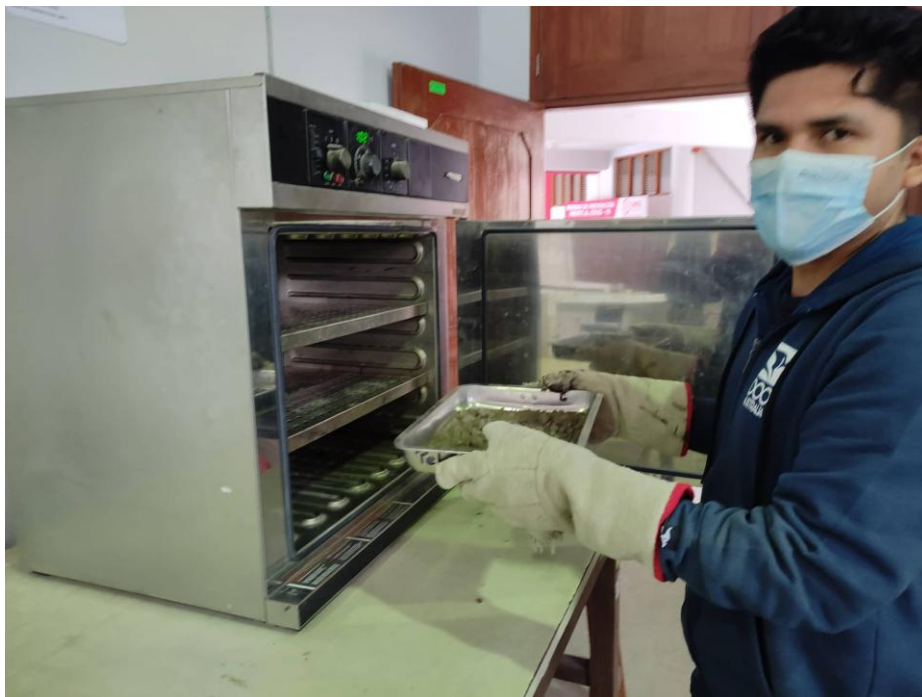
Fotografía N°15. Retiro del horno de la muestra representativa luego de 24 horas para realizar granulometría por lavado.
