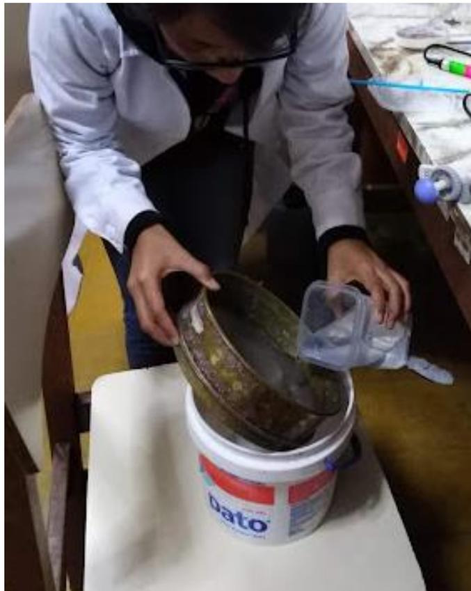
Figura 23. Recambio de agua en tamiz de 45  $\mu$ m
