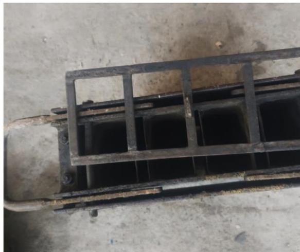
*Figura 16: Molde cubierto con desmoldante*
