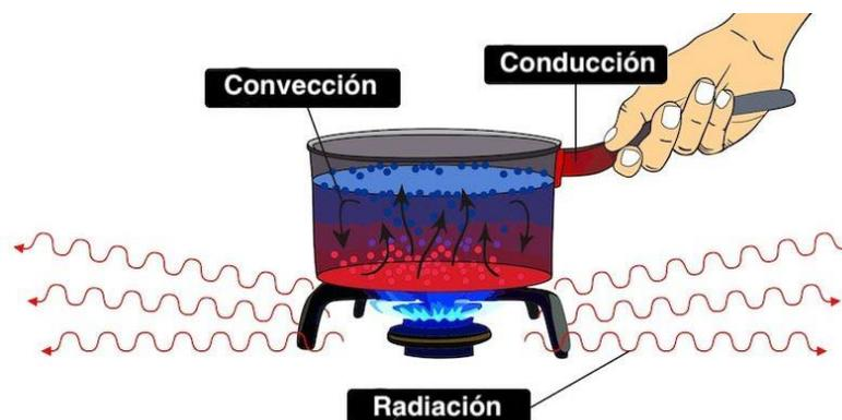
*Figura 3: Transmisión del calor*
