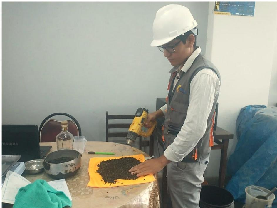
**Figura 56:** Empleo de pistola de calor para obtener muestra saturada superficialmente seca, ensayo de peso específico y absorción del agregado grueso.
