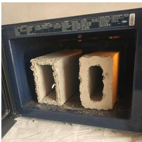
**Figura 41:** Secado al horno de muestras, ensayo % contenido de humedad
