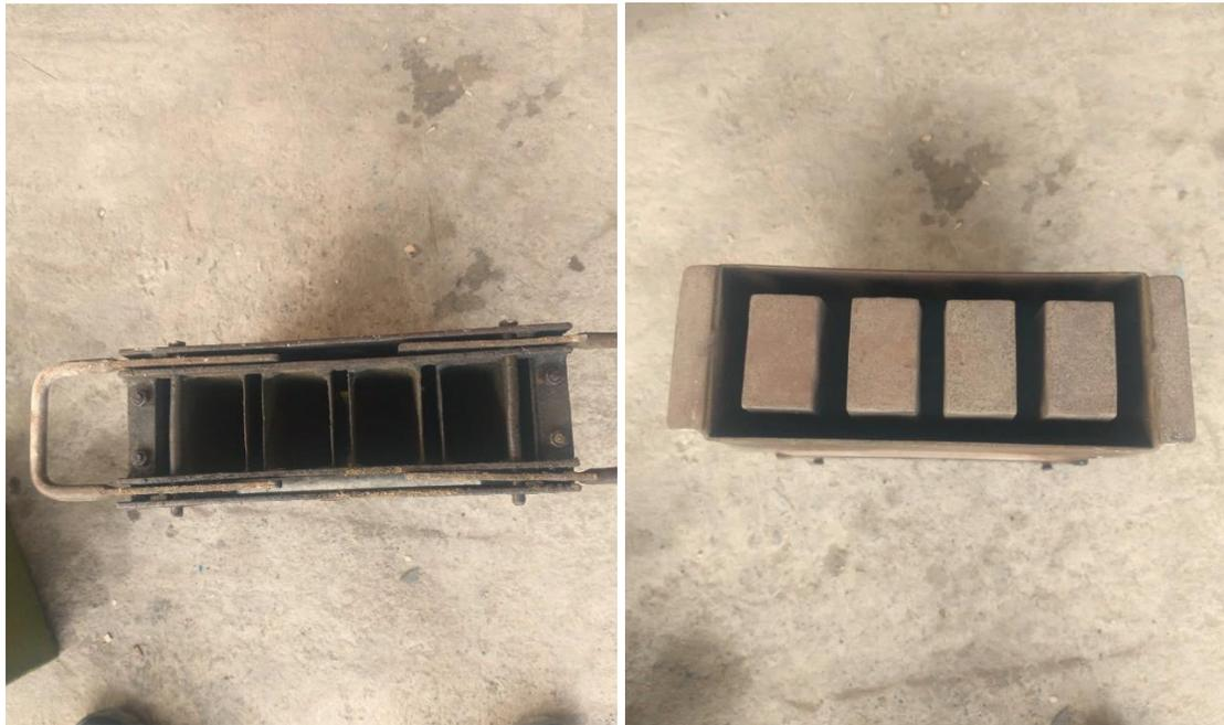
*Figura 62: Molde metálico diseñado para la elaboración del bloque*
