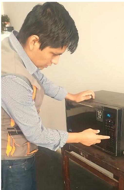
*Figura 58: Secado al horno microondas de muestras para ensayo de contenido de humedad*
