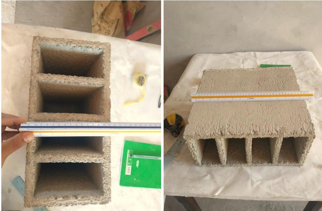
*Figura 68: Ensayo de variación dimensional a unidades de albañilería*
