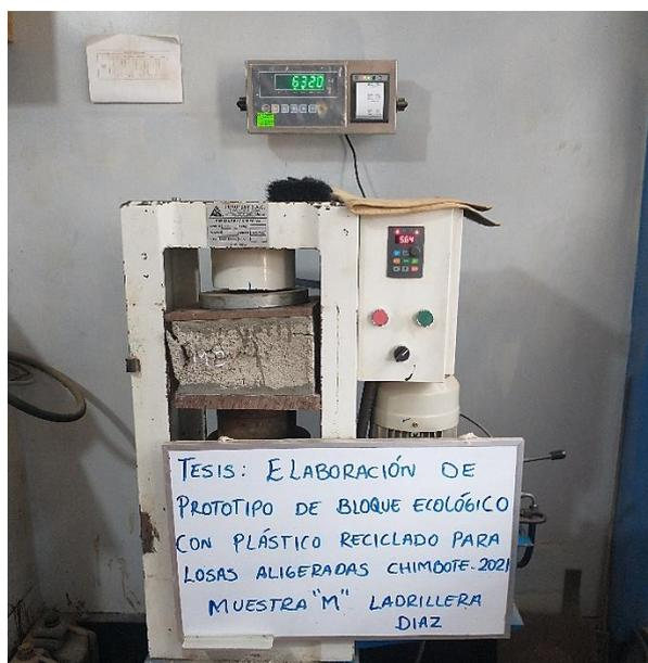
*Figura 7: Ensayo de resistencia a la compresión del bloque ecológico*
