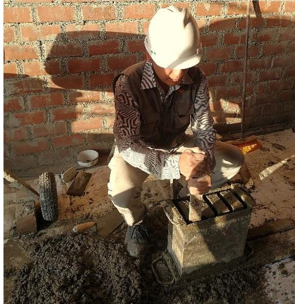
*Figura 20: Colocación en molde y compactación*
