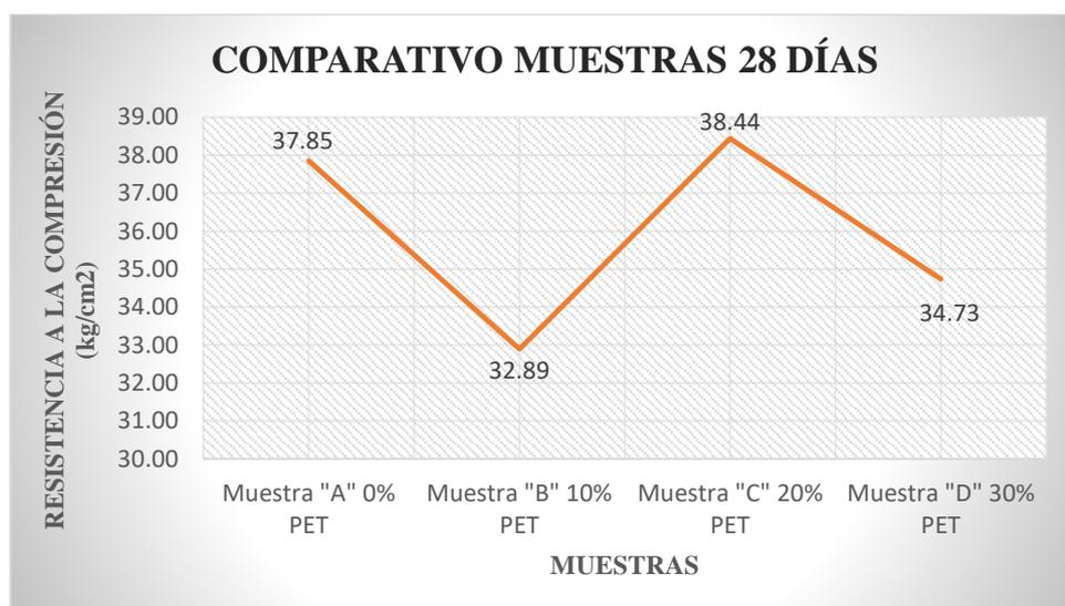
**Figura 50:** Gráfico comparativo de incremento de resistencias, muestras A, B, C y D a los 28 días
