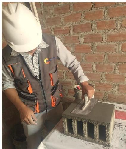
**Figura 42:** Refrentado de bloques para ensayo a la compresión
