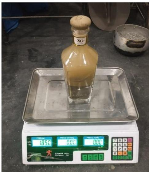
*Figura 26: Ensayo de peso específico de arena gruesa*
