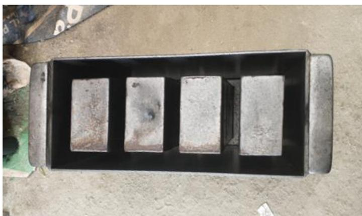
**Figura 14:** Molde metálico para bloque (parte inferior)
