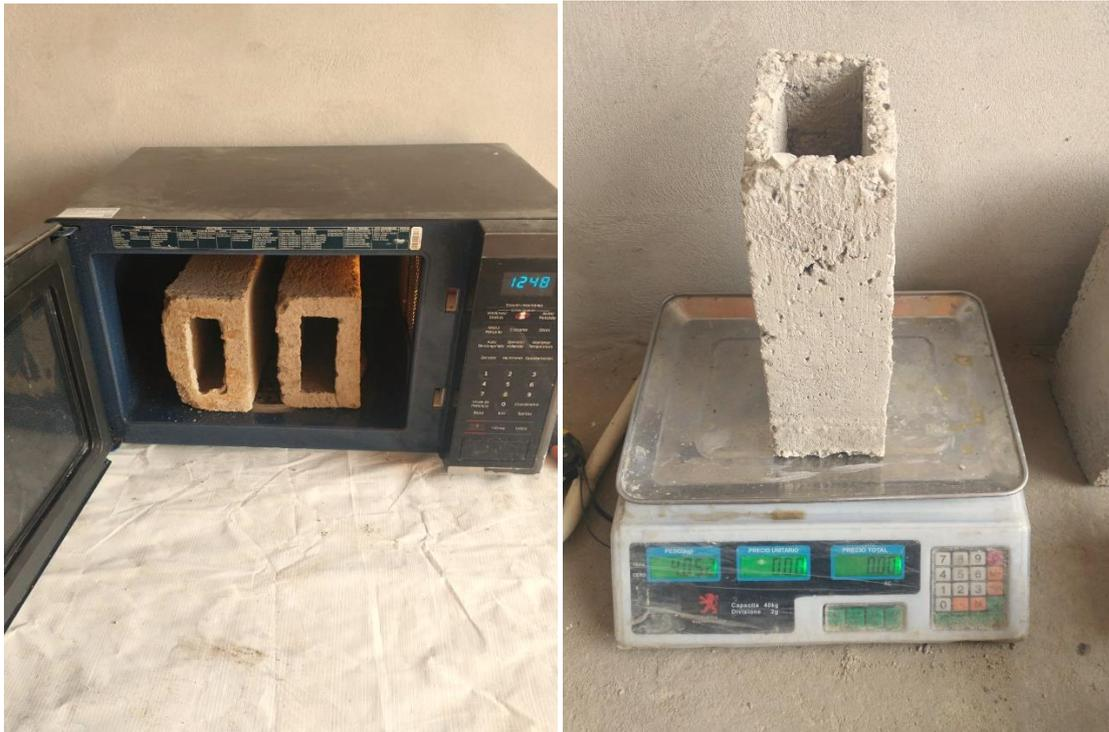
*Figura 72: Peso seco al horno de las muestras*
