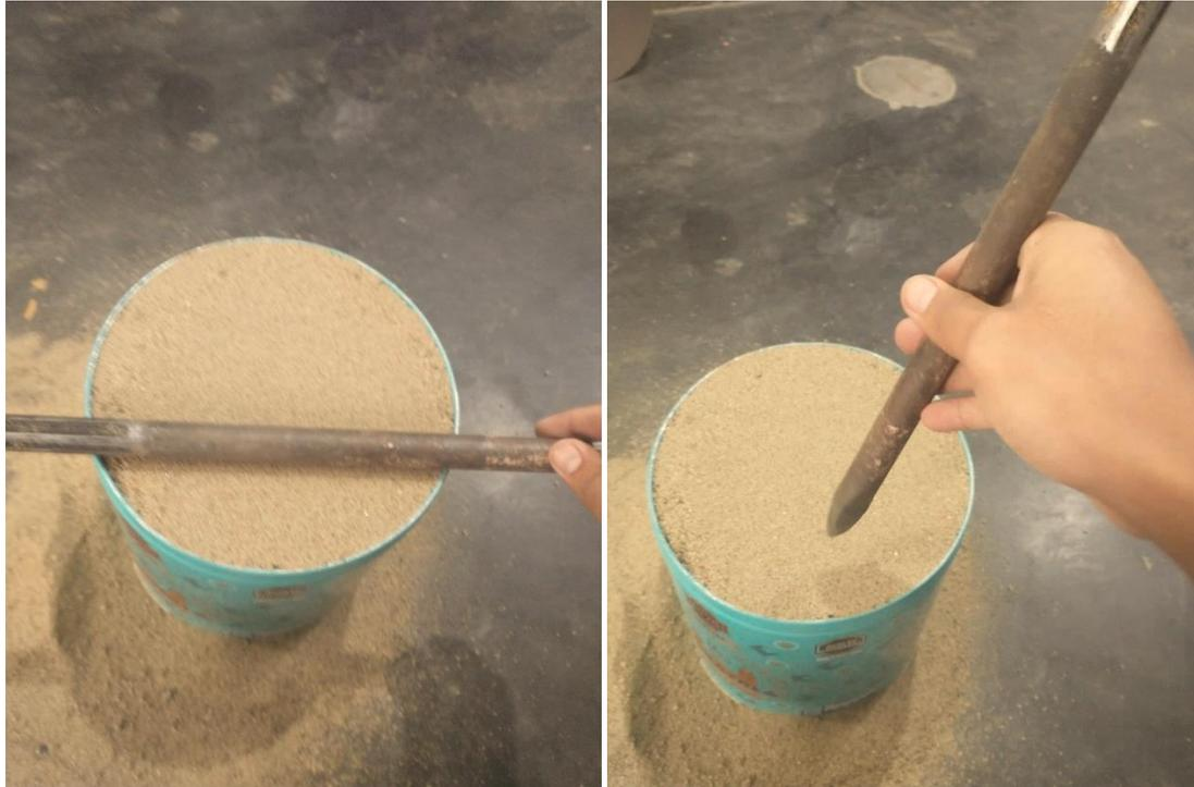
**Figura 60:** Ensayos de peso unitario suelto y compactado, agregado fino
