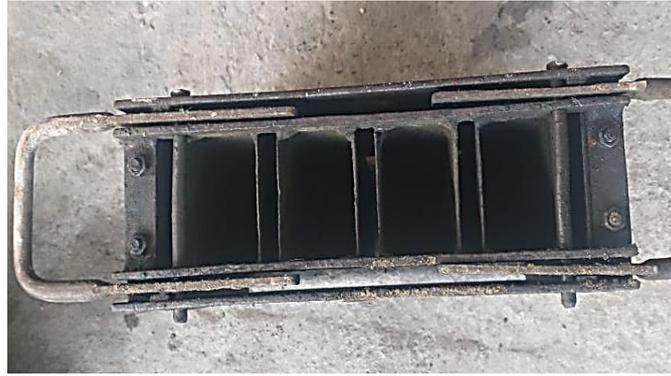
*Figura 15: Molde metálico para bloque (parte superior)*
