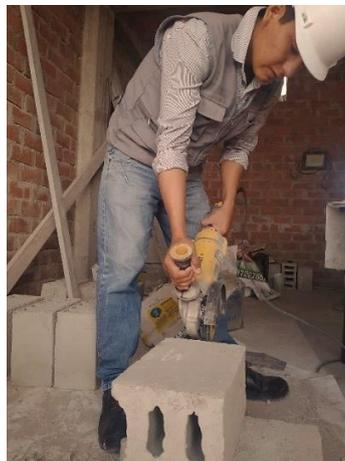
**Figura 38:** Corte de los bloques para el ensayo de absorción
