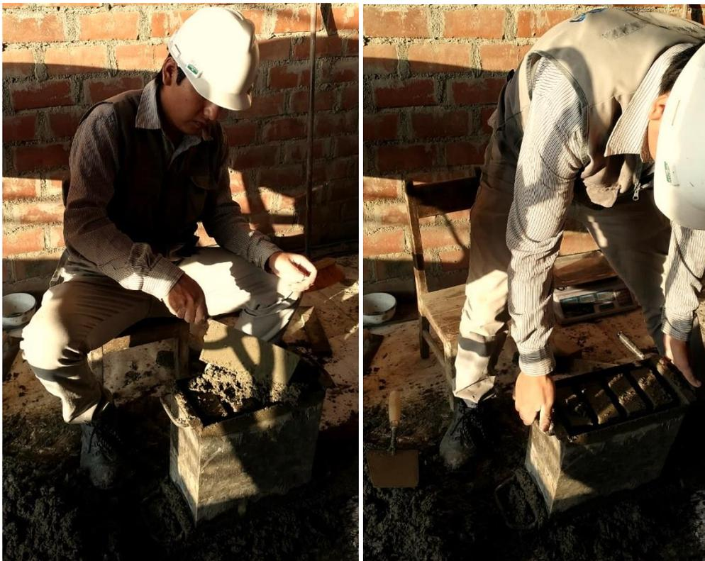
*Figura 65: Moldeado y vibrado del bloque*
