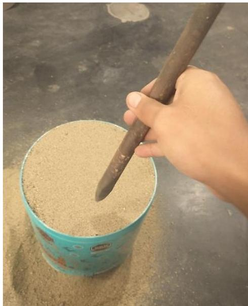
*Figura 33: Ensayo peso unitario compactado - agregado fino*
