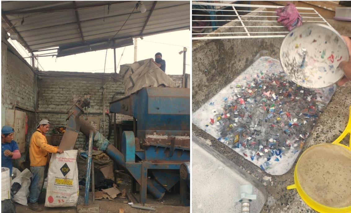
*Figura 52: Triturado y lavado de las botellas plásticas recicladas*
