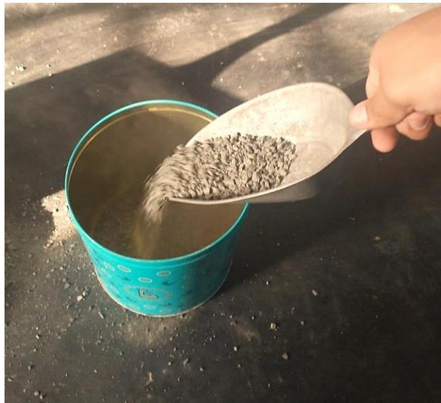
*Figura 32: Ensayo peso unitario suelto - agregado grueso*
