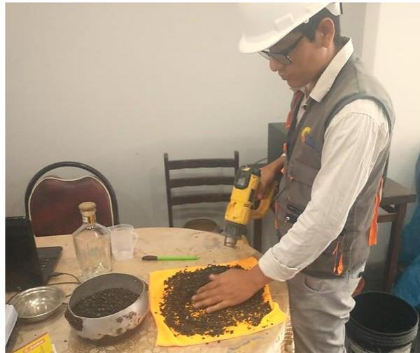
**Figura 29:** Ensayo contenido de absorción agregado grueso (confitillo)
