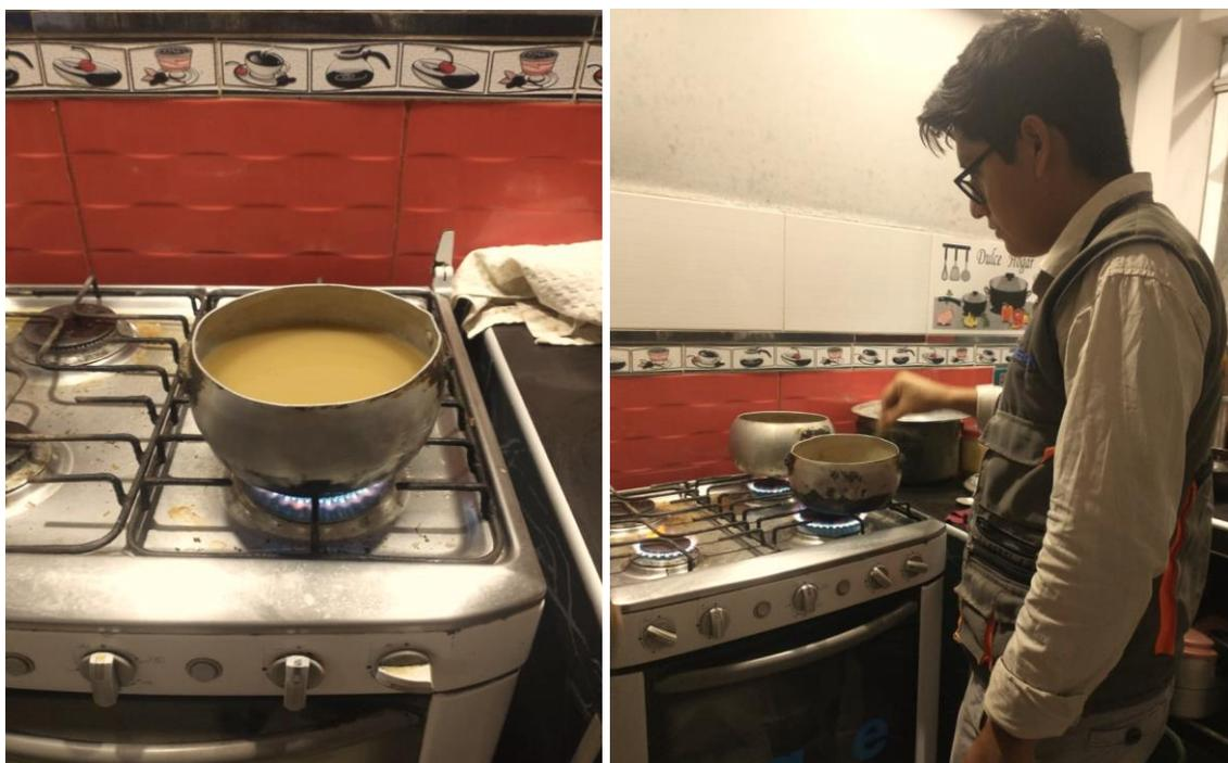
**Figura 55:** Obtención de peso seco de la muestra de agregado fino, mediante cocina
