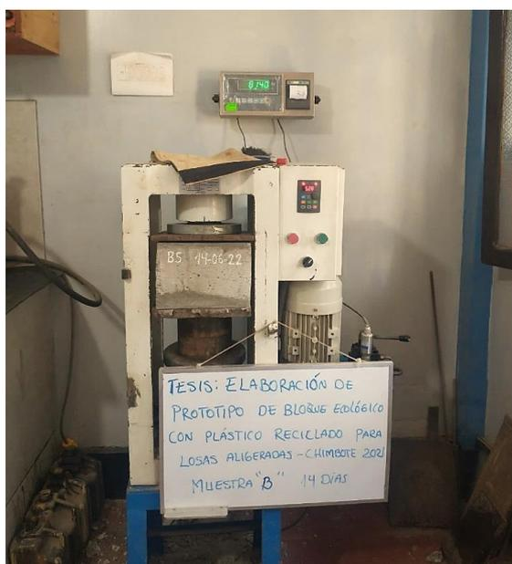
**Figura 45:** Bloque ensayado en máquina de resistencia a la compresión, muestra B
