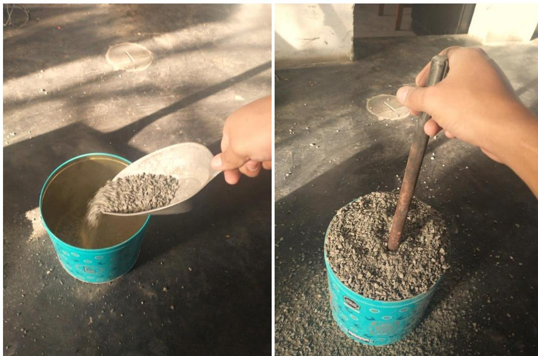
*Figura 59: Ensayos de peso unitario suelto y compactado, agregado grueso.*
