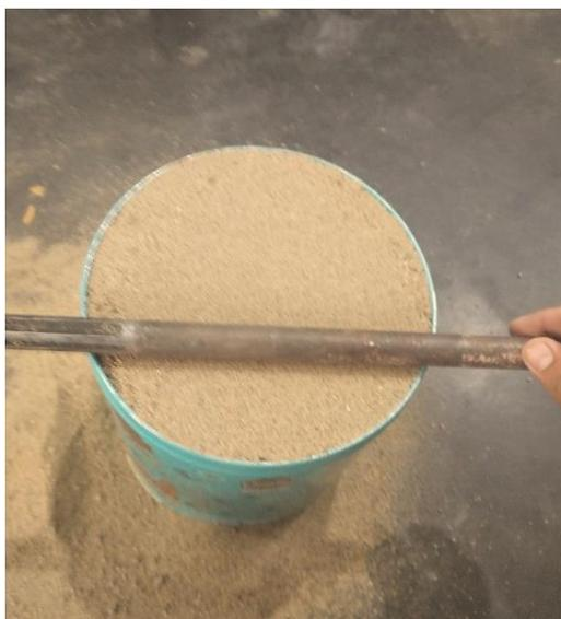
*Figura 31: Ensayo peso unitario suelto - agregado fino*
