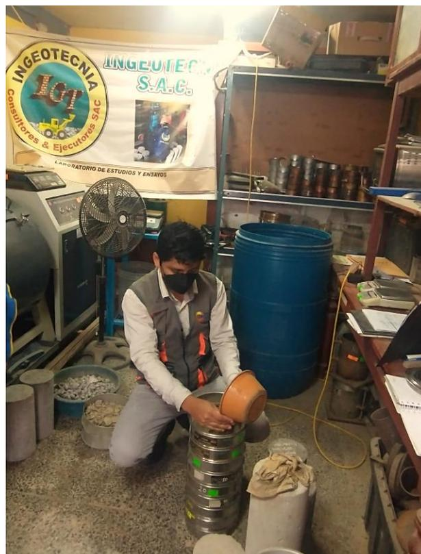
*Figura 53: Análisis granulométrico de los agregados*
