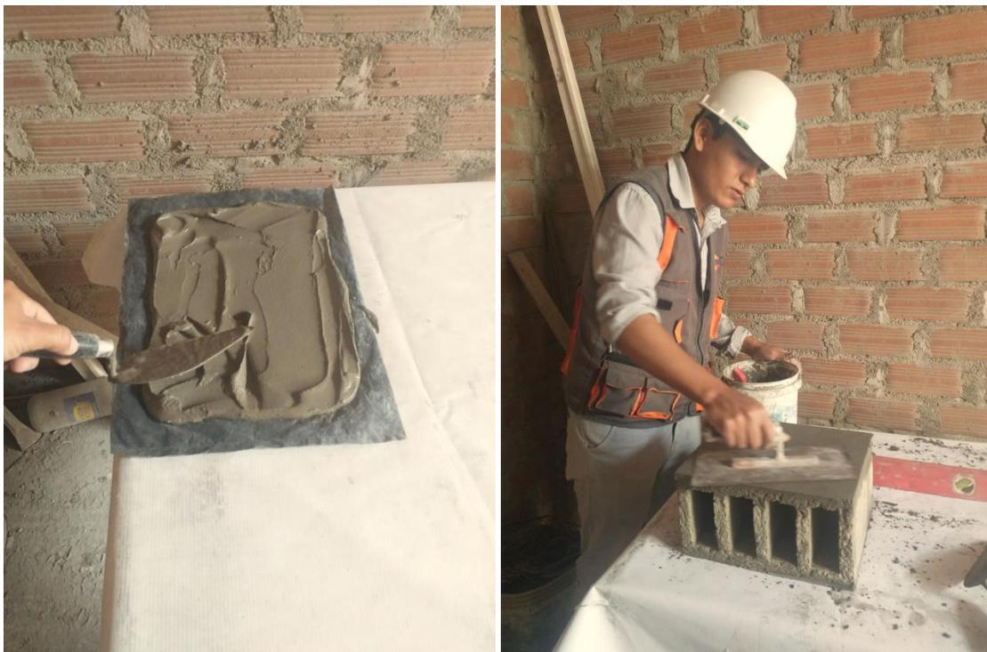
*Figura 73: Refrentado de unidades de albañilería*
