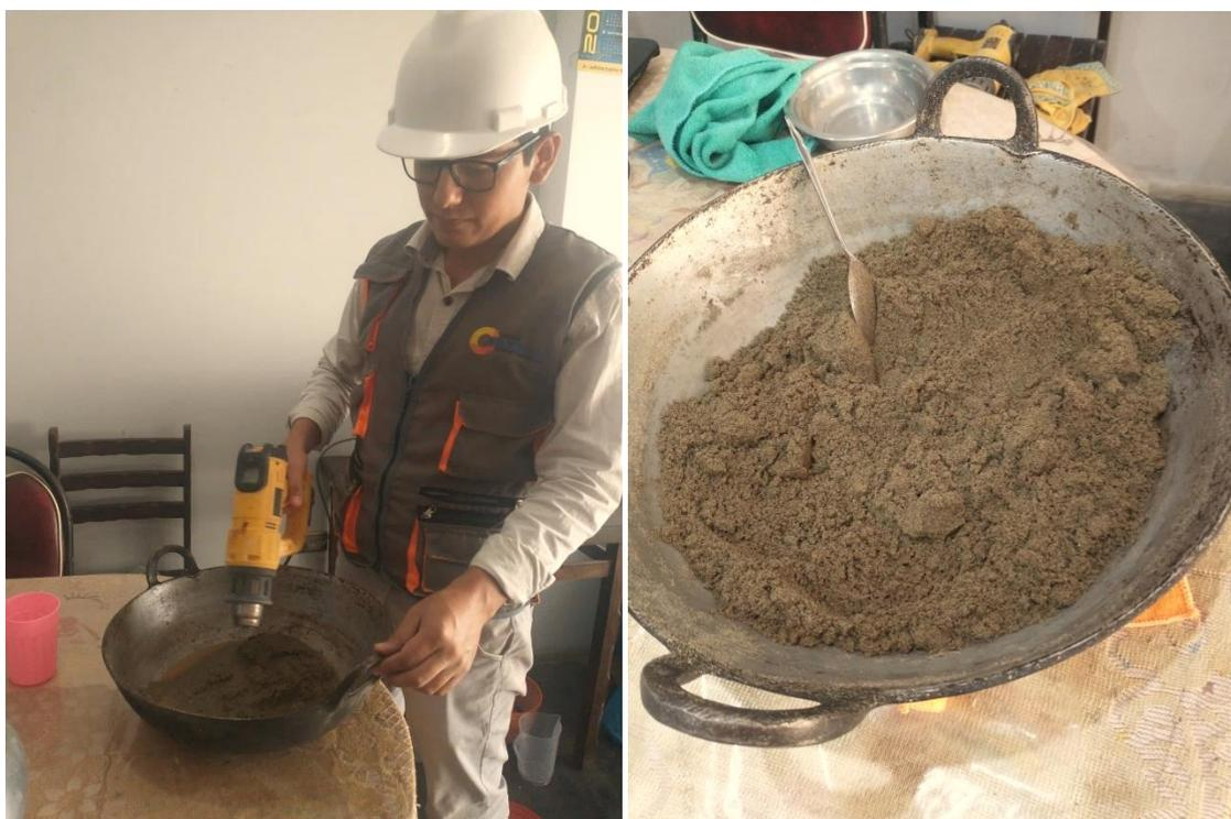
**Figura 57:** Muestra saturada superficialmente seca, para ensayo de absorción del agregado fino.
