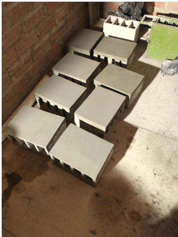
*Figura 74: Unidades de albañilería refrentadas 48 horas antes del ensayo a compresión.*
