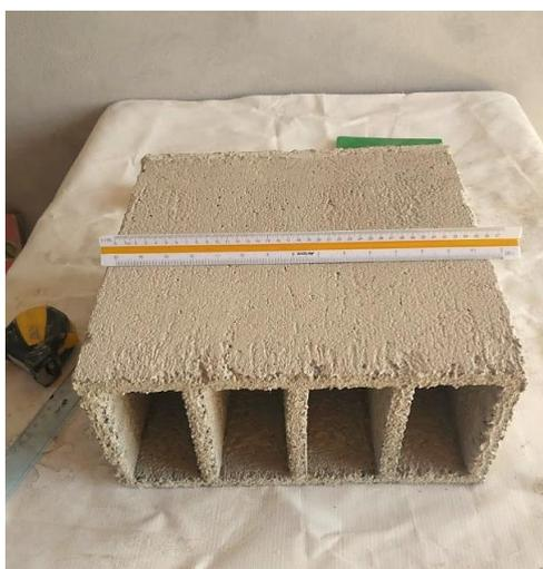
*Figura 35: Ensayo variación dimensional muestra patrón 0% PET*
