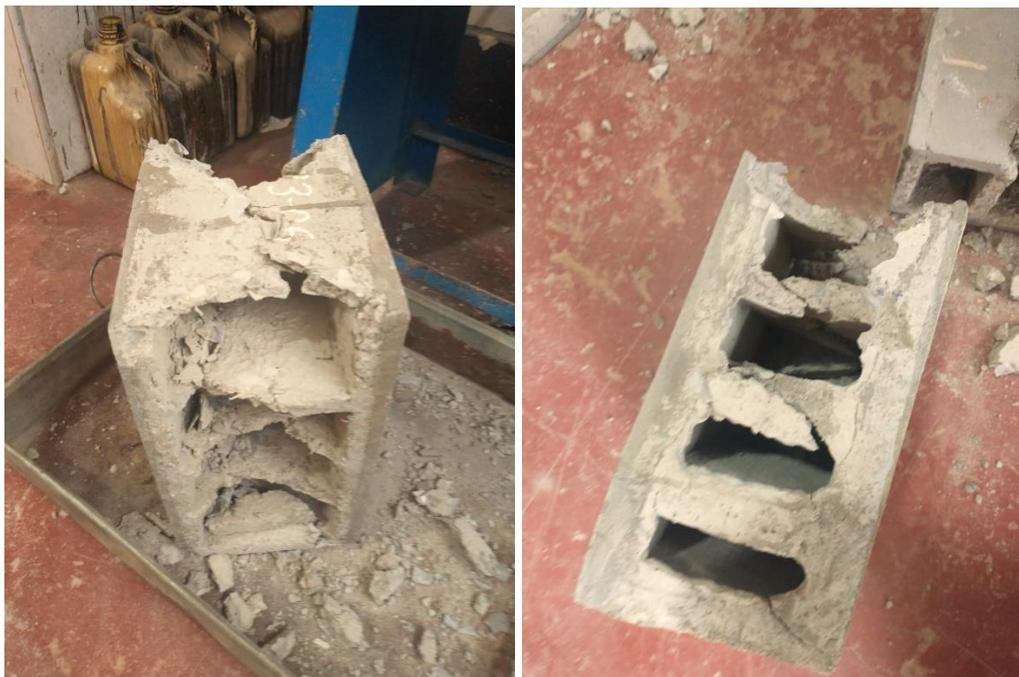
**Figura 76:** Tipos de fallas presentadas en los bloques al alcanzar su máxima resistencia.
