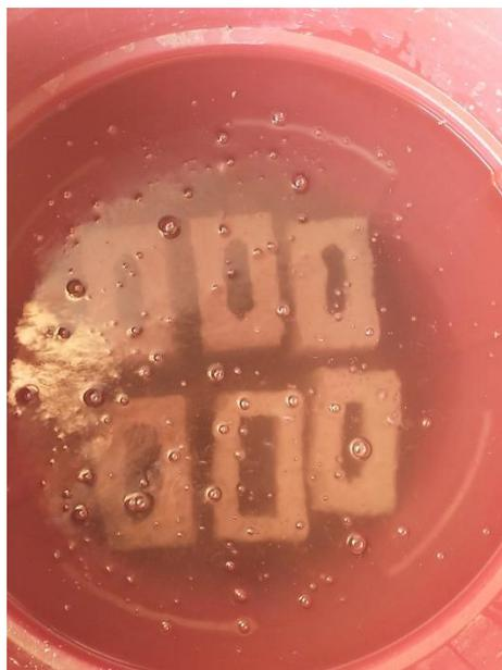
**Figura 39:** Muestras sumergidas por 24 horas, ensayo absorción
