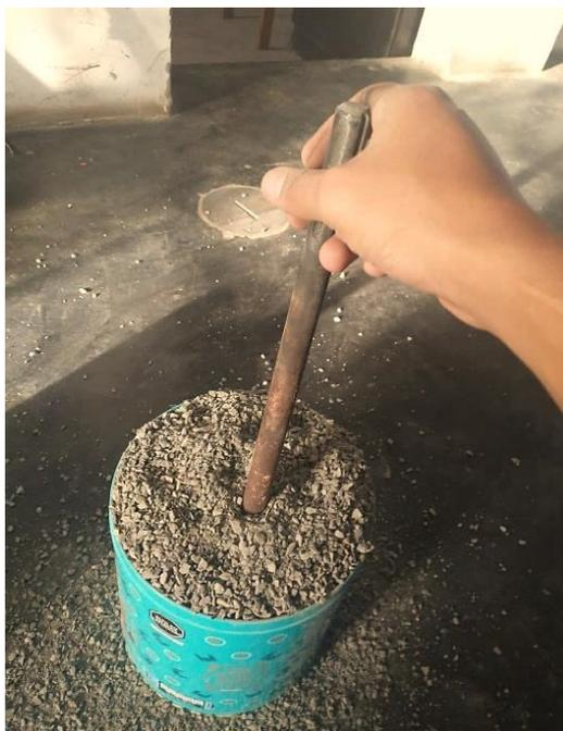
*Figura 34: Ensayo peso unitario compactado - agregado grueso*
