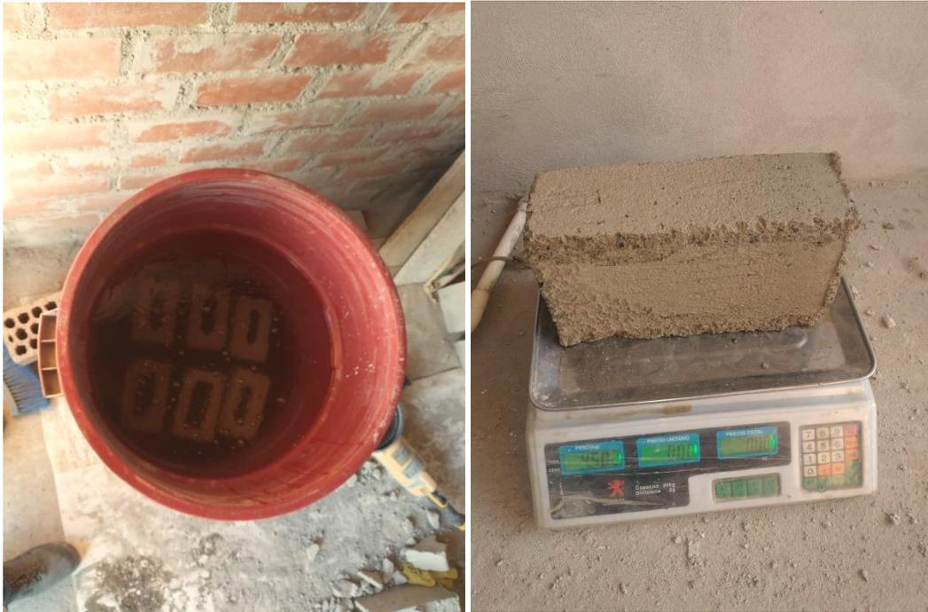
**Figura 70:** Muestras sumergidas durante 24 horas para obtener el peso saturado superficialmente seco.
