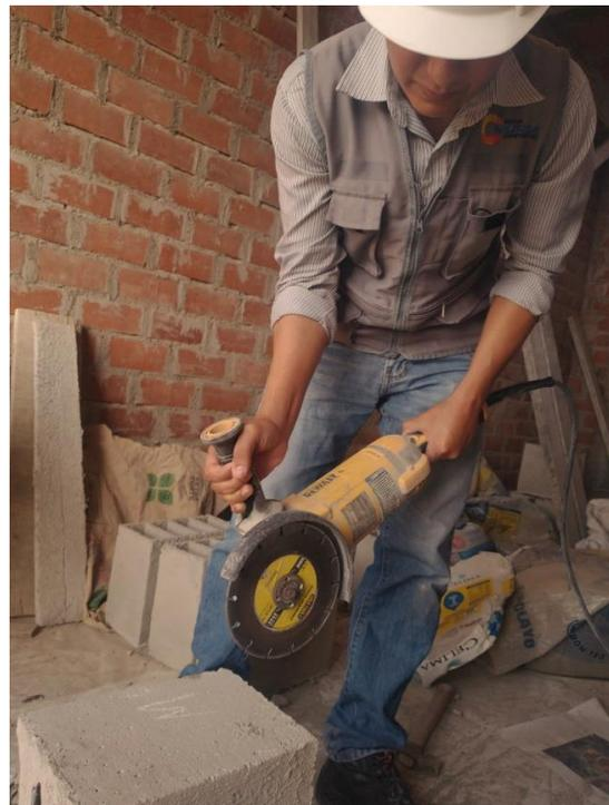
*Figura 69: Corte con disco y amoladora para obtener muestras*
