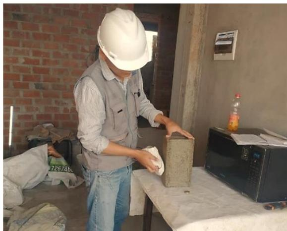
*Figura 40: Secado superficial del espécimen, ensayo de densidad*
