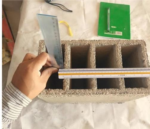
**Figura 37:** Ensayo variación dimensional muestra 30% PET
