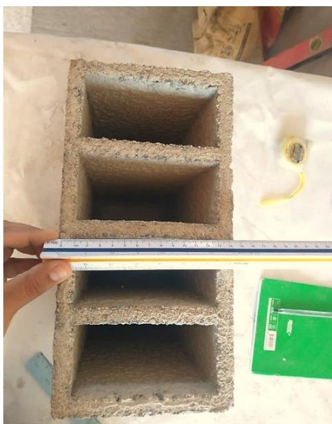
*Figura 36: Ensayo variación dimensional muestra 20% PET*
