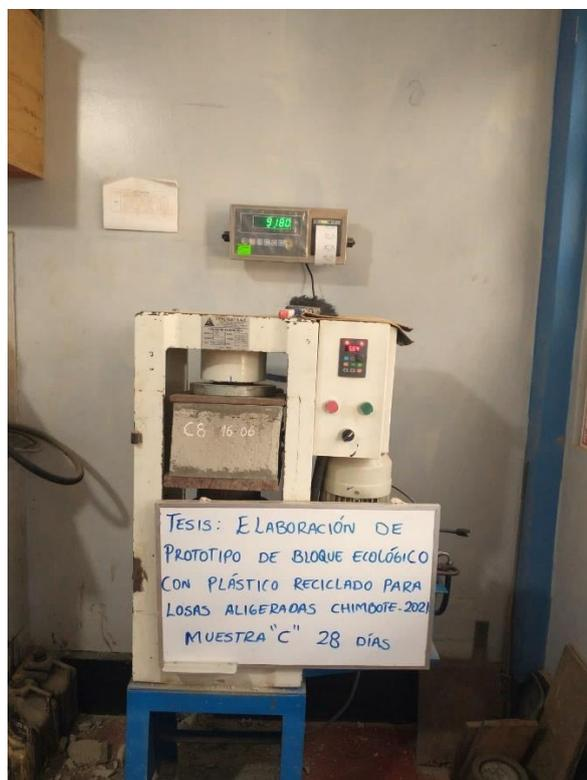
*Figura 75: Maquina para ensayo de resistencia a la compresión*
