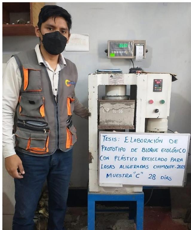
**Figura 47:** Ensayo a la compresión finalizado, máxima resistencia.
