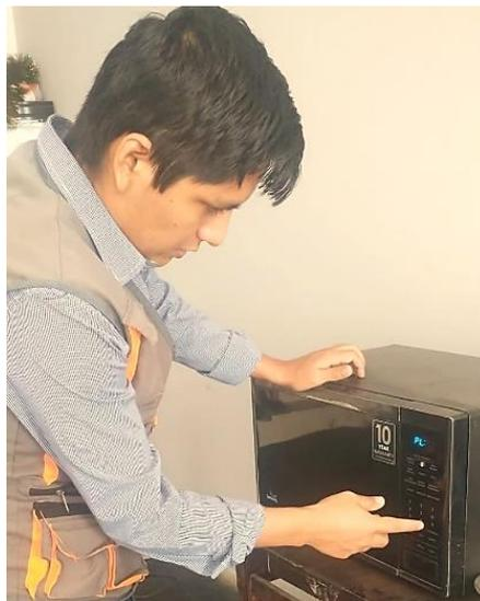
**Figura 30:** Ensayo de contenido de humedad de agregados
