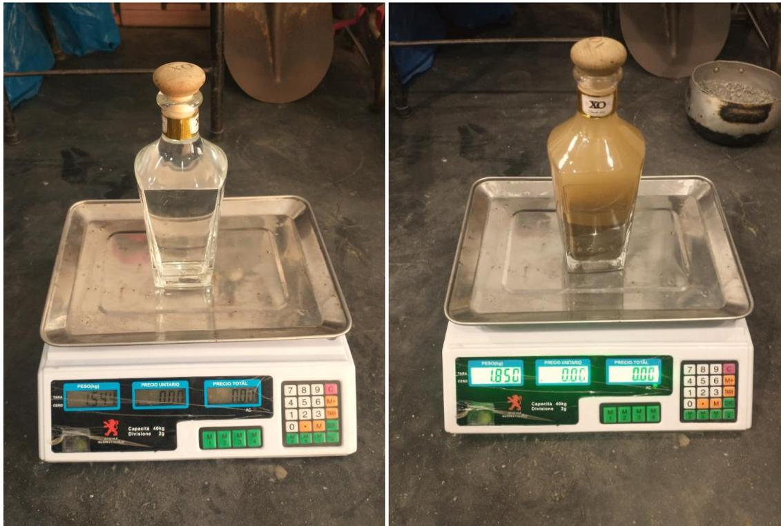
**Figura 54:** Pesos de fiola con agua y agregado saturado, ensayo de peso específico agregado fino.
