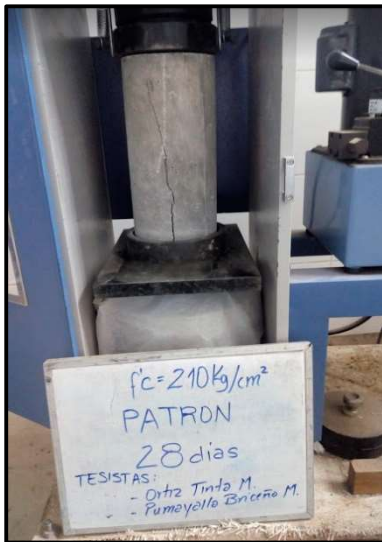
(a) Testigo de concreto patrón, evaluado a los 28 días de curado
