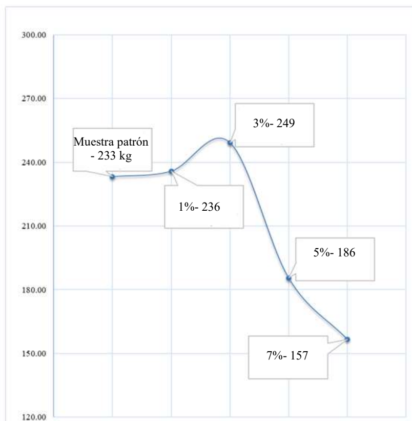
Figura 28. Evaluación de la resistencia a la compresión -28 días.
