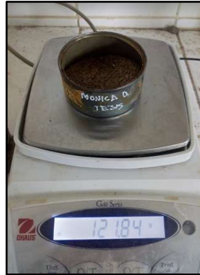
(b) Muestra húmeda del agregado fino
