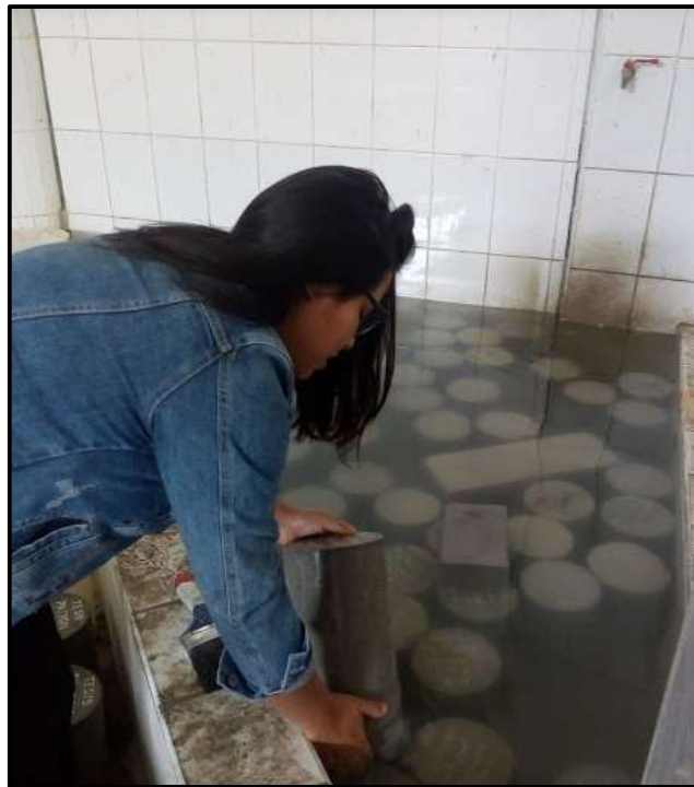
(b) Retiro de testigos de concreto del agua
