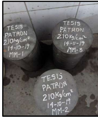
(b) Codificación de testigos de concreto patrón
