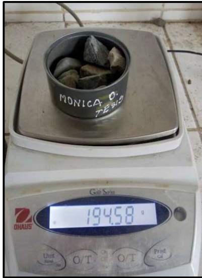
(a) Muestra húmeda del agregado grueso
