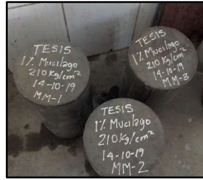
(a) Codificación de testigos con 1% de adición de mucilago de nopal
