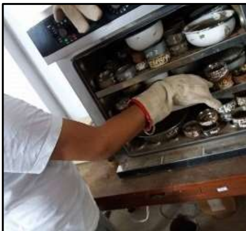
(c) Secado al horno de los agregados
