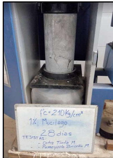
(c) Testigo de concreto con 1% de adición de mucilago de nopal, evaluado a los 28 días de curado
