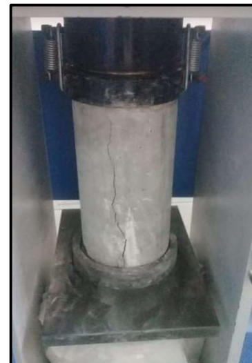
(d) Testigo de concreto con 7% de adición de mucilago de nopal, evaluado a los 14 días de curado
