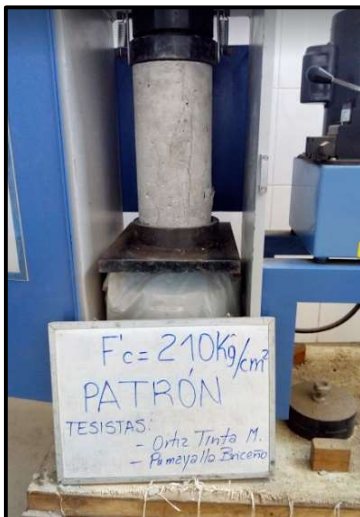
(d) Testigo de concreto patrón, evaluado a los 7 días de curado
