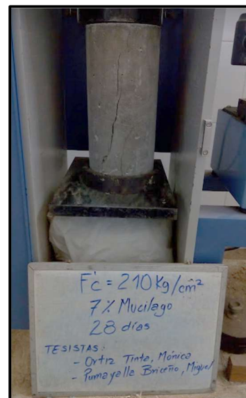
(e) Testigo de concreto con 7% de adición de mucilago de nopal, evaluado a los 28 días de curado
