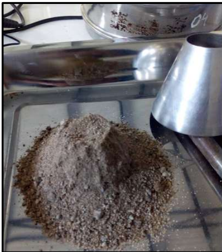
(c) Peso saturado del agregado agregado
