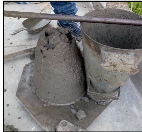
(b) Asentamiento del concreto
