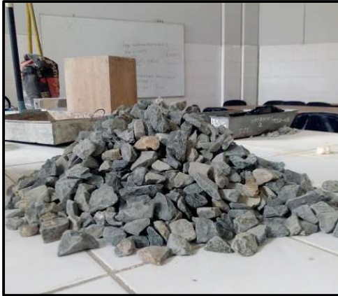
(a) Acopio de agregado grueso
