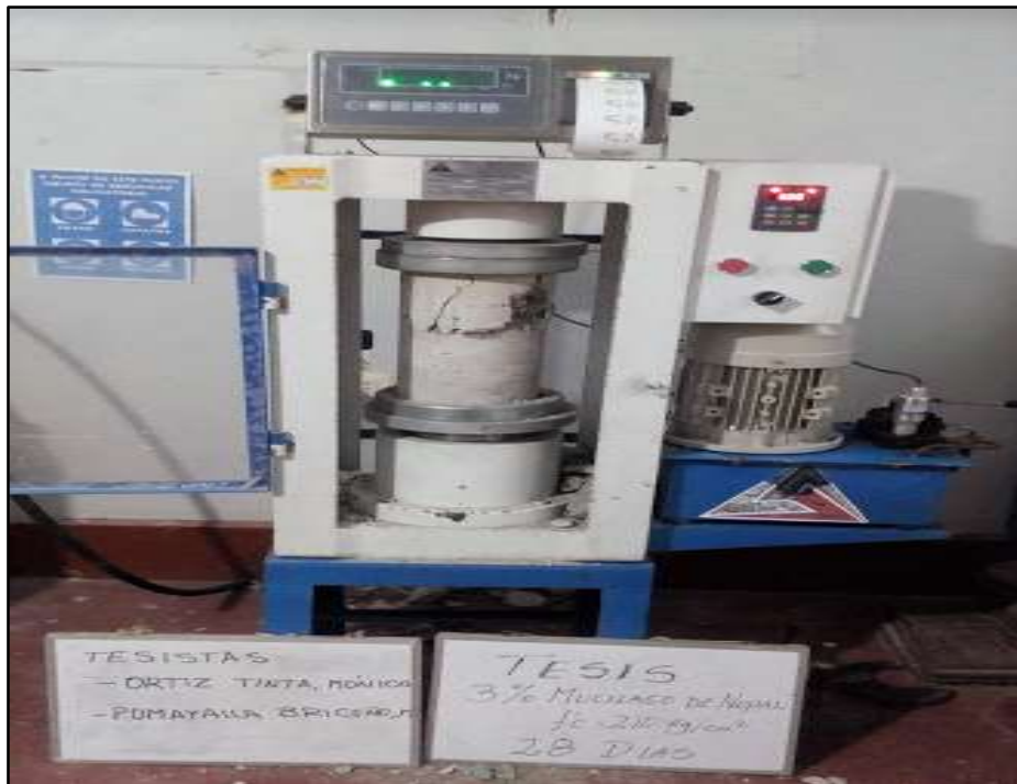
Figura 21. Ensayo de resistencia a la compresión del concreto en el laboratorio de la UNS.
