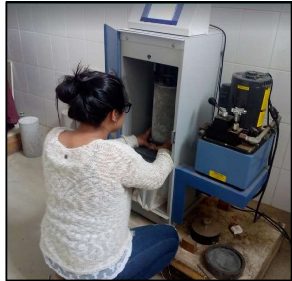
(b) Colocación de los testigos de concreto en la maquina
