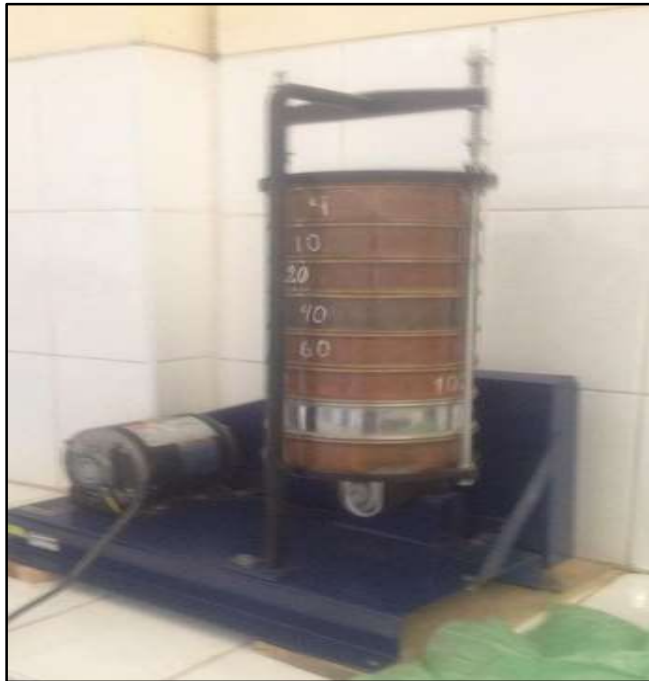
Figura 16. Tamizado mecánico del agregado fino.
