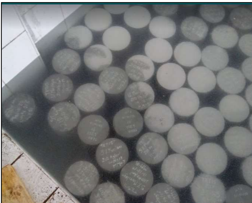
Figura 19. Curado del concreto en el laboratorio de la UNS.
