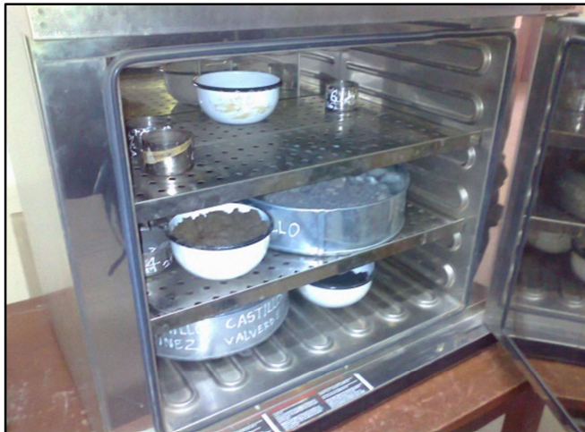
Figura 17. Ensayo de contenido de humedad.
