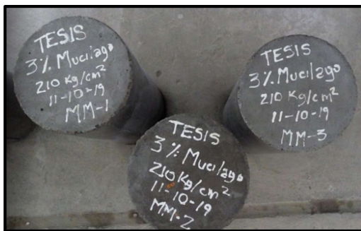
(d) Codificación de testigos con 3% de adición de mucilago de nopal
