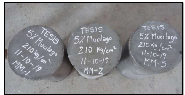
(c) Codificación de testigos con 5% de adición de mucilago de nopal
