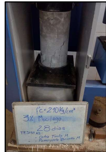
(b) Testigo de concreto con 3% de adición de mucilago de nopal, evaluado a los 28 días de curado
