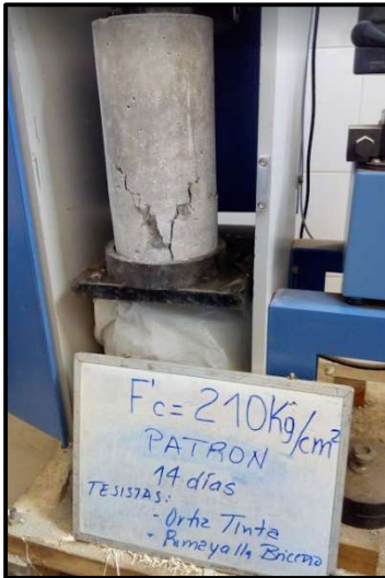
(a) Testigo de concreto patrón, evaluado a los 14 días de curado
