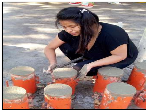
Figura 4. Obtención de muestras de concreto
