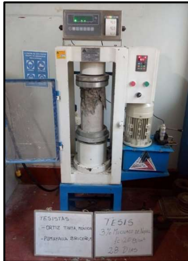
(a) Tipo de fractura: Tipo 2, fisuras verticales a través de los cabezales, como no bien definido en el otro extremo.
