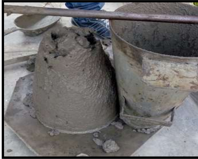
Figura 6. Asentamiento del concreto.
