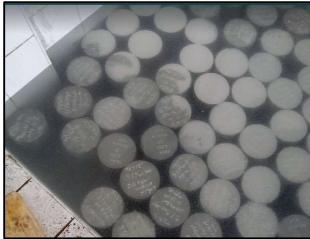
(a) Testigos de concreto curando
