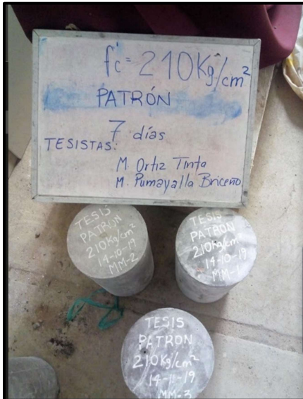
(a) Testigos de concretos listos para ser sometidos a compresión
