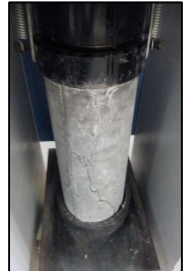
(b) Testigo de concreto con 3% de adición de mucilago de nopal, evaluado a los 14 días de curado
