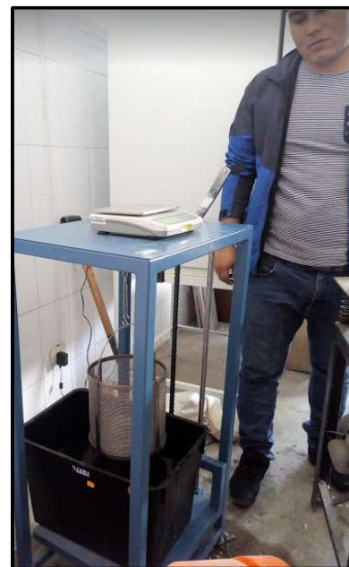
(d) Peso suspendido del agregado
