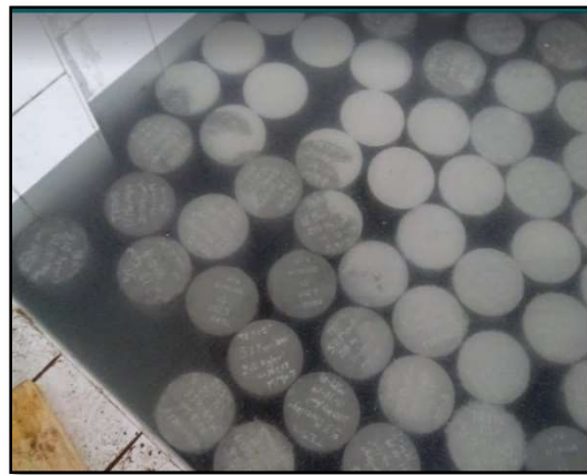
Figura 5. Curado de muestras de concreto.
