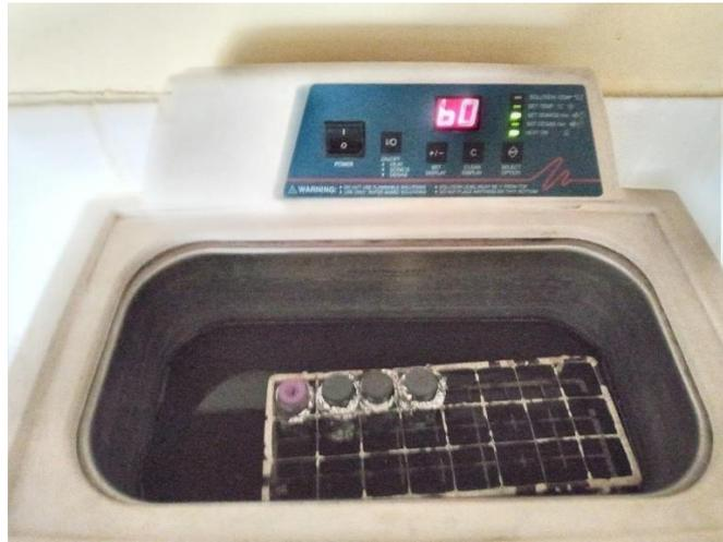
*Figura 32. Sonificando las muestras en el Ultrasonido*
