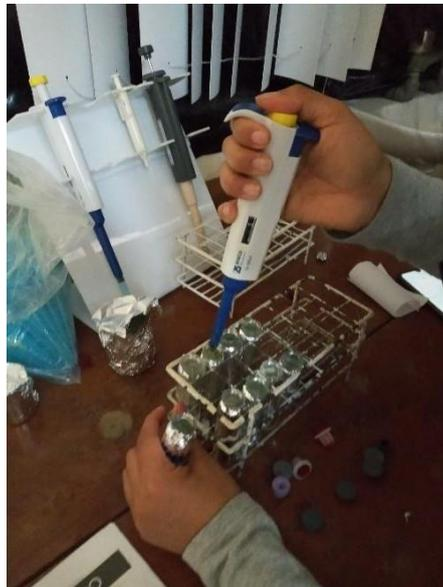
*Figura 30. Preparación de la curva patrón*
