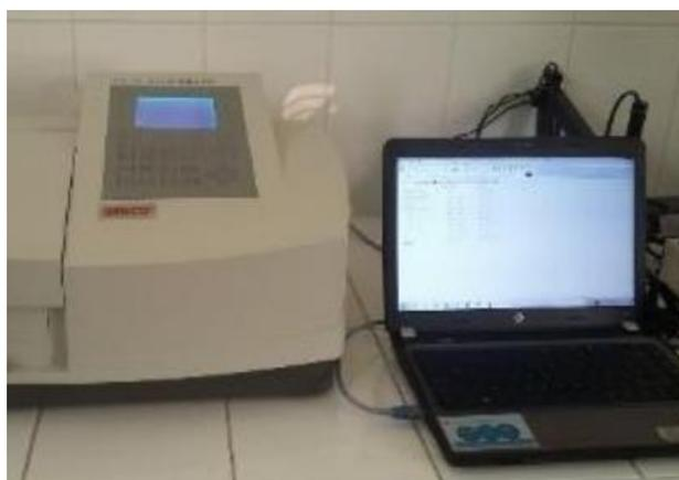
*Figura 24. Lectura de absorbancia en espectrofotómetro*
