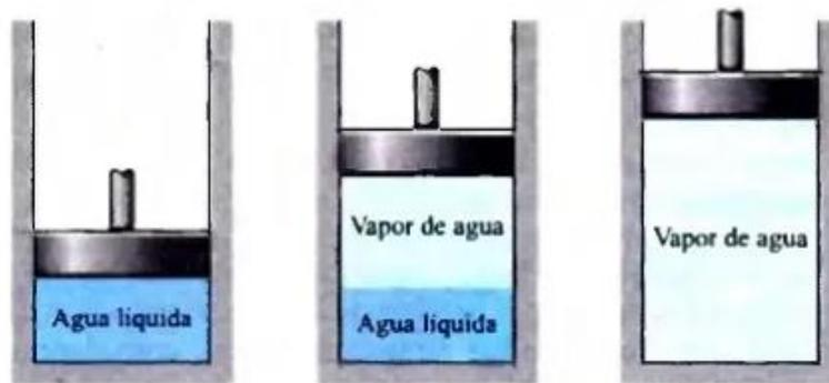
Figura 2. Variación de estado líquido - vapor a presión constante, para el agua.
