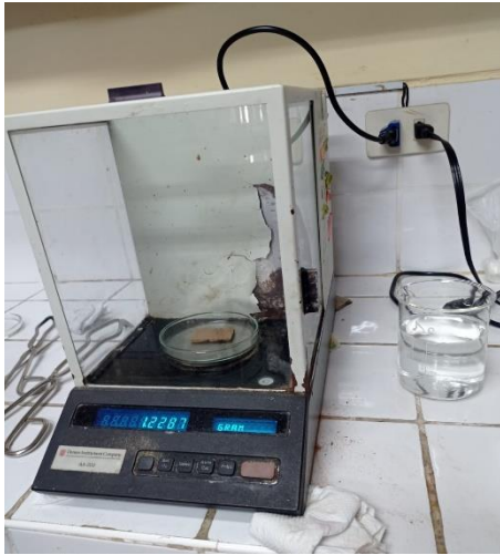
Anexo 94. Pesado de muestra después de la absorción de agua
