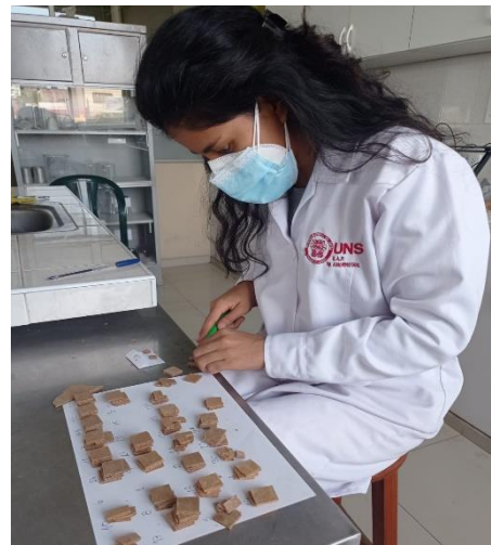
Anexo 89. Corte de muestras de cada tratamiento para medición de densidad.
