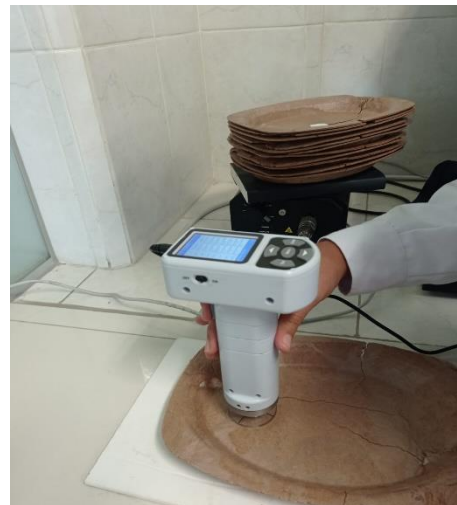
Anexo 85. Medición del color de las bandejas biodegradables
