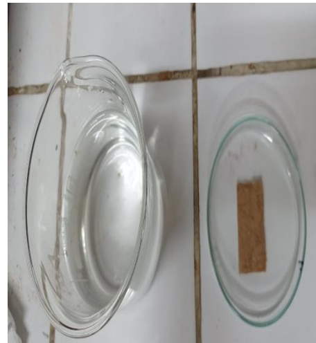
Anexo 93. Retirado de exceso de agua absorbido
