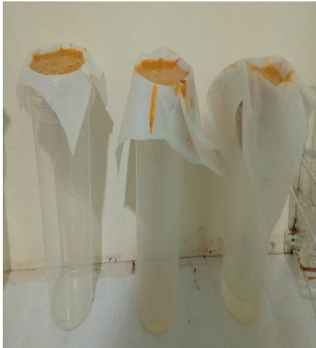
Anexo 78. Filtración de agua en el almidón de semilla de palta.
