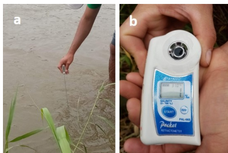
Figura 6. Medición de temperatura a), y salinidad b) del agua del río Lacramarca.
