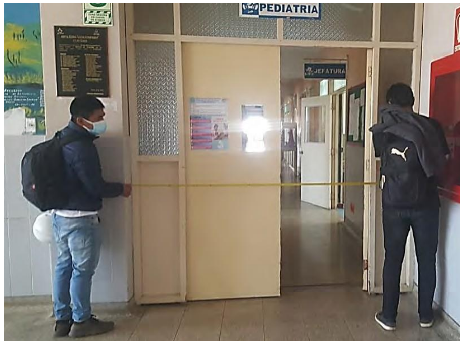
Fotografía A-21. Medición de ancho de pasillo entre los ejes B y C de la estructura principal del Hospital Regional Eleazar Guzmán Barrón.
