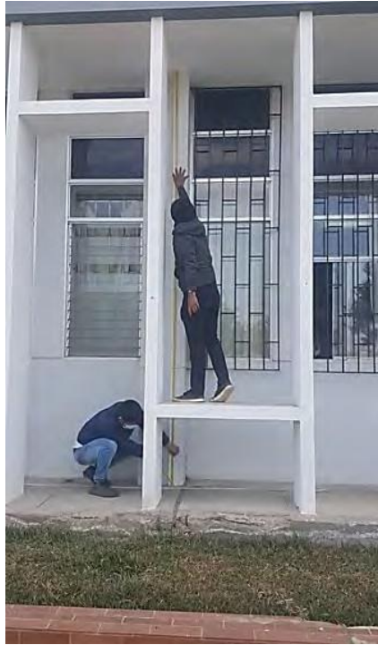
Fotografía A-5. Toma de medición de altura del primer piso de la estructura principal del Hospital Regional Eleazar Guzmán Barrón.
