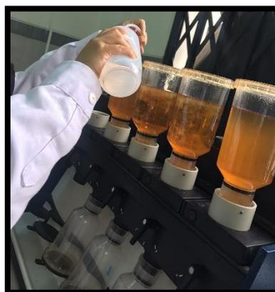
**Figura 52** Se coloca el crisol con el celite húmedo en el envase con la muestra y se monta en el equipo para que separe el sobrenadante del líquido.
