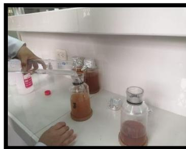
**Figura 51.** Se agrega 280ml alcohol de 96° a 60°C en cada muestra y se deja reposar por 1 hora.
