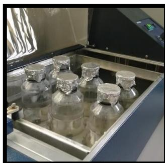
**Figura 49.** Se tapan los recipientes y se colocan en el shaker a baño maría según la temperatura y tiempo requerido.
