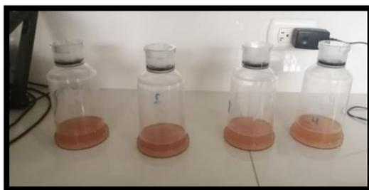
**Figura 48.** Muestra con 50ml de buffer fosfato a 6 pH.
