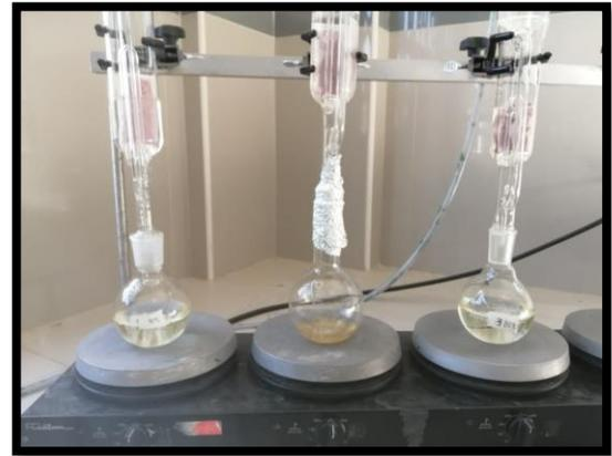
**Figura 57.** Montado en el equipo Soxhlet, y con 200ml de solvente Metanol.
