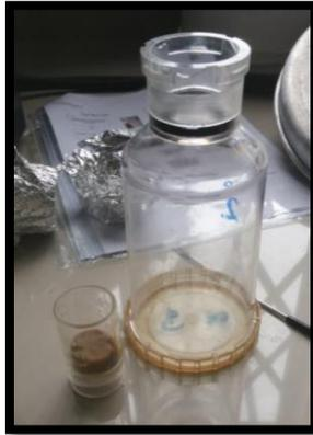
**Figura 53.** Se deja filtrar todo el líquido y queda solo la fibra, luego se retira y se pone a secar.
