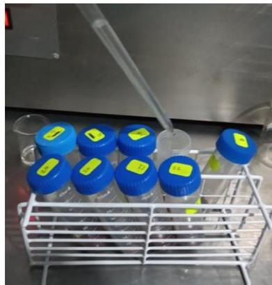
Figura 39. Agregado de Alcohol a diferentes volúmenes en cada tubo con Nibs de cacao en polvo
