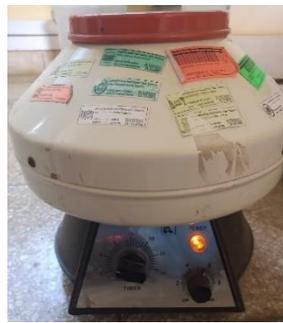
Figura 42. Centrifugado de Tubos para separación de fase líquida
