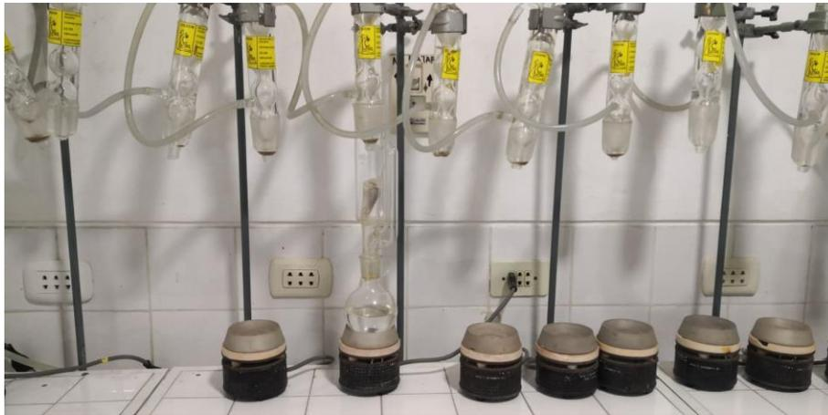
Figura 30. Equipo soxhlet, en la determinación de grasa.
