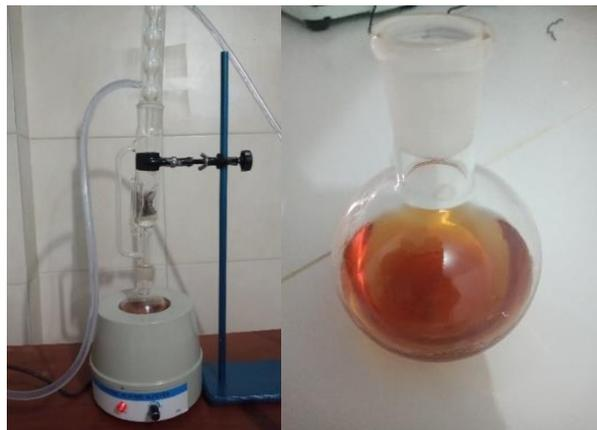
Figura 45. Extracción de manteca de cacao con Soxhlet utilizando etanol como solvente
