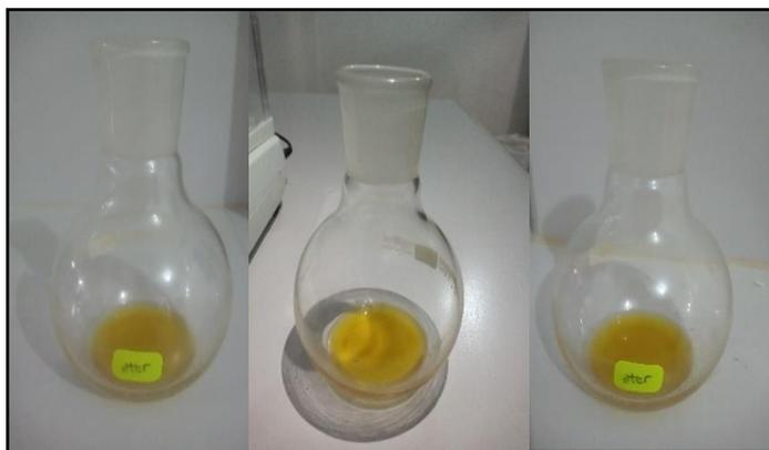
Figura 47. Manteca de cacao extraída con soxhlet utilizando éter como solvente
