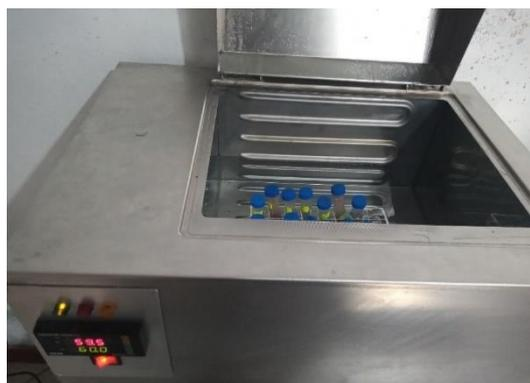
Figura 40. Colocado de Tubos en baño maría a diferentes temperaturas y tiempos
