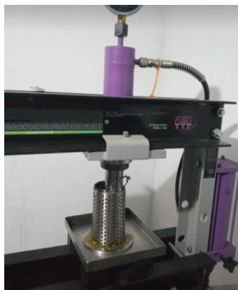
Figura 36. Prensado de Nibs de cacao en Prensa Hidráulica a 8, 10, 12 y 15 US-TONS
