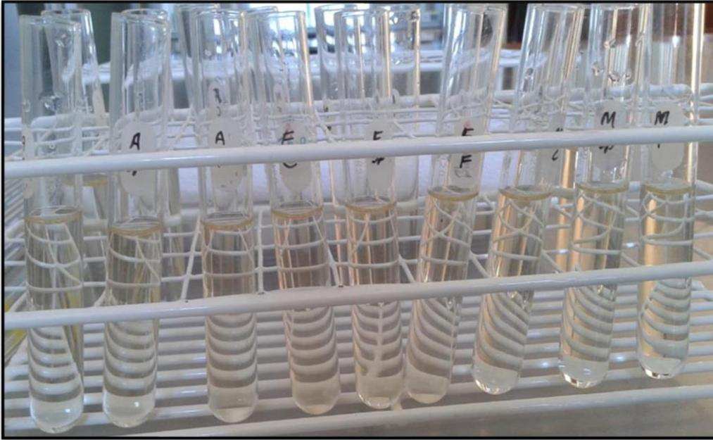
Figura 21. Análisis del sobrenadante. Para una adecuada lectura de las muestras se realizó una dilución de 1/10 por cada muestra.
