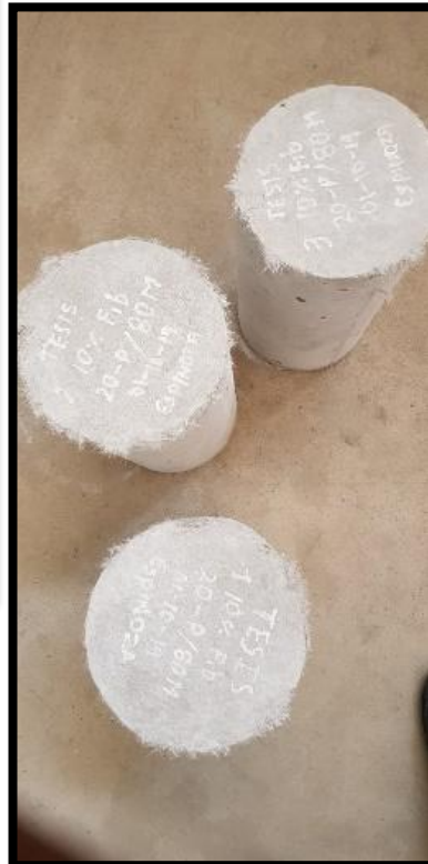
Ruptura de testigos de concreto a los 7, 14 y 28 días.
