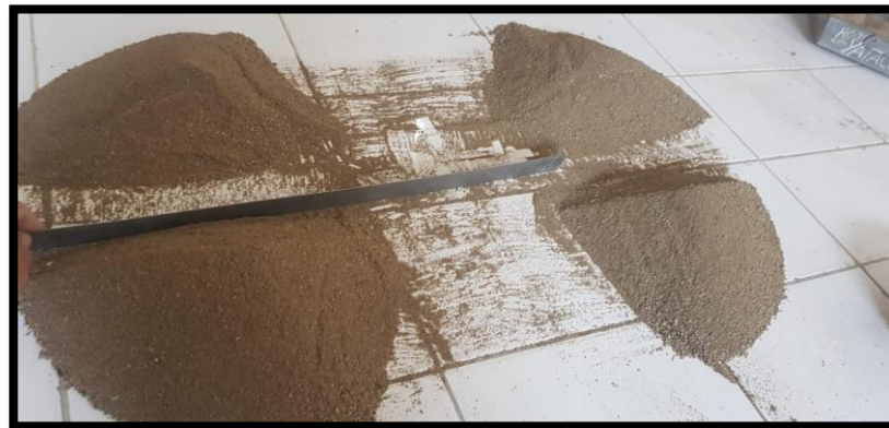
Ilustración 9.- Cuarteo de agregado Grueso. Fuente: Elaboración Propia.
