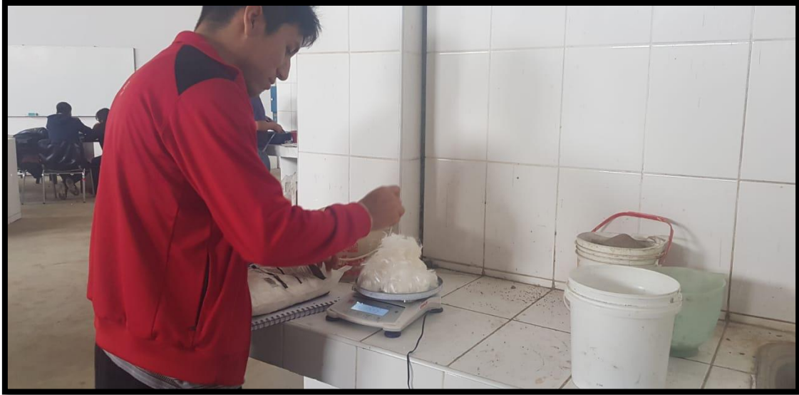
Cuantificación de materiales para elaboración de concreto
