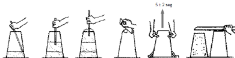
Ilustración 12. -Procedimiento para el asentamiento del concreto.
