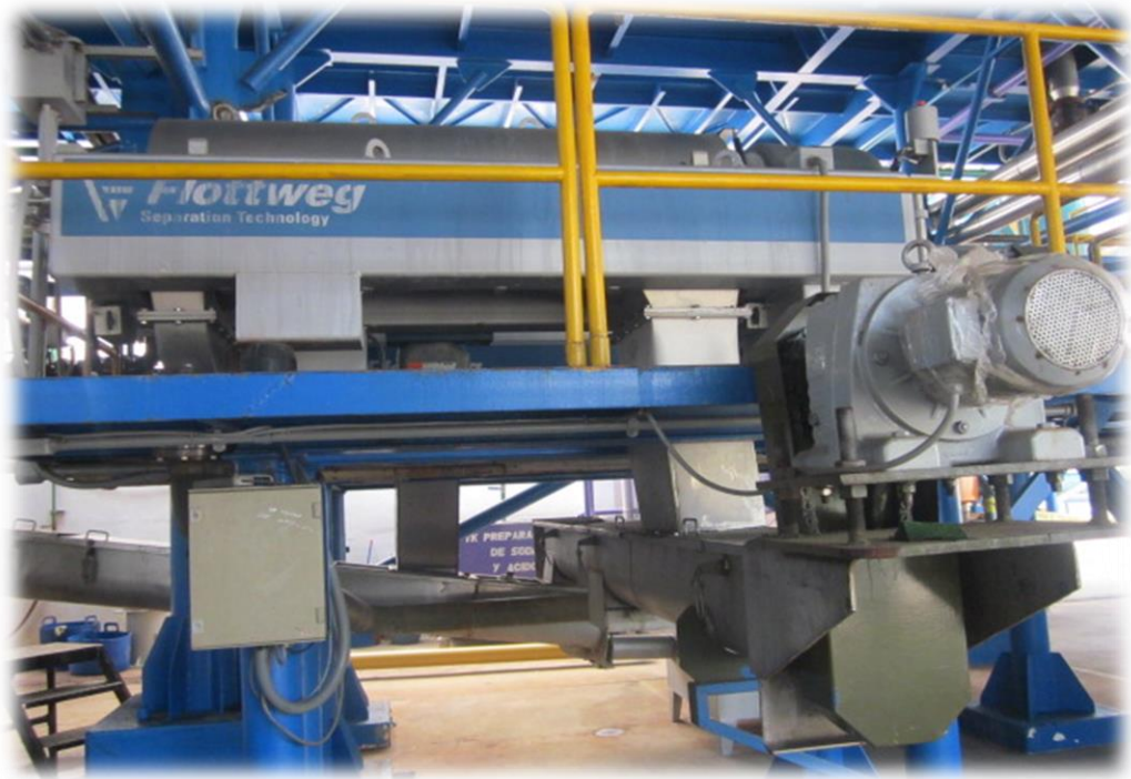
Gráfico 8. Separadoras ambientales, marca FLOTTWEG 80 m 3 y 30 m 3
