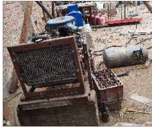
Pozo B1: Extracción de agua subterránea para fines de riego a 15 l/s, con una bomba sumergible; motor mecánico con funcionamiento a Gas.
