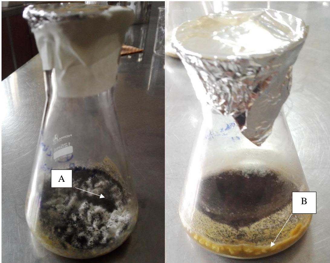
Figura 29. Frasco Erlenmeyer con medio de fermentación sólido utilizados en la producción del complejo enzimático. A. Esporas de Aspergillus niger ATCC 9642. B. Cáscara de mango tratada utilizado en el proceso de fermentación.
