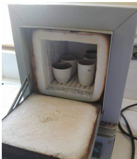
Figura 19. Incineración de las muestras de cáscara de mango en mufla a 550 °C para el análisis de ceniza
