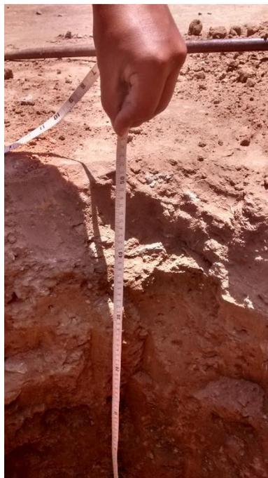
Foto 06.- Medición de Profundidad de Calicata
