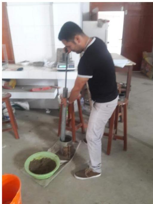
Foto 14.- Ensayo Proctor Modificado.
