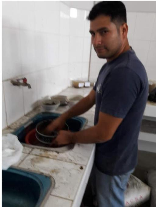
Foto 09.- análisis granulométrico por lavado.
