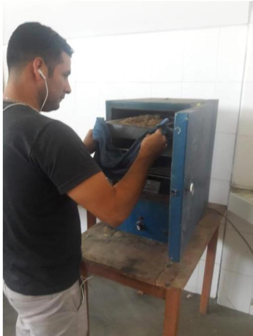
Foto 11 .- Secado de muestras en horno eléctrico.
