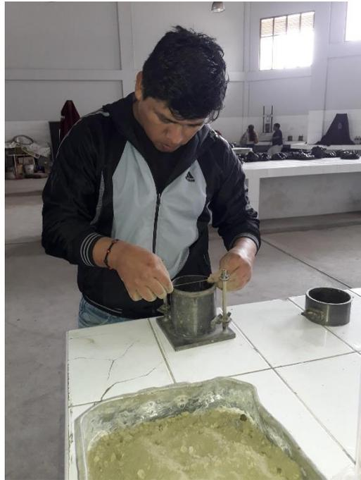
Foto 13.- Molde para Ensayo Proctor Modificado.
