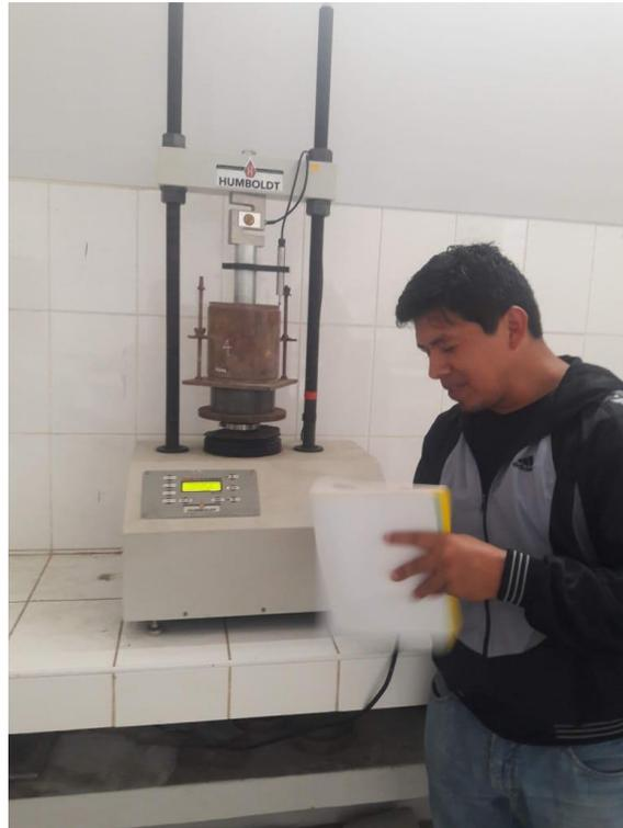
Foto 07.- Ensayo CBR, de terreno de Fundación.
