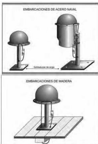
Figura 17. Instalación del precinto de seguridad según el tipo de E/P.
