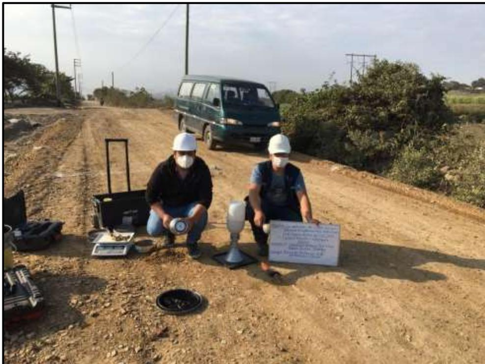
**Fotografía 22. Ensayo de Densidad de Campo en Tramo de Prueba**
