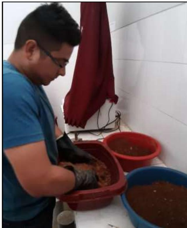
**Fotografía 10. Mezclado de afirmado con residuo de lubricante vehicular**
