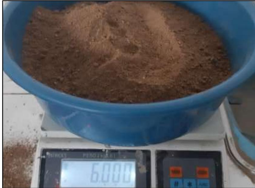
Foto 16: *Pesado de la muestra para ensayo Proctor.*
