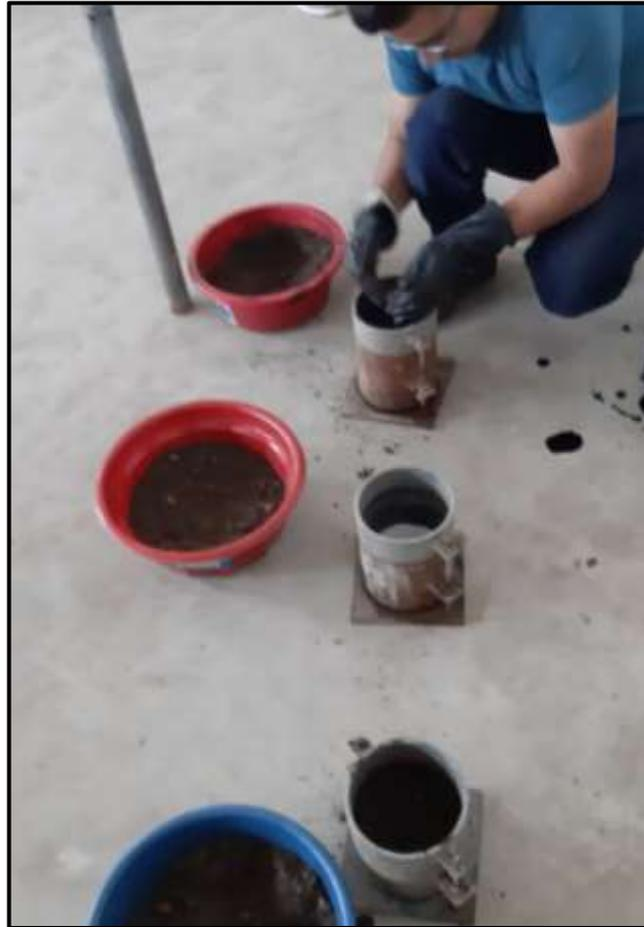
**Fotografía 13. Ensayo de CBR con afirmado más aditivo**
