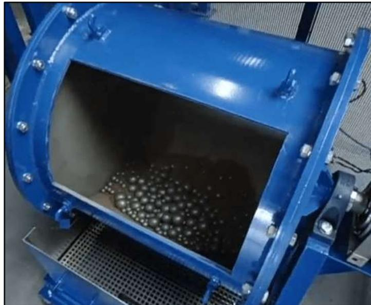
Foto 10: *Ensayo de abrasión de los ángeles.*
