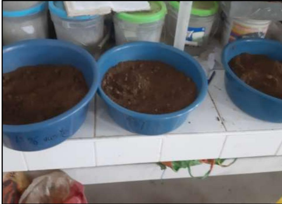
**Fotografía 11. Adición de aditivo en diferentes dosificaciones**
