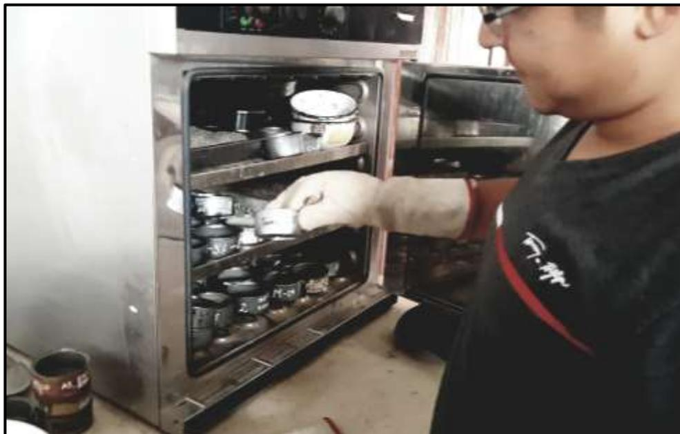
**Fotografía 6. Secado de muestras al horno**
