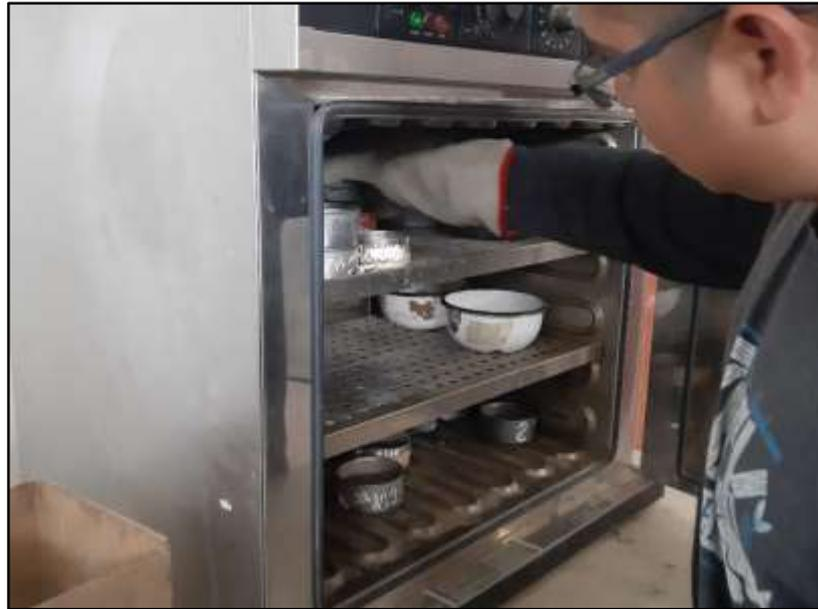
Foto 6: Colocado de muestras en el Horno Eléctrico.
