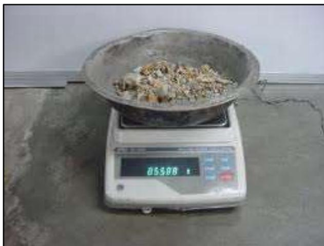
Foto 9: *Ensayo de determinación del peso específico y absorción.*
