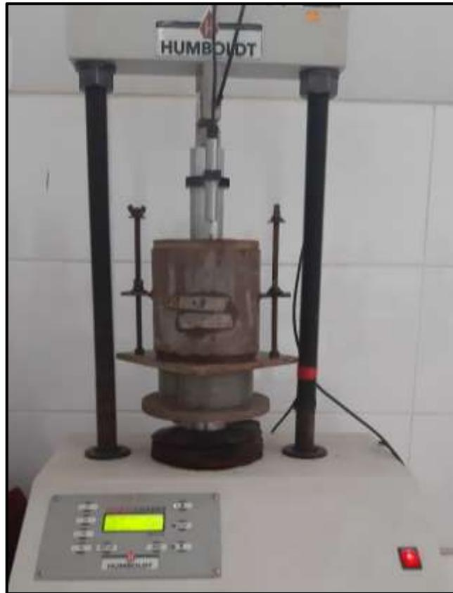
**Fotografía 19. Ensayo de penetración CBR**
