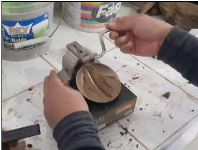
Foto 7: *Ensayo para obtener el Límite Líquido.*
