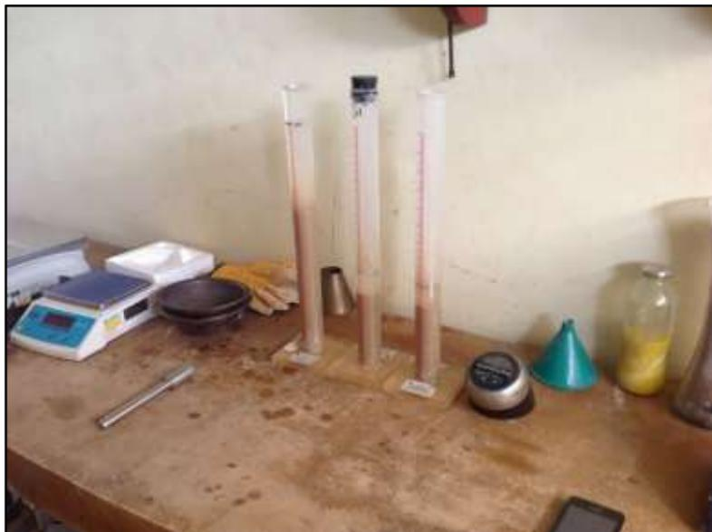
Foto 11: *Ensayo de equivalente de arena.*
