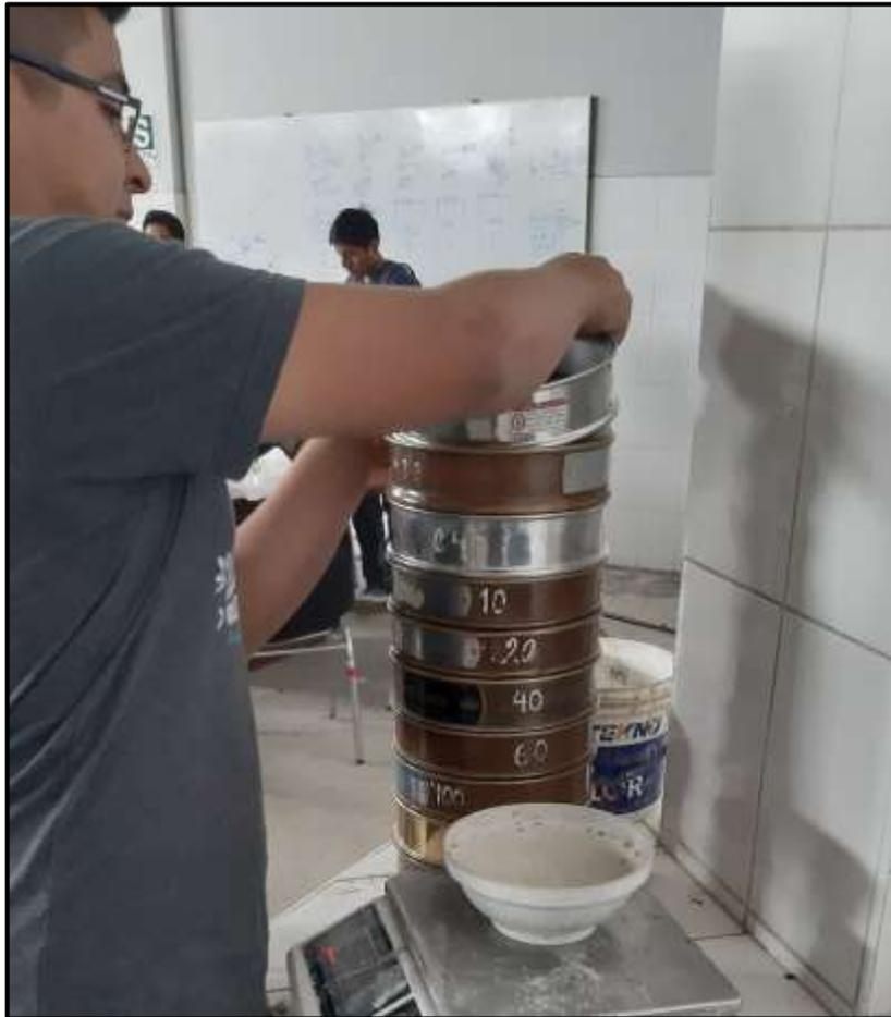
**Fotografía 3. Ensayo de granulometría**
