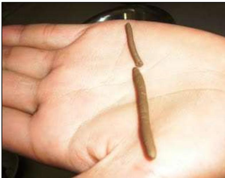
Foto 8: *Ensayo para obtener el Límite Plástico.*
