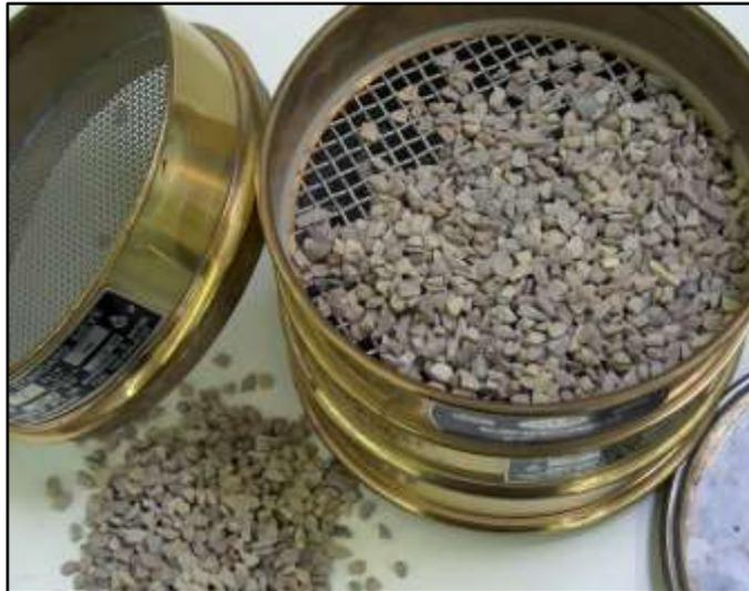
Foto 13: *Ensayo de partículas chatas y alargadas.*
