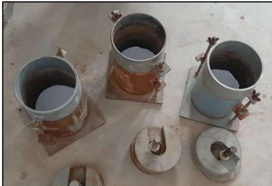
**Fotografía 12. Preparación de moldes para ensayo CBR**
