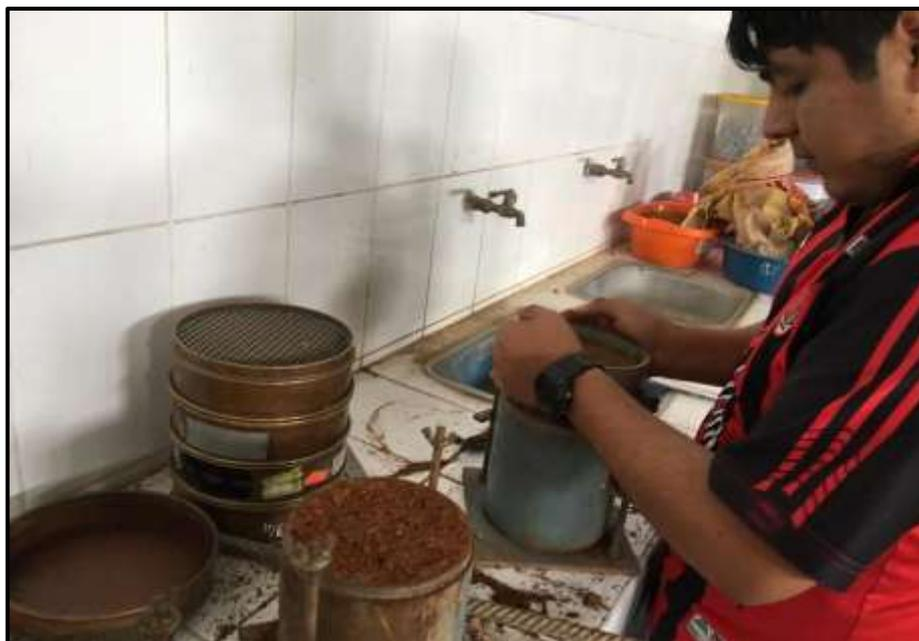
**Fotografía 14. Retirado del collar de extensión para posterior enrasado**
