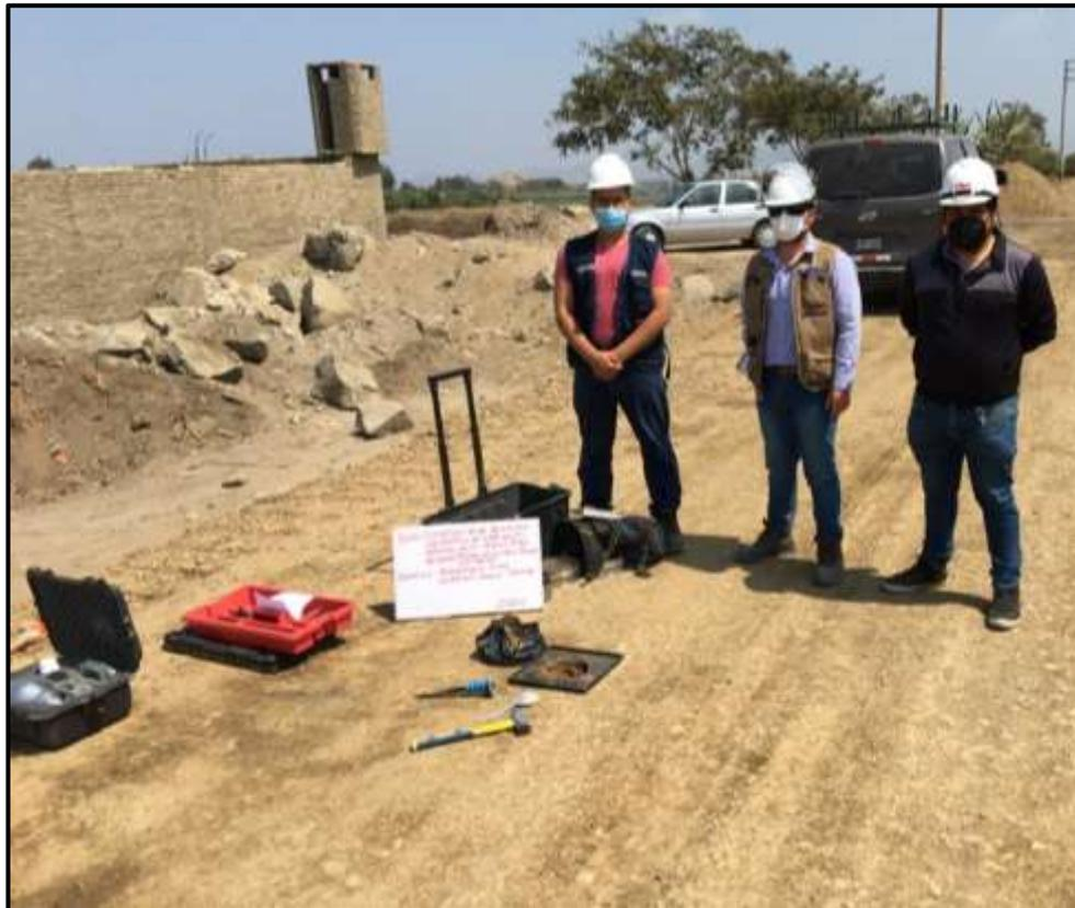
**Fotografía 27. Ensayo de Densidad de Campo Después de 15 días en presencia del Ingeniero Breyner Izaguirre Caballero, Ingeniero residente a cargo de la obra en ejecución.**
