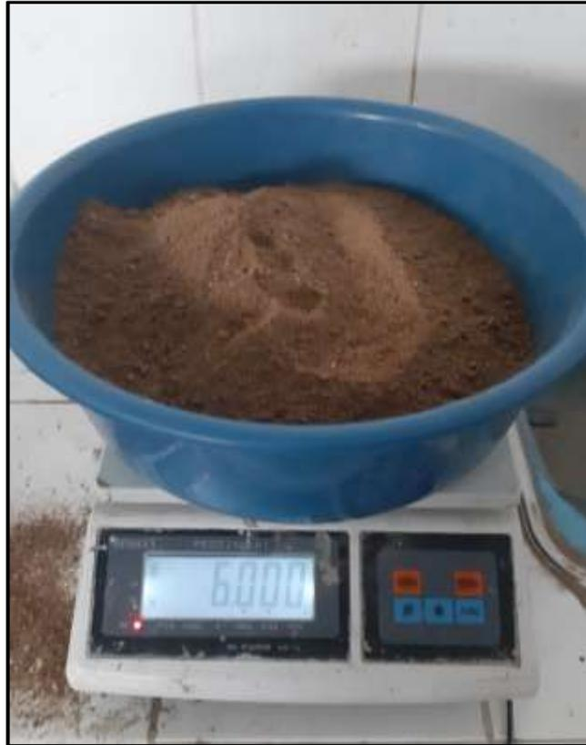
**Fotografía 7. Pesado de muestra para ensayo Proctor Modificado**
