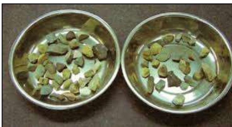
Foto 12: *Ensayo de caras fracturadas.*
