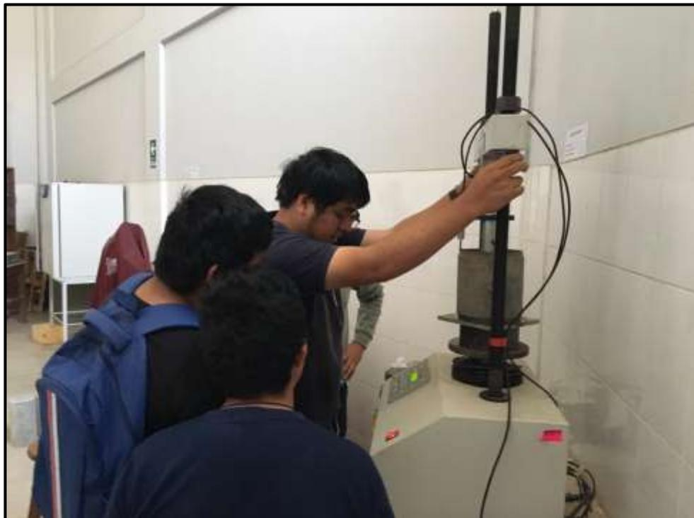
**Fotografía 18. Preparación de la muestra para el ensayo CBR**
