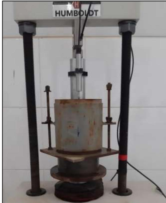
Foto 17: *Ensayo de penetración.*
