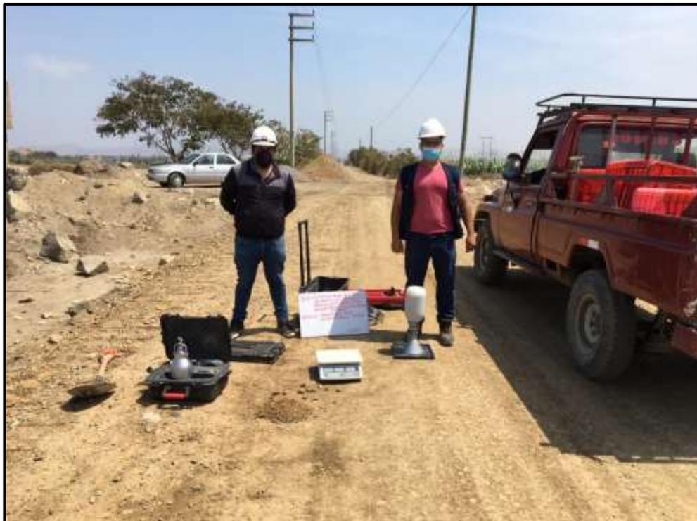
**Fotografía 26. Ensayo de Densidad de Campo Después de 15 días**
