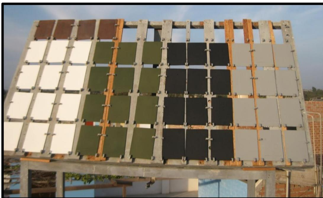
**Figura 9.** Bastidor de madera con las muestras en forma de placas con recubrimiento de pintura y sin recubrimiento.
