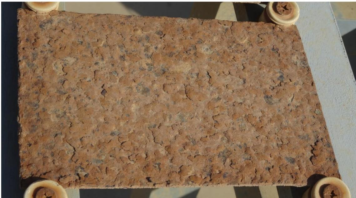
**Figura 12.** Placa de acero ASTM A 36, de 100x50x1.2 mm, expuesta a la atmósfera costera–urbana de la ciudad de Talara, a 280 m de la orilla del mar, durante cuatro años.
