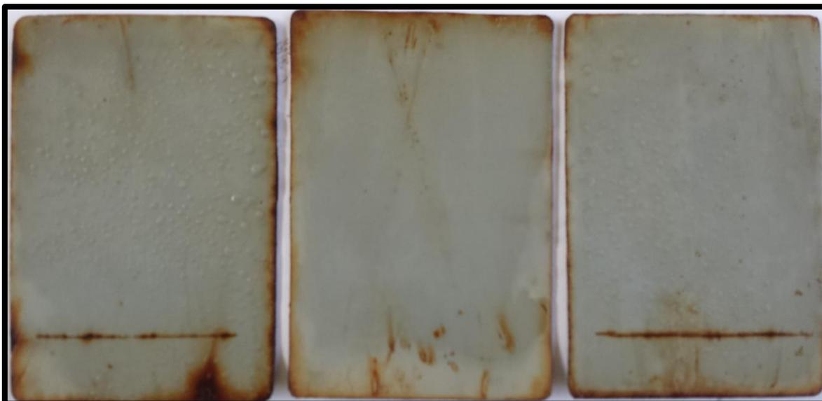
**Figura 22.** Placas de acero ASTM A 131-01 grado A pintadas con pintura acrílica base agua (Amercoat 220) al cabo de dos años de exposición en atmósfera marina en el puerto de Chimbote. Se aprecia la formación de ampollas en algunas zonas y la formación de óxido en las incisiones y en los bordes de la placa.
