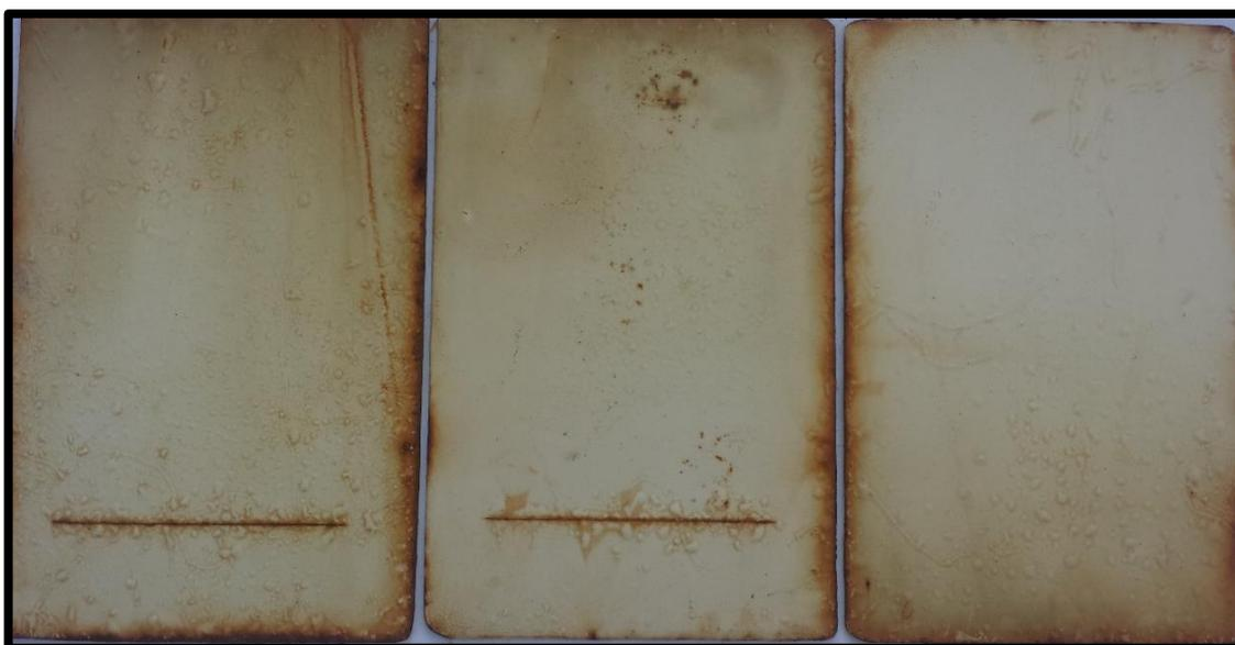
**Figura 30.** Placas de acero ASTM A 131-01 grado A pintadas con recubrimiento siloxano de alto contenido de sólidos (PSX 700) al cabo de dos años de exposición en atmósfera marina.
