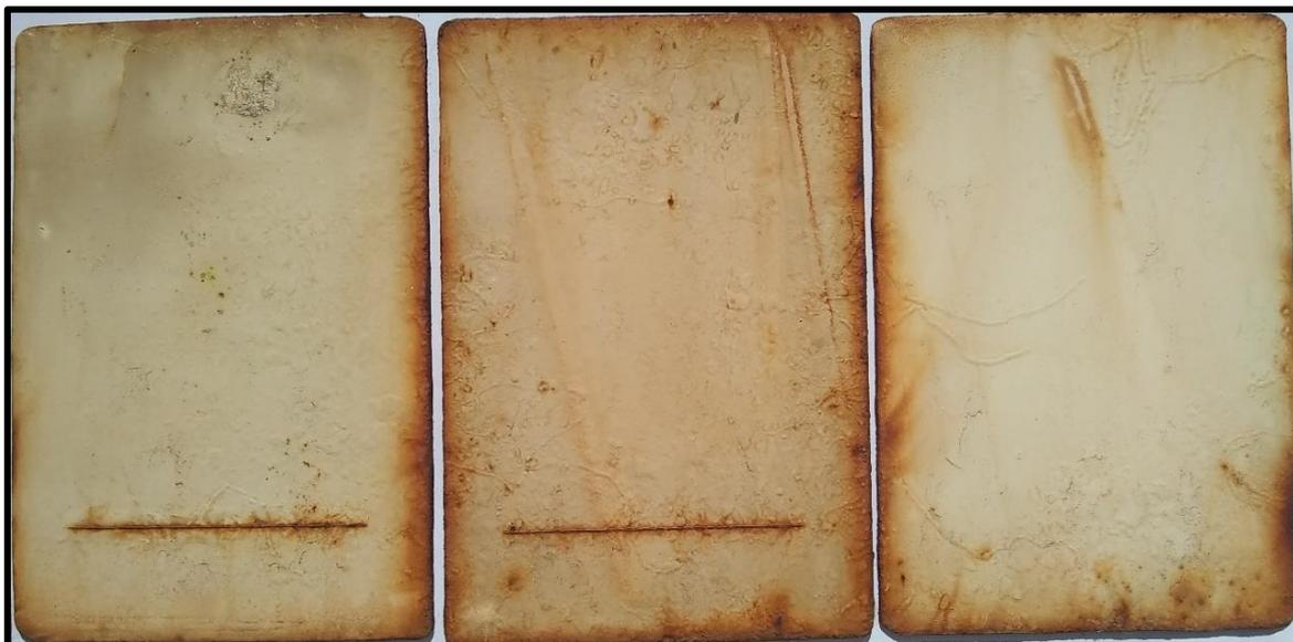
**Figura 32.** Placas de acero ASTM A 131-01 grado A pintadas con recubrimiento Siloxano de alto contenido de sólidos (PSX 700) al cabo de tres años de exposición en atmósfera marina en la Bahía El Ferrol del puerto de Chimbote. Podemos notar a simple vista el cambio en el tono de color, la pérdida de brillo, la aparición de ampollas en gran parte de la superficie. siendo mas abundantes en las zonas de incisión, el óxido en los bordes aumentó ligeramente.
