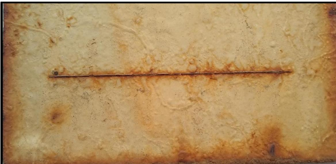
**Figura 33.** Aquí se aprecia la parte mas afectada de las muestras pintadas con PSX 700 que mostramos en la figura 32, se aprecia la zona de incisión con muy poca corrosión, no se observa delaminado ni agrietamiento, solo se aprecia la formación de ampollas pequeñas y medianas en la zona de incisión y zonas aledañas, la corrosión es mínima en ciertos puntos cercanos a los bordes del sustrato.
