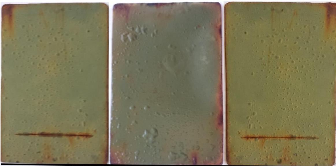
**Figura 17.** Placas de acero ASTM A 131-01 grado A con recubrimiento de la pintura anticorrosiva alquídica modificada,” después de dos años de exposición en atmósfera marina. En general, las ampollas han aumentado de tamaño.
