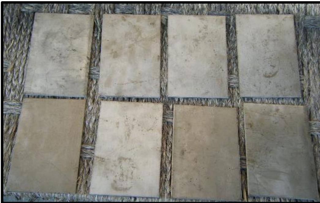
**Figura 7.** Placas de acero naval ASTM A 131-01 Grado A antes de la preparación de la superficie para el proceso de recubrimiento con pinturas anticorrosivas.
