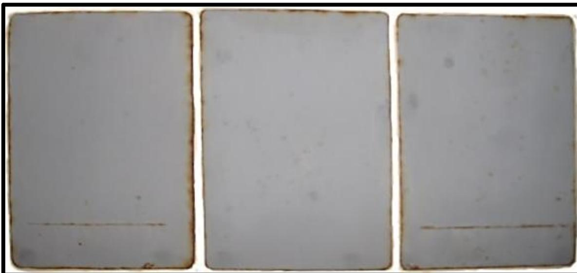
**Figura 21.** Muestras de pintura acrílica base agua (Amercoat 220) sobre placas de acero ASTM A 131-01 grado A al cabo de un año de exposición en atmósfera marina Aparece leve óxido en las incisiones y en los bordes de los sustratos, no se aprecia la formación de ampollas; el nivel de protección para este periodo es muy bueno.
