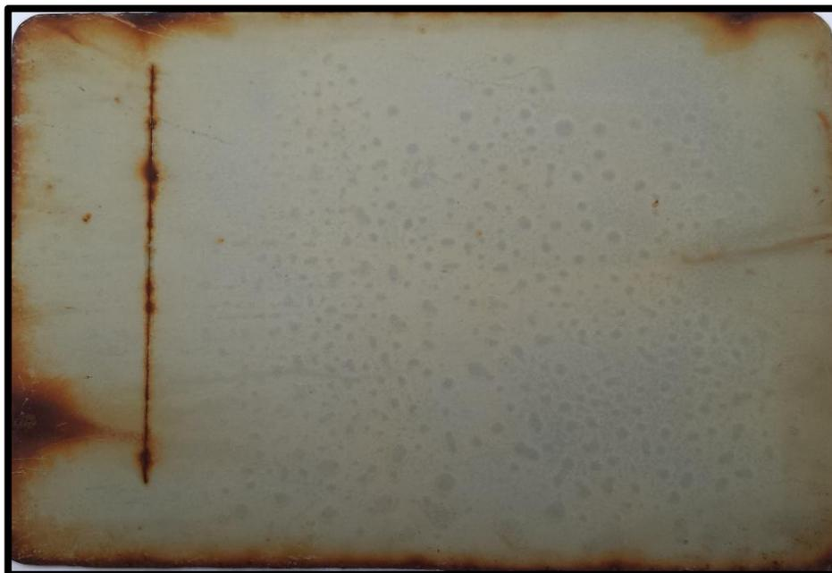
**Figura 23.** Se aprecia a simple vista la densidad y tamaño de las ampollas en la superficie de la Placa de acero ASTM A 131-01 grado A, estas fueron aumentando en densidad y tamaño hasta provocar delaminado y agrietamiento la capa de pintura en ciertas zonas como se puede ver en las imágenes abajo.
