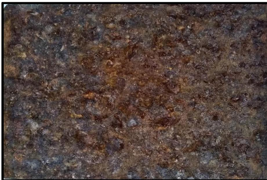
**Figura 11.** Una vista más cercana de la placa con tres años de exposición. Las áreas más oscuras corresponden a magnetita ( $\text{Fe}_3\text{O}_4$ ).
