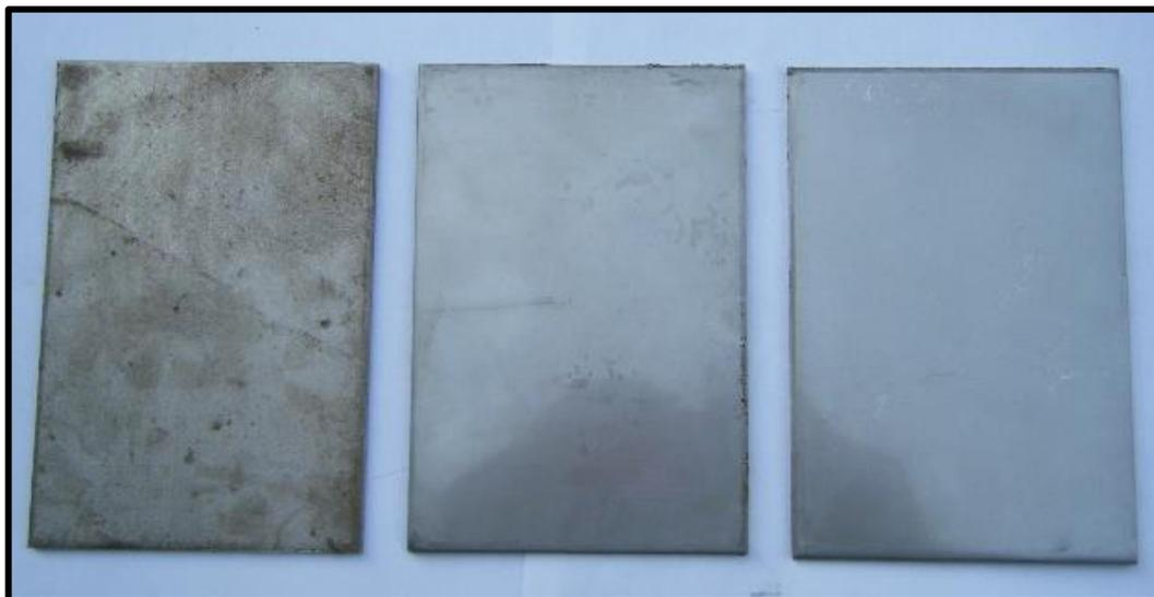
**Figura 14.** Placas de acero ASTM 131-01 Grado A (que fueron los sustratos para los recubrimientos de pinturas) antes del granallado. Se aprecia manchas, óxidos y rayaduras en la superficie de los sustratos.
