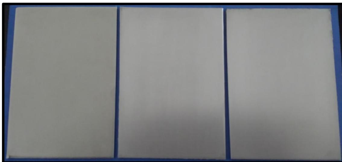
**Figura 15.** Placas de acero ASTM 131-01 Grado A (que fueron los sustratos para los recubrimientos de pinturas) después del granallado al grado metal blanco, que es la condición requerida antes de aplicar las pinturas, según las normas SSPC-SP-5, NACE -1, SS 055900.
