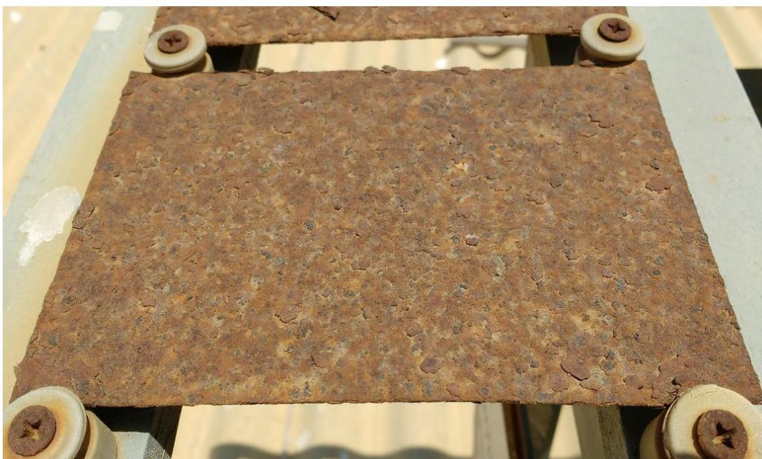
**Figura 13.** Placa de acero ASTM A 36, de 100x50x1.2 mm, expuesta a la atmósfera costera–urbana de la ciudad de Tumbes, a 150 m de la orilla del mar, durante tres años.
