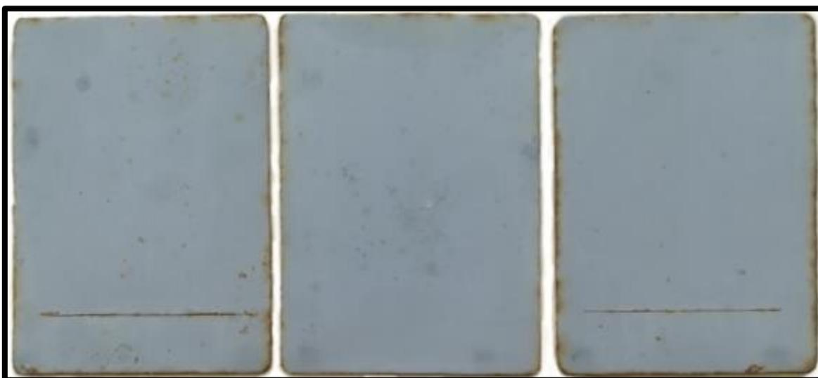
**Figura 25.** Placas de acero ASTM A 131-01 grado A pintadas con Pintura Epóxica de alto contenido de sólidos (Amercoat 240) al cabo de un año de exposición en atmósfera marina del puerto de Chimbote. Se aprecia la aparición de óxido en algunas partes de los bordes y en la zona de incisión, mas no presenta ampollamiento en la superficie de los sustratos. El nivel de protección anticorrosiva es muy bueno.
