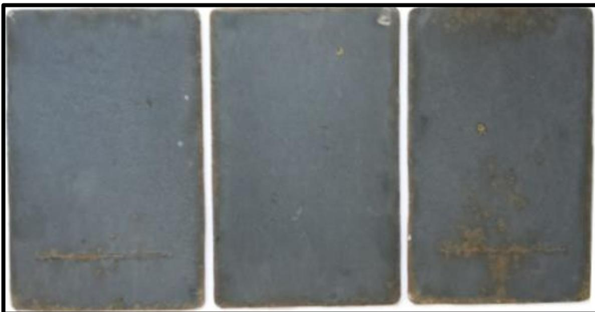
**Figura 26.** Placas de acero ASTM A 131-01 grado A pintadas con pintura epóxica de alto contenido de sólidos (Amercoat 240) al final de dos años de exposición en atmósfera marina.
