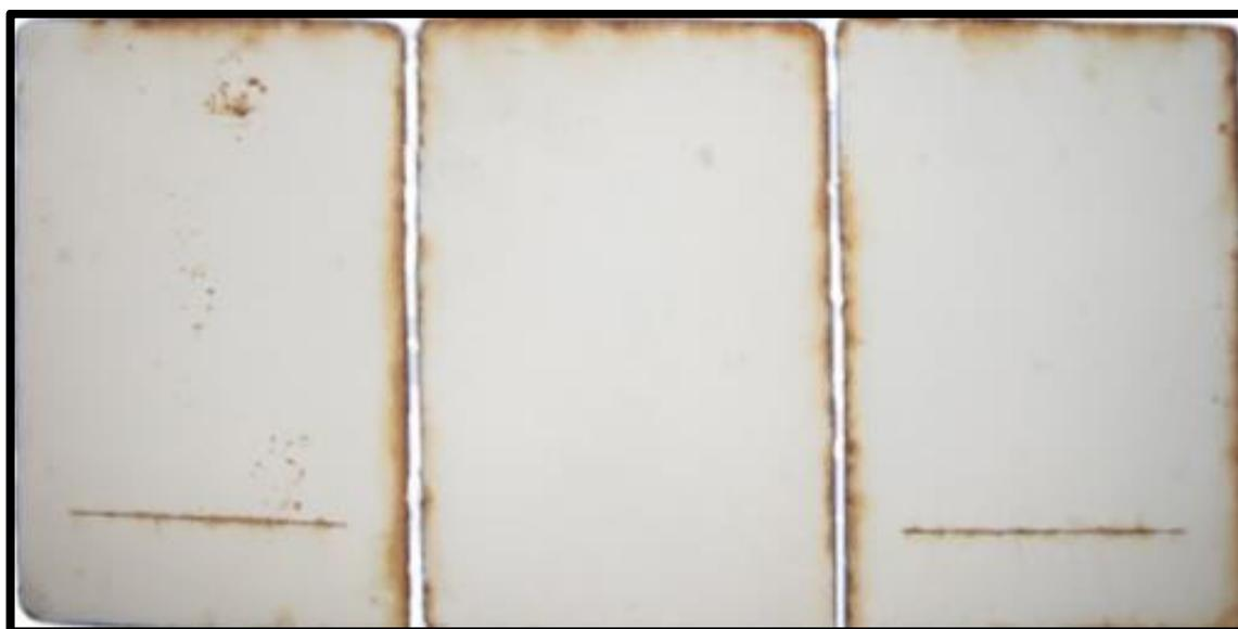
**Figura 29.** Placas de acero ASTM A 131-01 grado A que fueron pintadas con recubrimiento Siloxano de alto contenido de sólidos (PSX 700) después de un año de exposición en atmósfera marina en el puerto de Chimbote, para este periodo de exposición no se han formado ampollas en la superficie de los sustratos, tampoco es significativa la formación de corrosión en las incisiones; se puede notar la aparición de óxido en los bordes de los sustratos.
