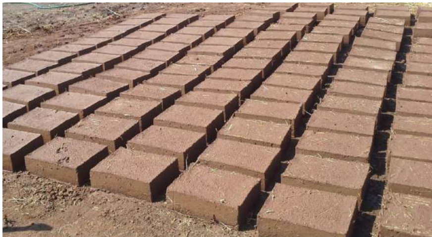
Figura 10. Adobes elaborados con barro y paja secados al sol. Fuente: Tomado de https://construcciondeadobesdonfedo.wordpress.com/
