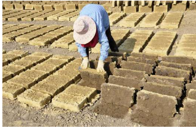
Figura 14. Secado de los adobes en todas sus caras. Fuente: https://eudomus.com/como-hacer-ladrillos-de-adobe/
