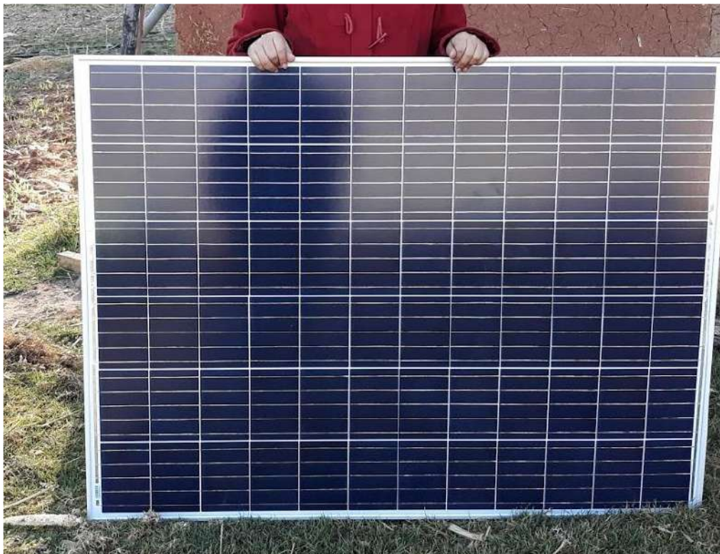
Figura 166. Panel solar de 200W 12V policristalino. Fuente: Toma propia.
