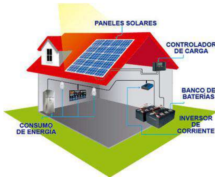
Figura 32. Componentes de una instalación de paneles solares en una vivienda. Fuente: https://energialimpiaparatos.com/2018/06/09/cmtod-fmtd/
