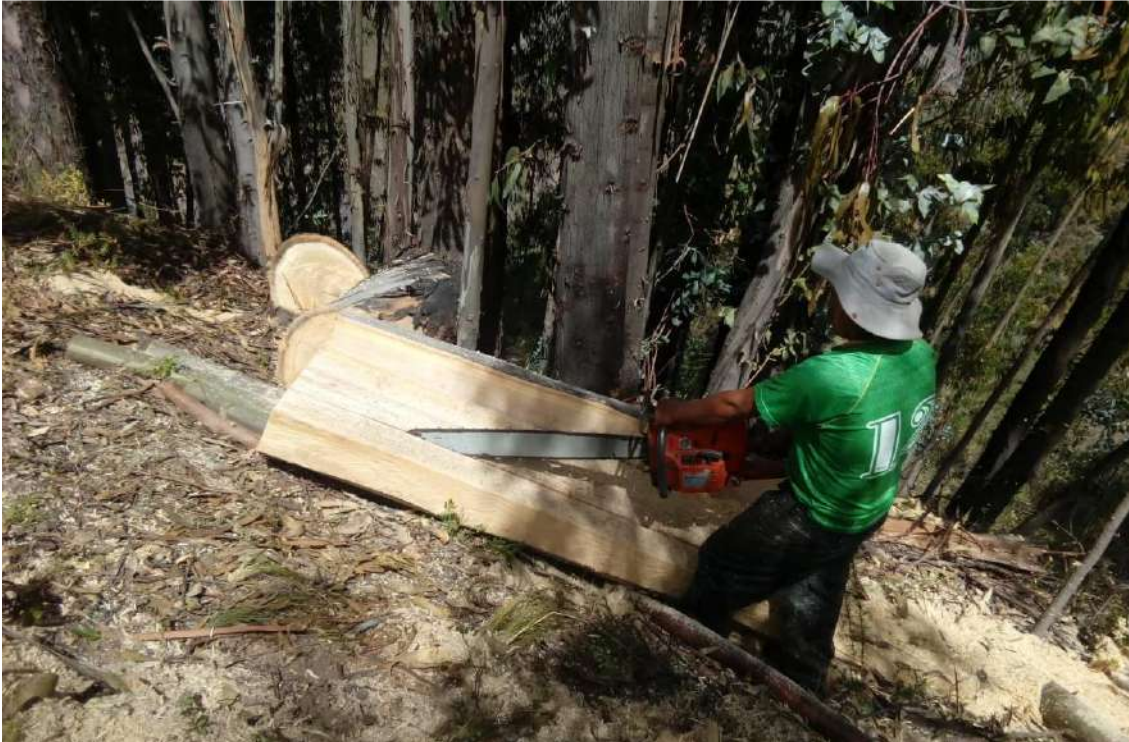
Figura 141. Corte de madera para la elaboración de vigas, tijerales y puertas. Fuente: Toma propia.
