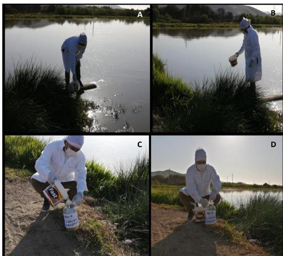
**Figura 4.** Colecta de agua residual doméstica de la laguna de oxidación del distrito de Casma. A) punto de muestreo. B) toma de muestra. C) llenado de la muestra. D) rotulación de la muestra.
