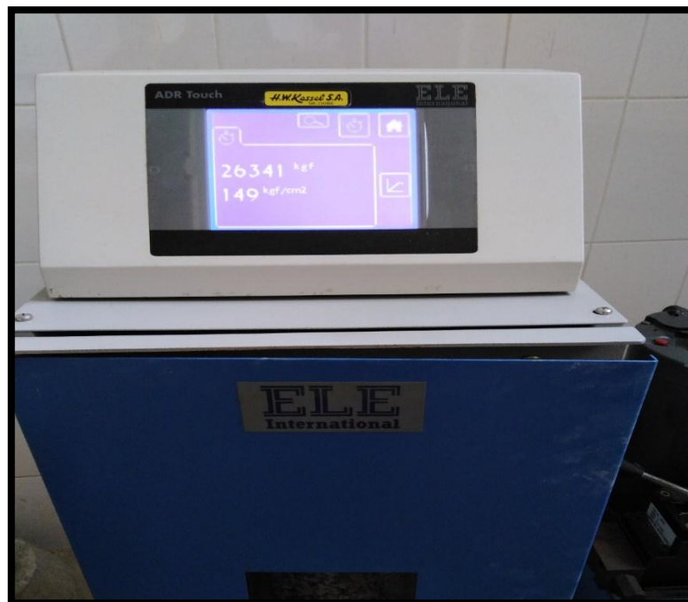
Fotografía 20. Ensayo de compresión de la muestra con adición al .125% de tiras de polietileno, a los 28 días de curado.
