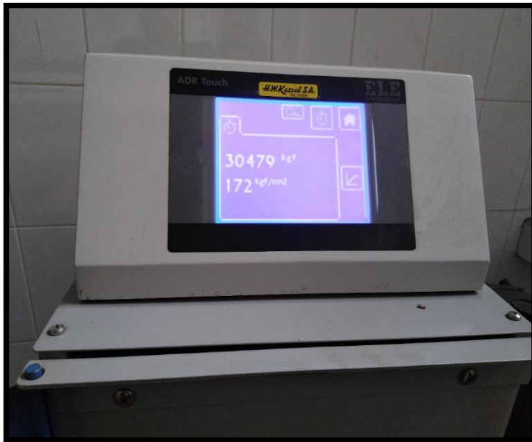
Fotografía 18. Ensayo de compresión de la muestra con adición al .075% de tiras de polietileno, a los 28 días de curado.
