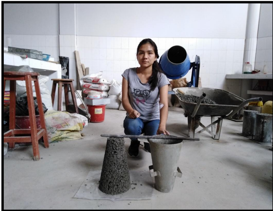
Fotografía 12. Ensayo de asentamiento Cono de Abrams del concreto permeable (0 slump).
