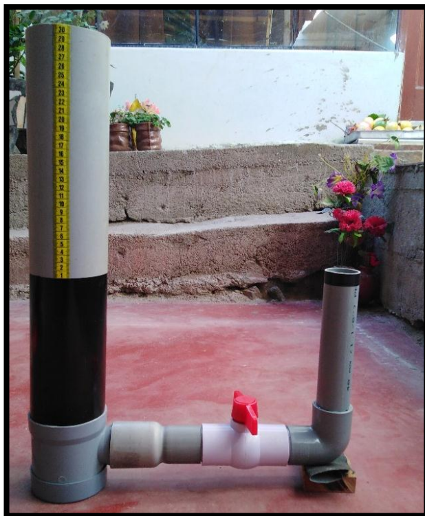
Fotografía 24. Permeámetro de carga variable (equipo recomendado por el ACI 522).
