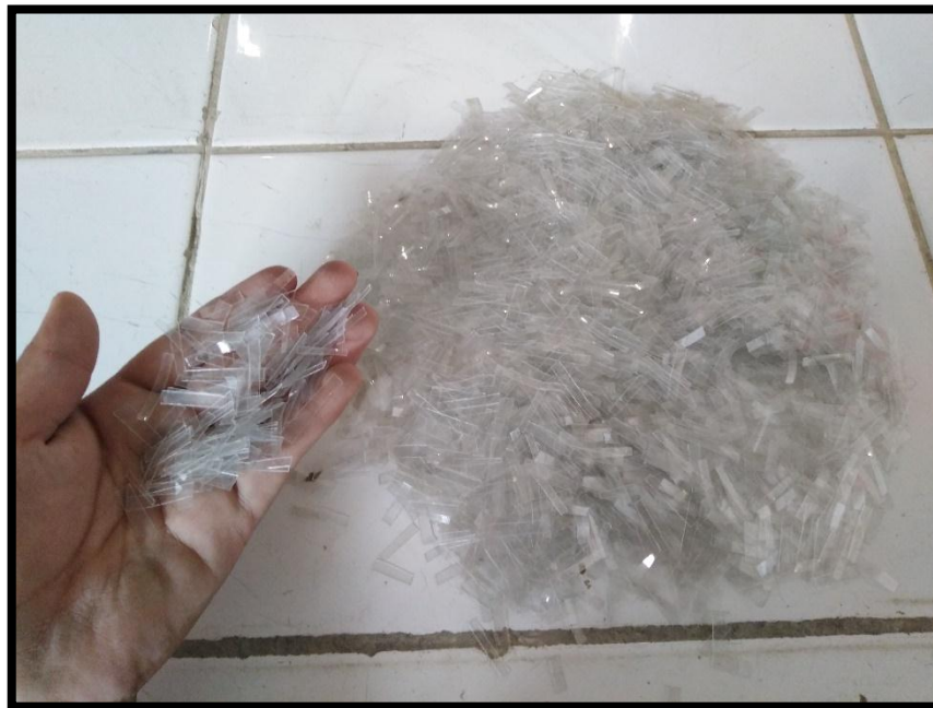
Fotografía 6. Tiras de polietileno de baja densidad de 4 x 20 mm.
