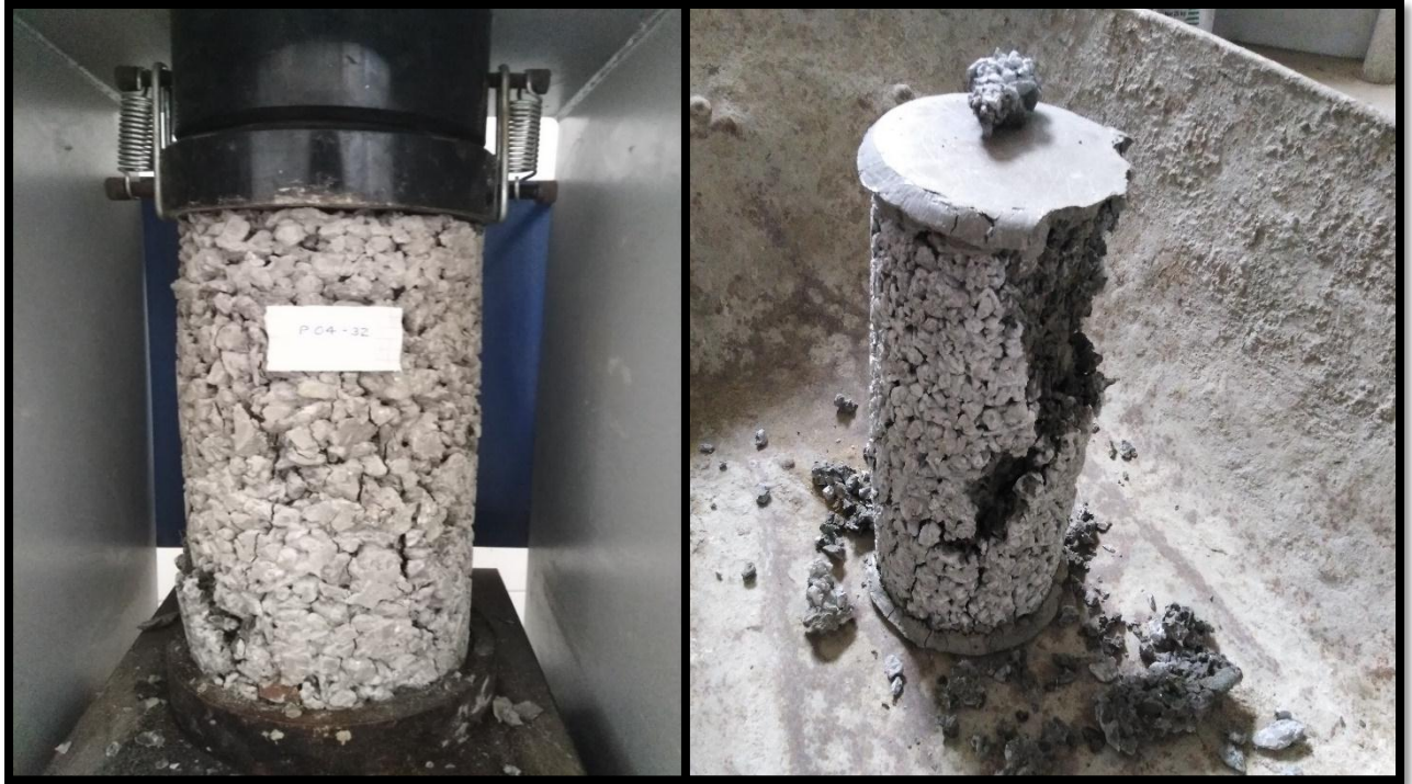
Fotografía 21. Falla por corte y fisura en el extremo de la muestra de concreto permeable.
