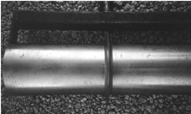
Fig. Vista de la herramienta de unión para el concreto permeable 8,11-detallada.
