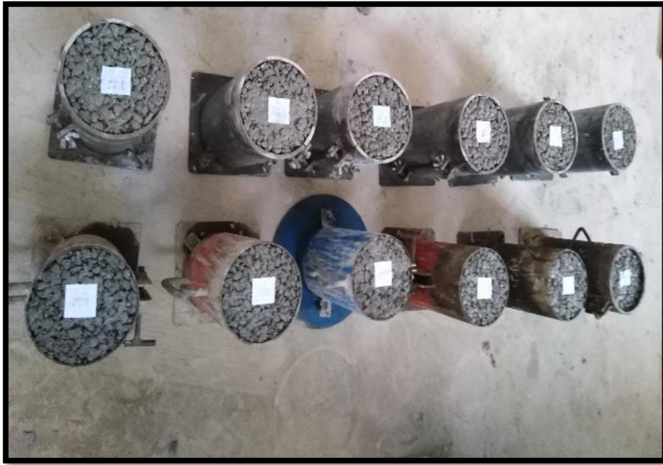
Fotografía 11. Acabado del concreto permeable.
