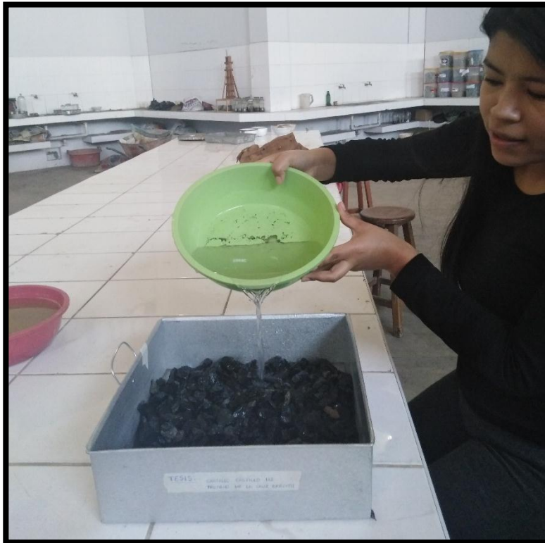
Fotografía 4. Saturación de la muestra granular representativa para el ensayo del peso específico del agregado grueso.
