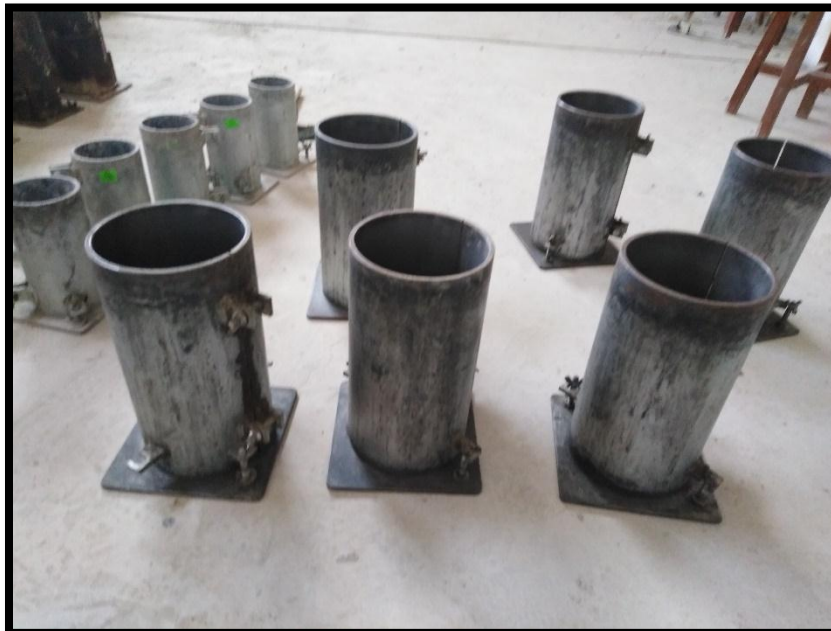
Fotografía 8. Moldes metálicos limpios y engrasados, aptos para el vaciado del concreto permeable.
