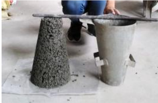
Figura 2. Concreto permeable de cero slump. Fuente: Elaboración propia
