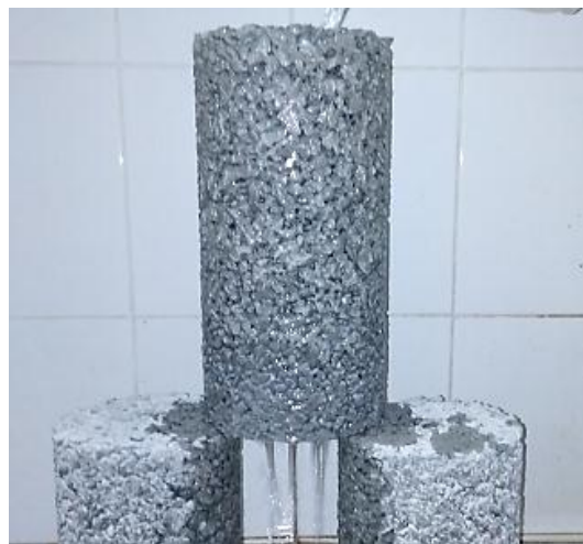
Figura 1. Filtración del agua a través de los poros conectados en la estructura del concreto permeable.
