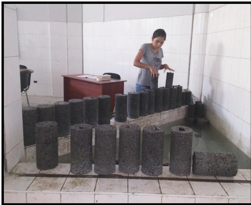
Fotografía 14. Retiro de las probetas de la poza para las roturas a los 7, 14, y 28 días.
