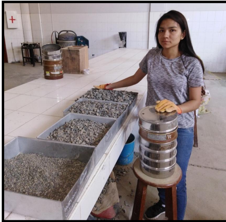
Fotografía 5. Agregados clasificados según el tamaño requerido por el Huso 67.
