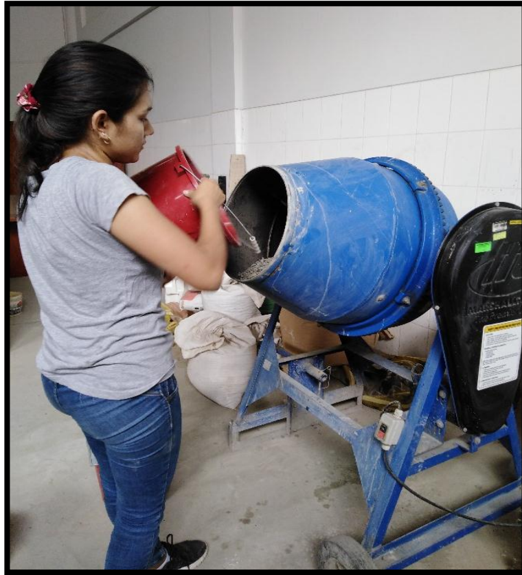
Fotografía 7. Elaboración de concreto permeable con mezcladora.
