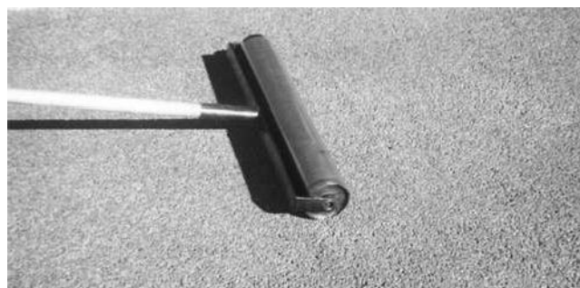
Fig. 8.8-Ejemplo de pequeño rodillo utilizado para la compactación pequeña zona pavimentada.
