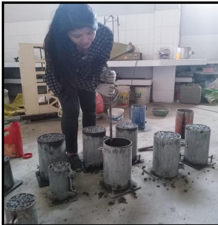
Fotografía 10. Varillado del concreto permeable.
