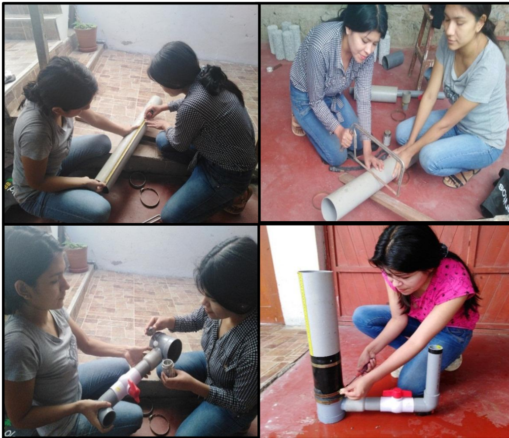
Fotografía 23 . Proceso de construcción del permeámetro de carga variable.
