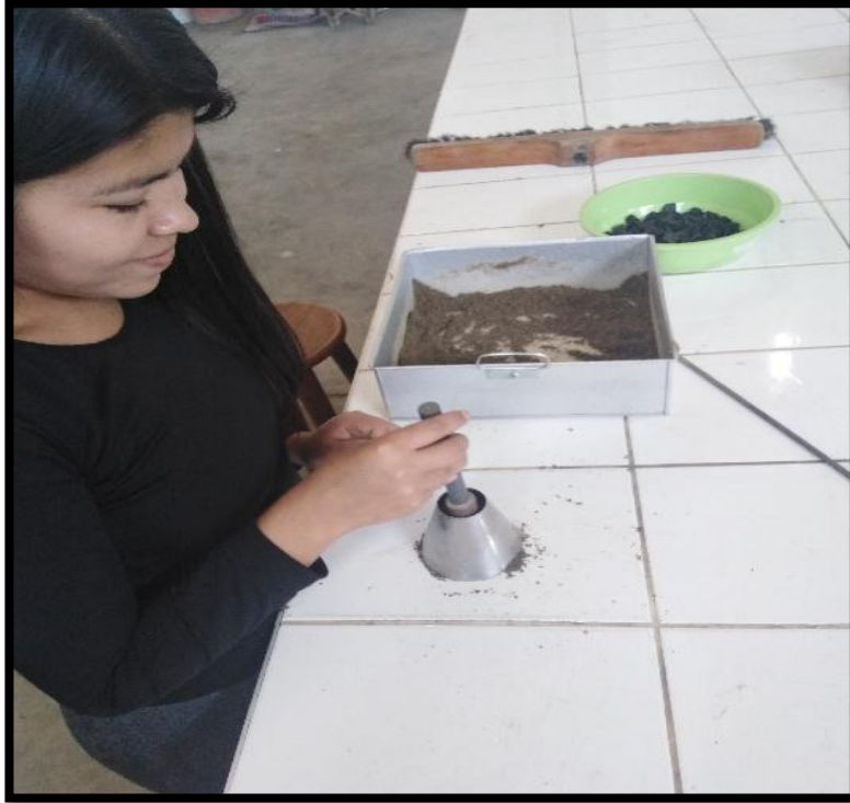
Fotografía 3. Ensayo del peso específico del agregado fino, realizando la prueba del molde cónico.
