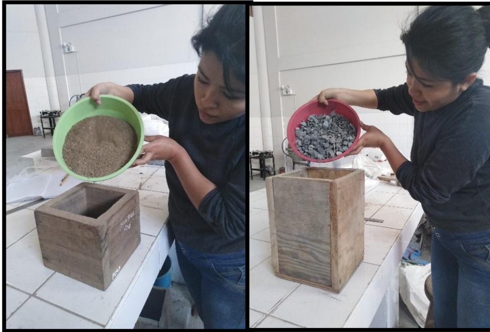
Fotografía 1. Ensayo de peso unitario suelto del agregado fino y grueso respectivamente
