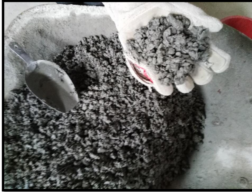
Fotografía 9. Consistencia del concreto en estado fresco.
