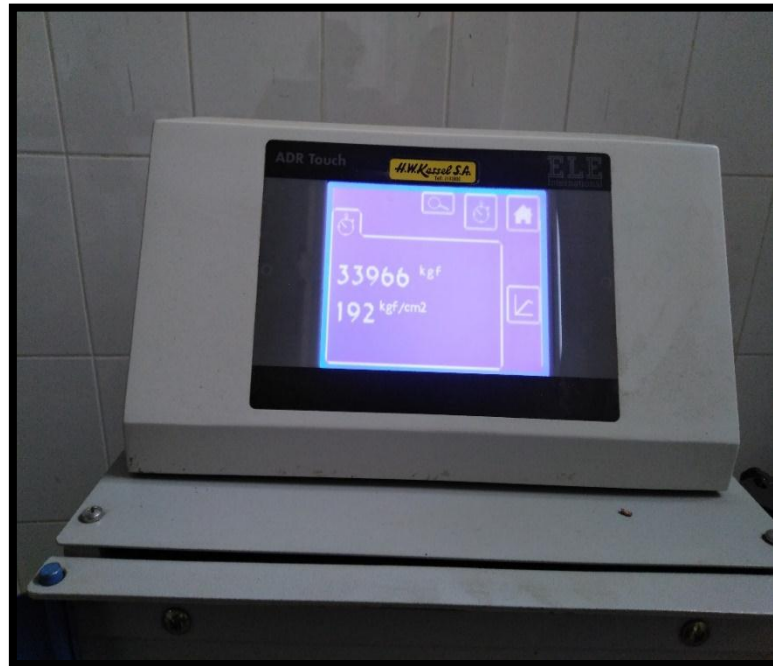
Fotografía 19. Ensayo de compresión de la muestra con adición al .075% de tiras de polietileno, a los 28 días de curado.
