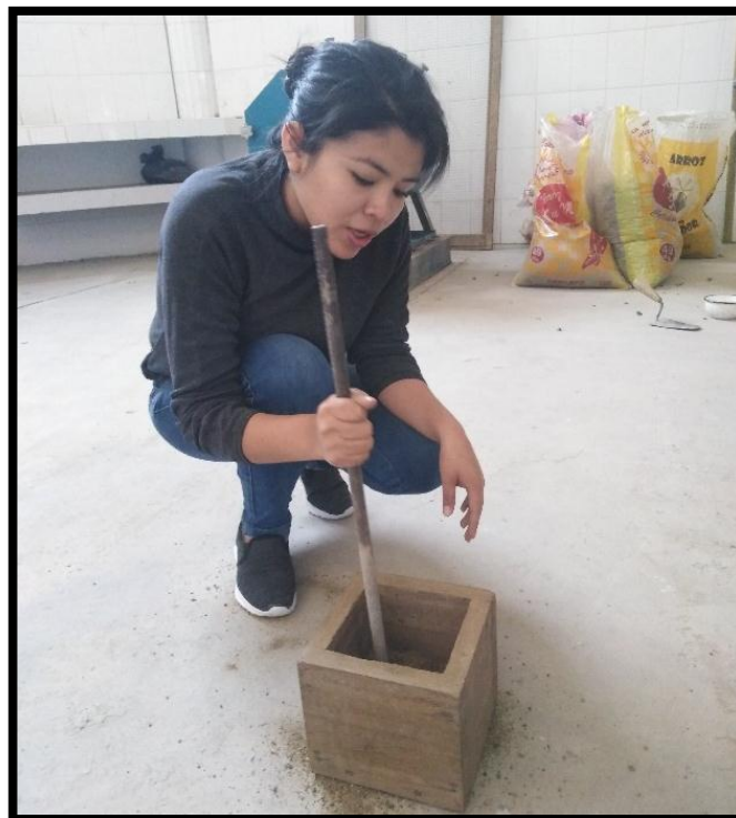
Fotografía 2. Ensayo de peso unitario compactado, haciendo uso de la varilla de 5/8".
