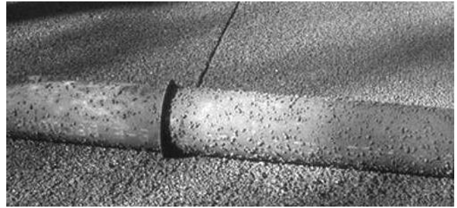
Fig. 8.12-Ejemplo de herramienta de unión integrado en rodillo primario.
