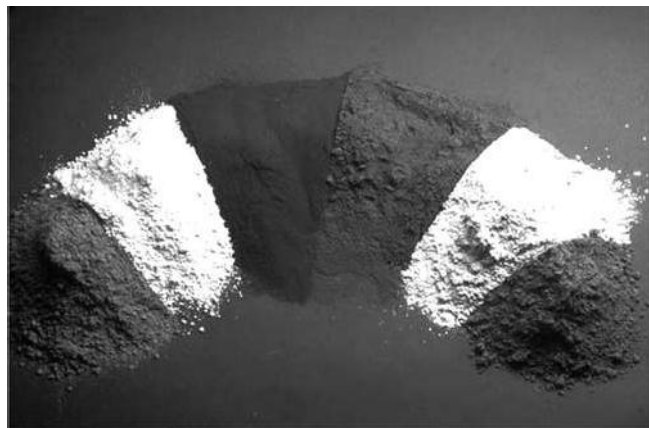
Fig. 12.2. Materiales de cemento 12.2-suplementarios. De izquierda a derecha: la ceniza (clase C) vuela; metacaolín (arcilla calcinada); humo de sílice; cenizas volantes (Clase F); escoria; y esquisto calcinado.
