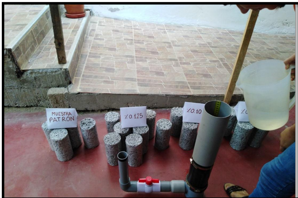
Fotografía 27. Ensayo de permeabilidad
