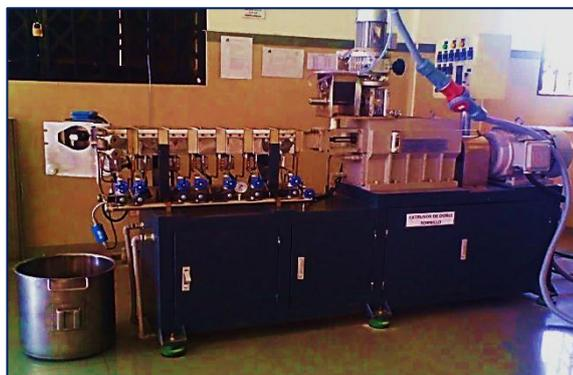
**Figura 04.** Extrusor de doble tornillo, modelo LABOR PQ DRX-50
