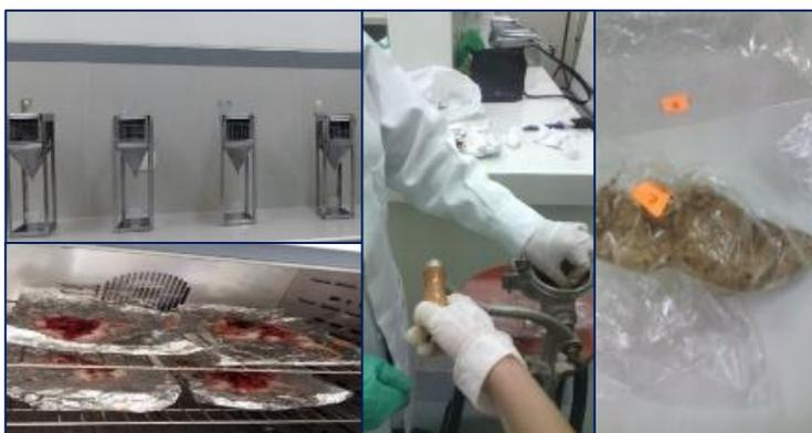
**Figura 12.** Instalación de las ratas en jaulas metabólicas, secado de las carcasas, molienda y homogenizado de las carcasas.
