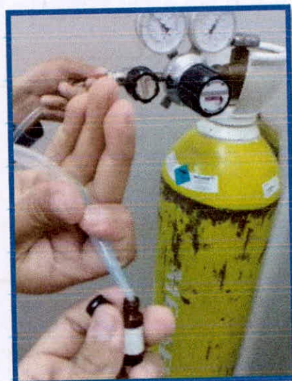
Fotografía xxiii: Después de preparado la muestra vertemos a los viales y cubrimos con Nitrógeno, posteriormente lo guardamos en refrigeración
