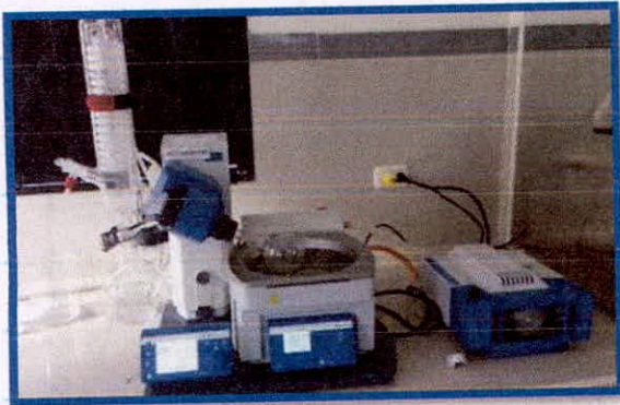
Fotografías xiii y xiv: Llevamos a un rota vapor para quitar todo el cloroformo -metanol
