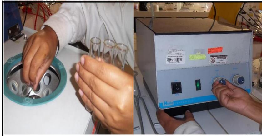
Figura 16: Centrifugación del hidrolizado
