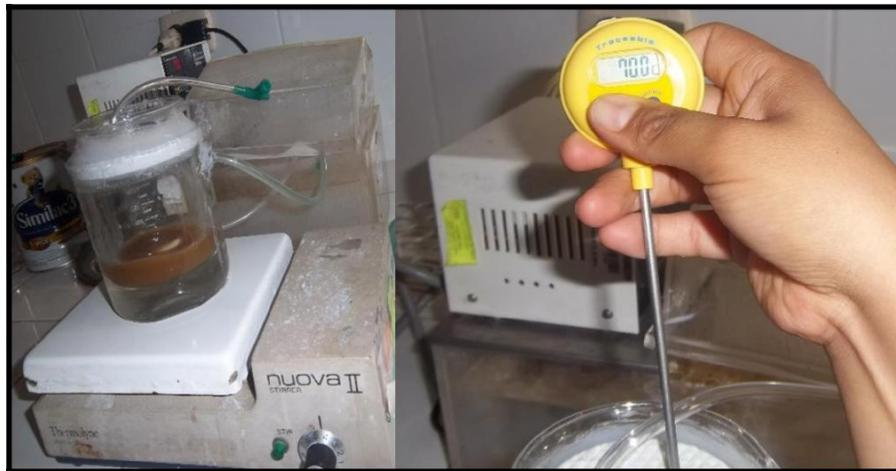
Figura 15: Hidrólisis enzimática y control de temperatura en el minireactor.
