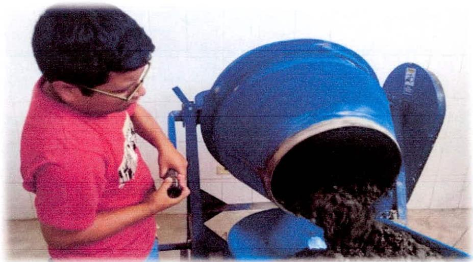
*Figura 8:* Elaboración de Concreto Con fibra de Cepa de Plátano.
