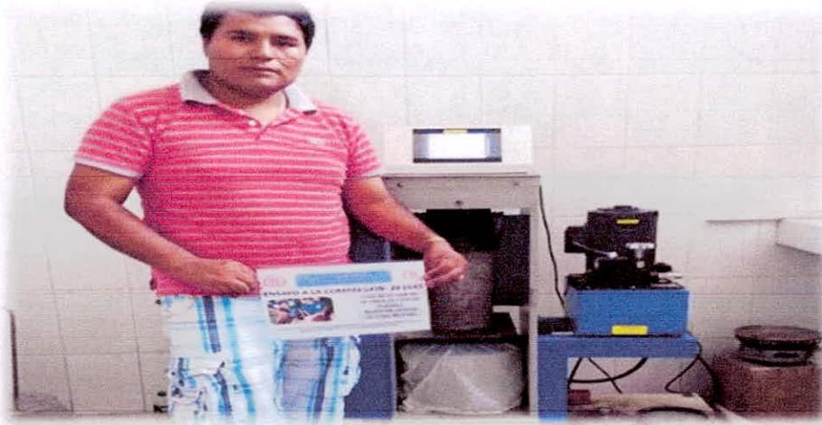
**ENSAYO DE RESISTENCIA A LA COMPRESIÓN.**
