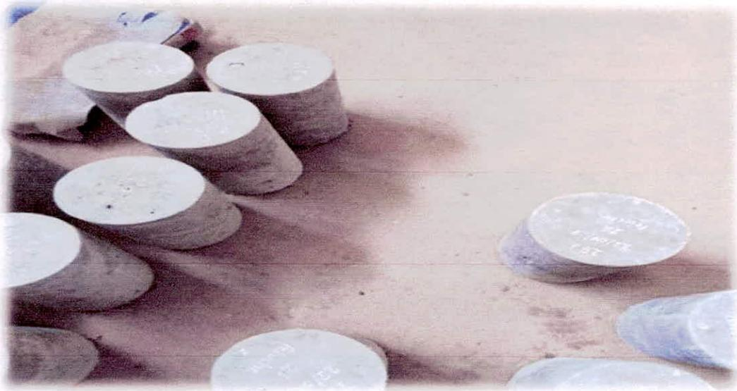
**PROBETAS LISTAS PARA SER SOMETIDAS A ENSAYO DE RESISTENCIA A LA COMPRESIÓN.**
