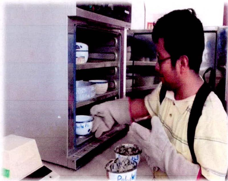
*Figura 7:* Horno Eléctrico Del Laboratorio De La UNS Para Determinar Del Peso Seco
