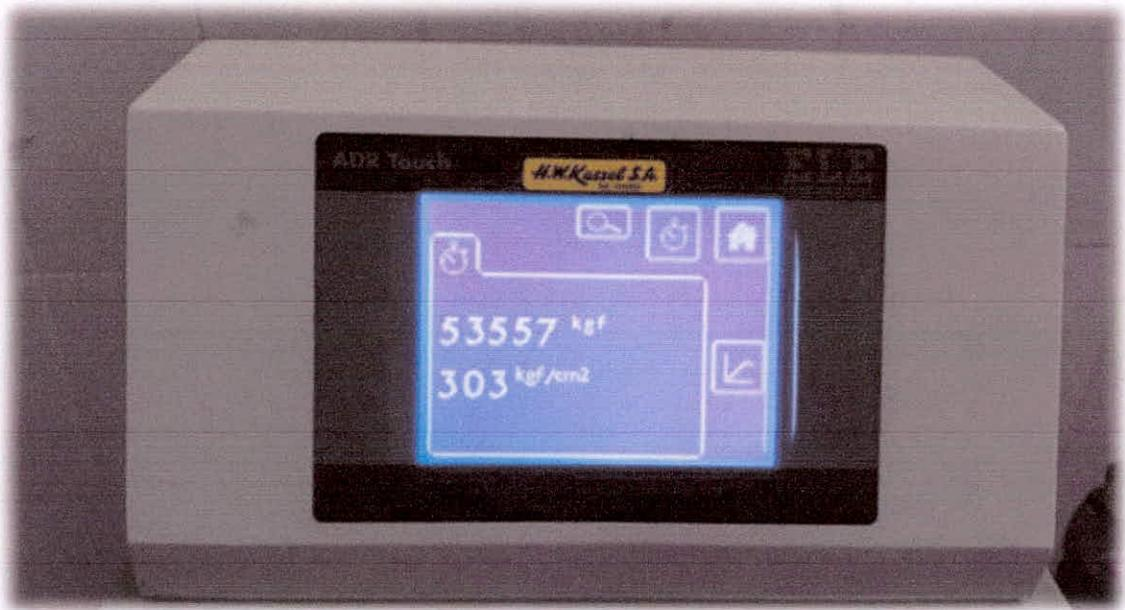
**ENSAYO DE RESISTENCIA A LA COMPRESIÓN- RESISTENCIA
