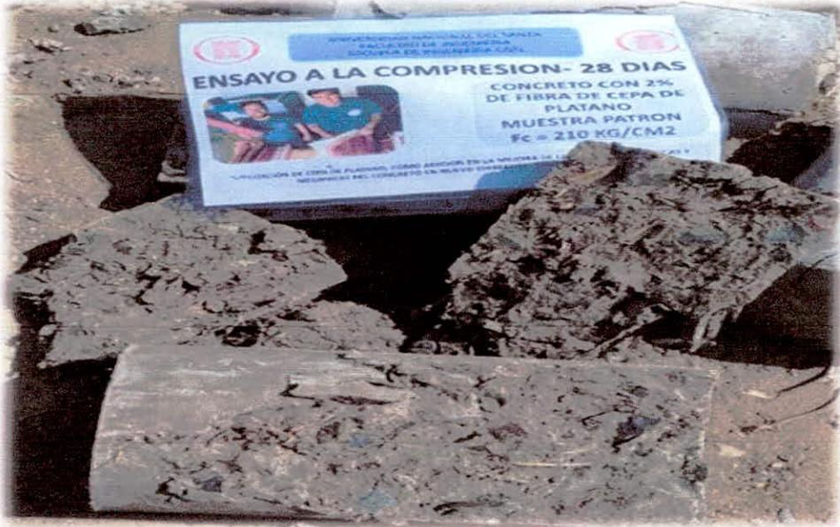
**TESTIGO DE CONCRETO CON 2 % DE ADICIÓN**
