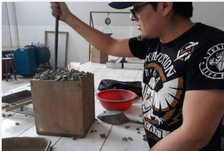
REALIZANDO EL ENSAYO PARA CALCULAR EL PESO VARILLADO DEL
