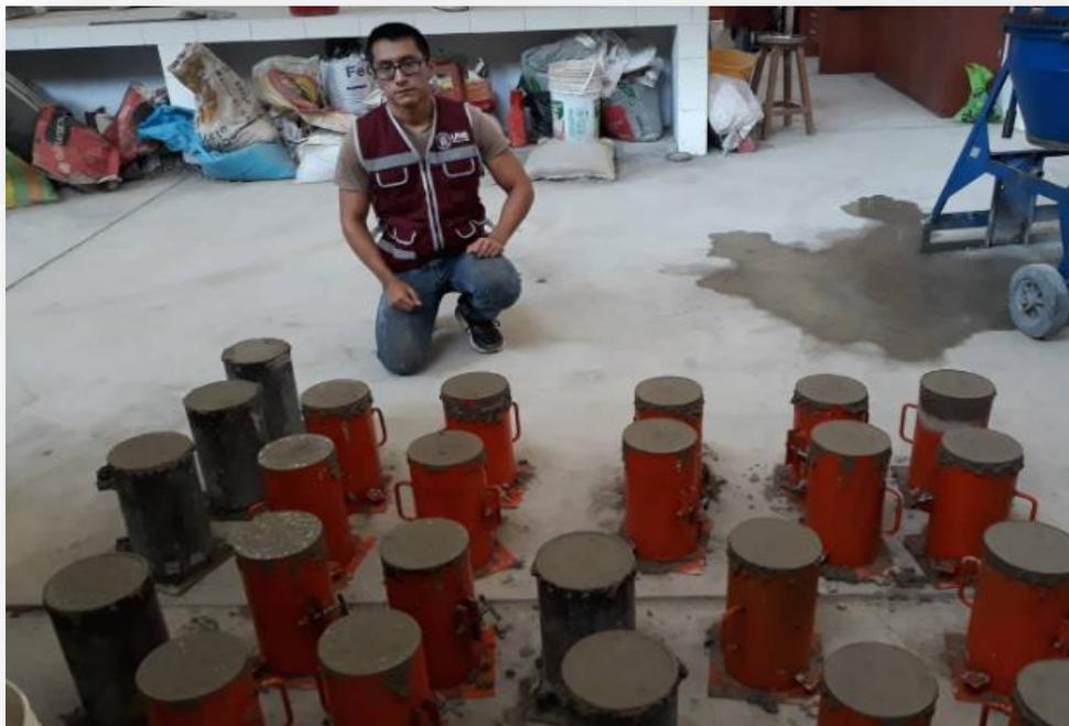
FRAGUADO DEL CONCRETO POR 24 HORAS.
