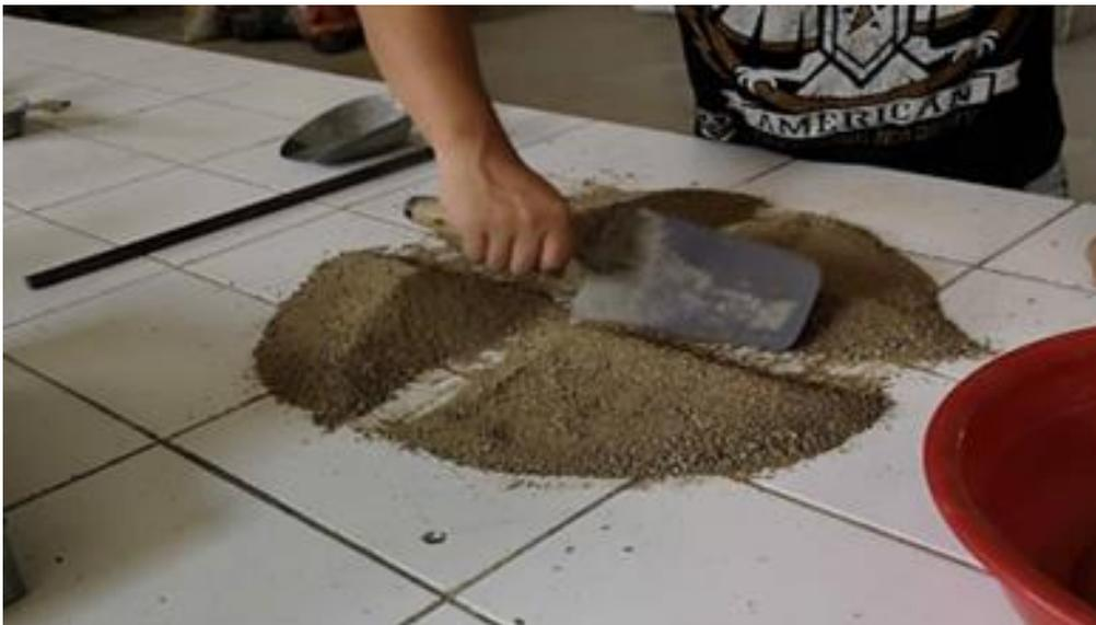
**FIGURA 4: Cuarteo Del Agregado Fino.**
