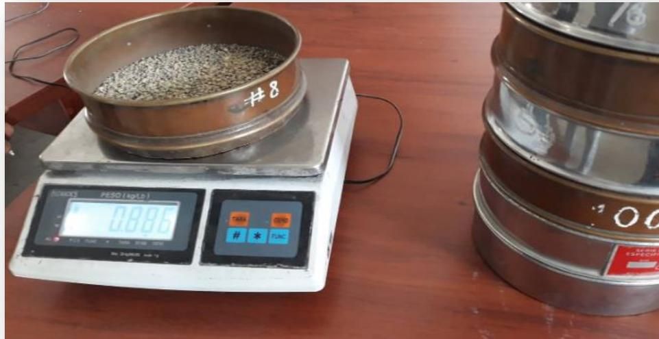
PESANDO LA MUESTRA CONTENIDA EN LA MALLAS PARA LUEGO CALCULAR LA GRANULOMETRÍA DE LOS AGREGADOS.
