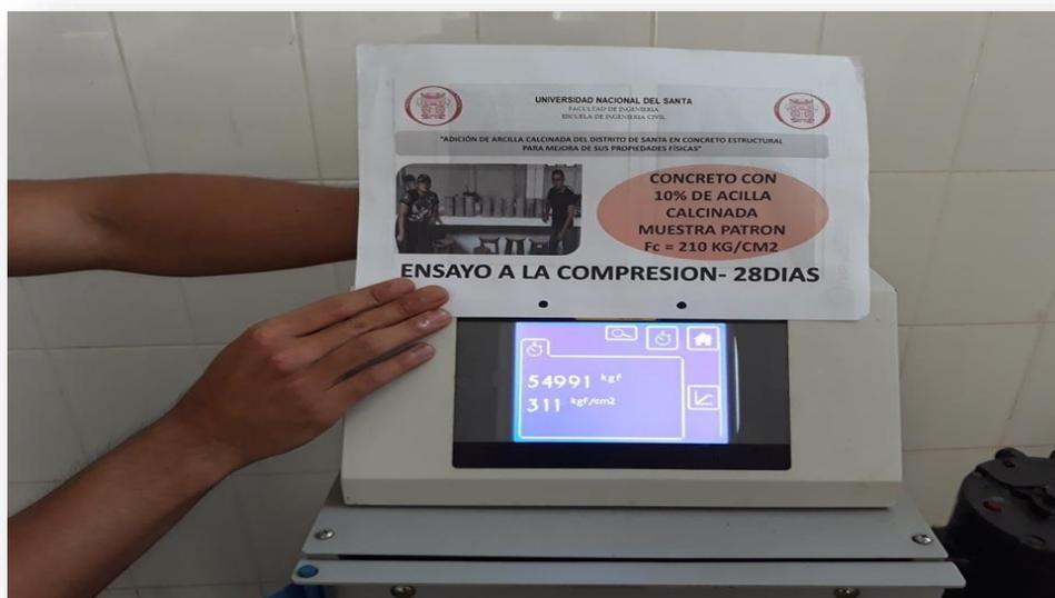
SE OBTUVO UNA RESISTENCIA DE  $311 \text{ Kg/cm}^2$  PARA EL CONCRETO DE  $F'_c: 210 \text{ Kg/cm}^2$ -10% DE ADICIÓN DE ARCILLA CALCINADA A LOS 28 DÍAS
