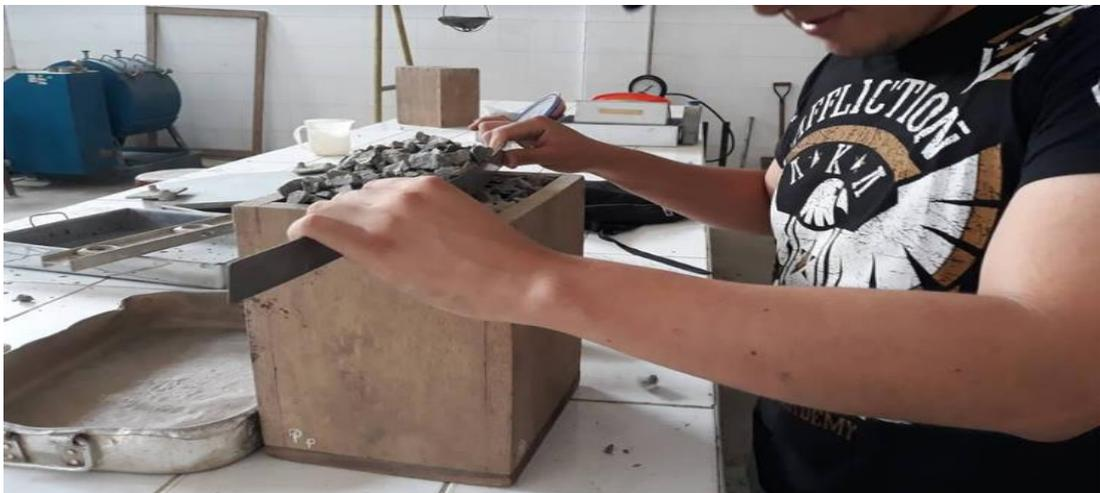
**FIGURA 6: Peso Unitario Varillado Del Agregado Grueso.**
