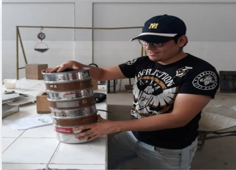
TAMIZADO MANUAL PARA LUEGO CALCULAR LA GRANULOMETRÍA DE LOS AGREGADOS.
