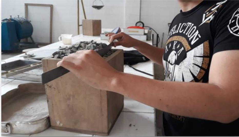
NIVELANDO EL AGREGADO GRUESO PARA LUEGO CALCULAR EL PESO SUELTO DEL AGREGADO GRUESO.
