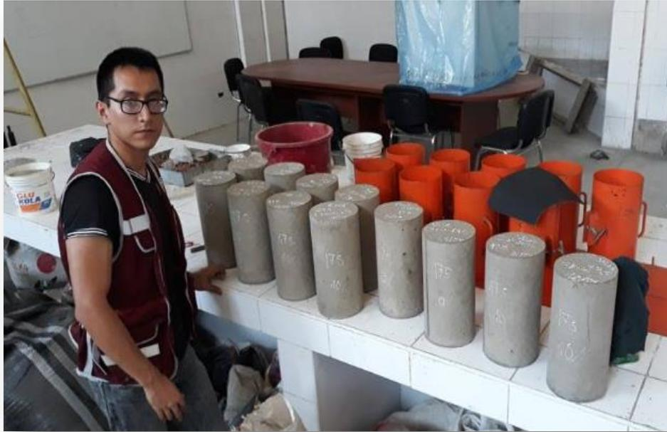
**DESENCOFRADO Y LIMPIEZA DE LAS PROBETAS**
