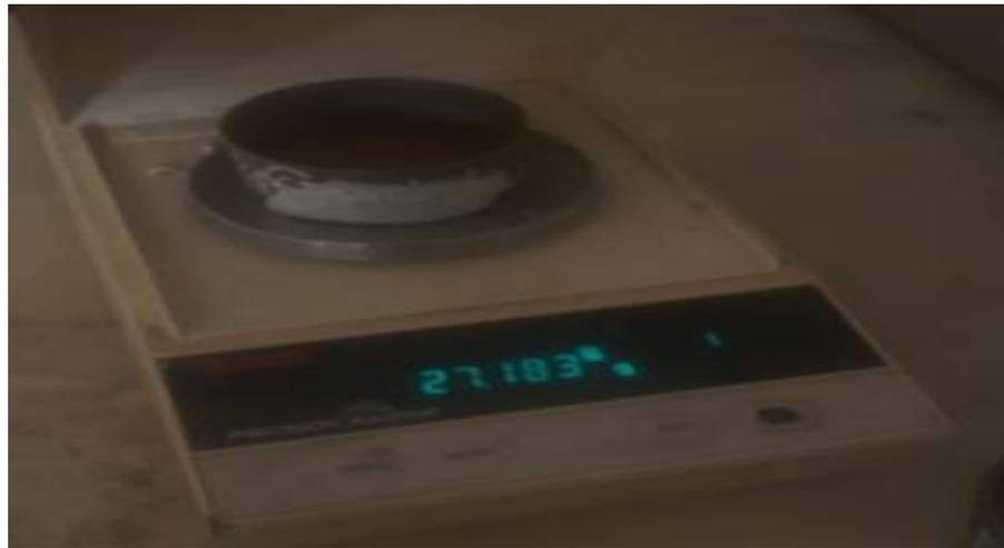
**FIGURA 10: Balanza Para Determinar El Contenido De Humedad**
