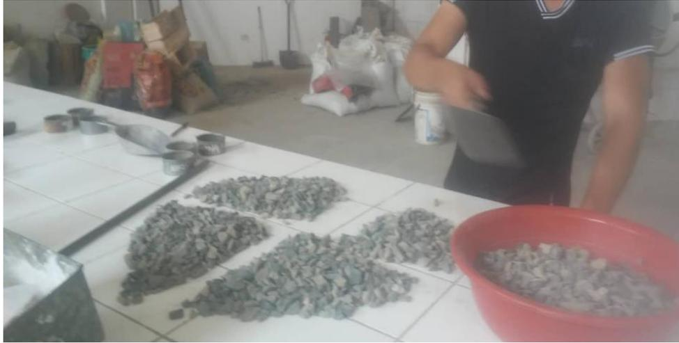
**FIGURA 3. Cuarteo Del Agregado Grueso**
