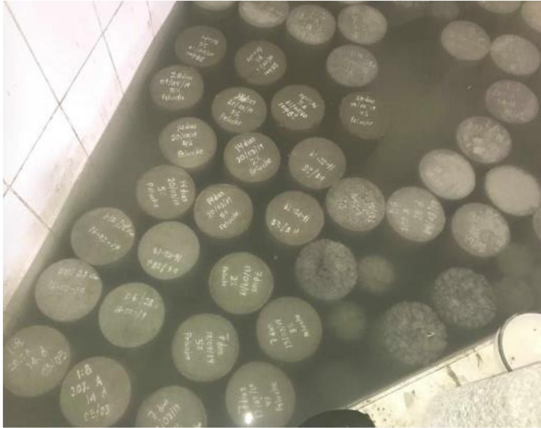
**FIGURA 11: Poza Para Curado De Probetas**
