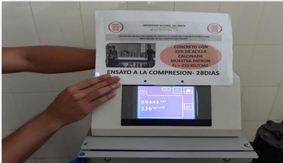
SE OBTUVO UNA RESISTENCIA DE 336 Kg/cm<sup>2</sup> PARA EL CONCRETO DE F'c: 210 Kg/cm<sup>2</sup>-10% DE ADICIÓN DE ARCILLA CALCINADA A LOS 28 DÍAS
