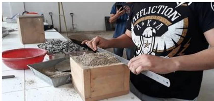
**FIGURA 5: Peso Unitario Suelto Del Agregado Fino**
