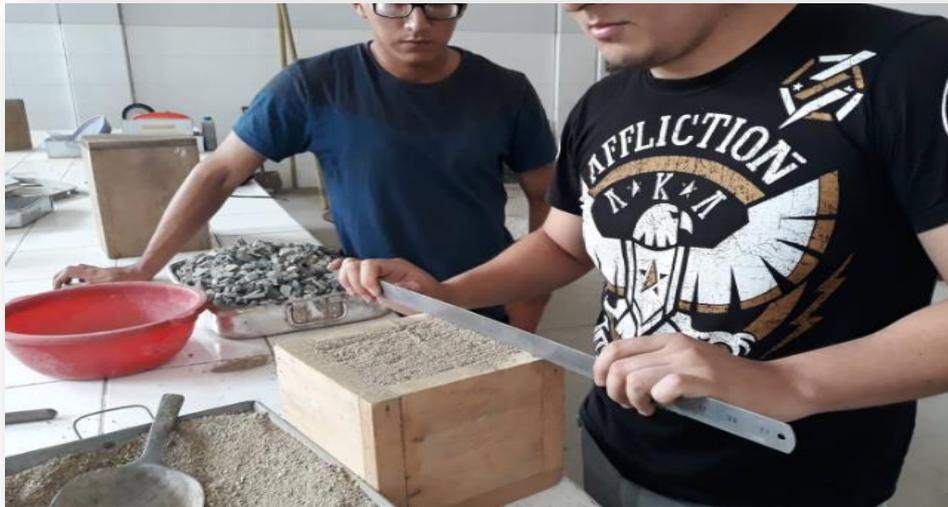
ENRAZANDO EL AGREGADO FINO PARA LUEGO CALCULAR EL PESO SUELTO DEL AGREGADO.
