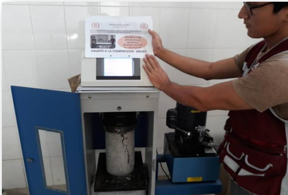
**ENSAYO DE RESISTENCIA A LA COMPRESIÓN DE LOS TESTIGOS
