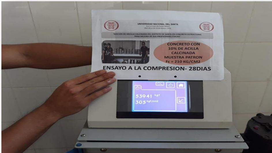
SE OBTUVO UNA RESISTENCIA DE  $305 \text{ Kg/cm}^2$  PARA EL CONCRETO DE  $F'_c: 210 \text{ Kg/cm}^2$ -10% DE ADICIÓN DE ARCILLA CALCINADA A LOS 28 DÍAS
