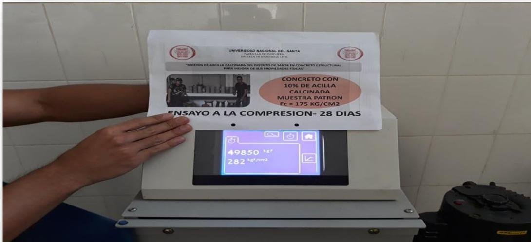
SE OBTUVO UNA RESISTENCIA DE 282 Kg/cm<sup>2</sup> PARA EL CONCRETO DE F'<sub>c</sub>:175 Kg/cm<sup>2</sup> CON 10% DE ADICIÓN DE ARCILLA CALCINADA A LOS 28 DÍAS.
