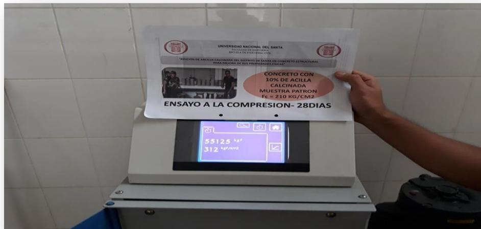
SE OBTUVO UNA RESISTENCIA DE 312 Kg/cm<sup>2</sup> PARA EL CONCRETO DE F'c: 210 Kg/cm<sup>2</sup>-10% DE ADICIÓN DE ARCILLA CALCINADA A LOS 28 DÍAS
