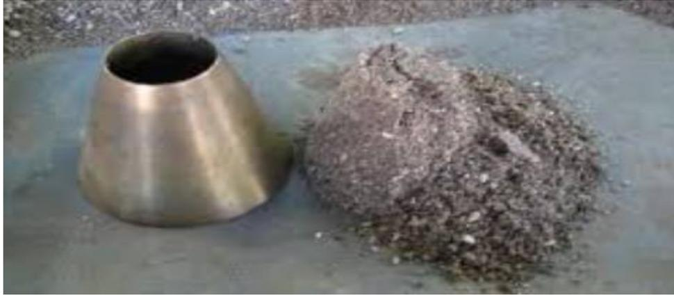
**FIGURA 8: Absorción Del Agregado Fino – Arena En Condición De Superficie Seca**
