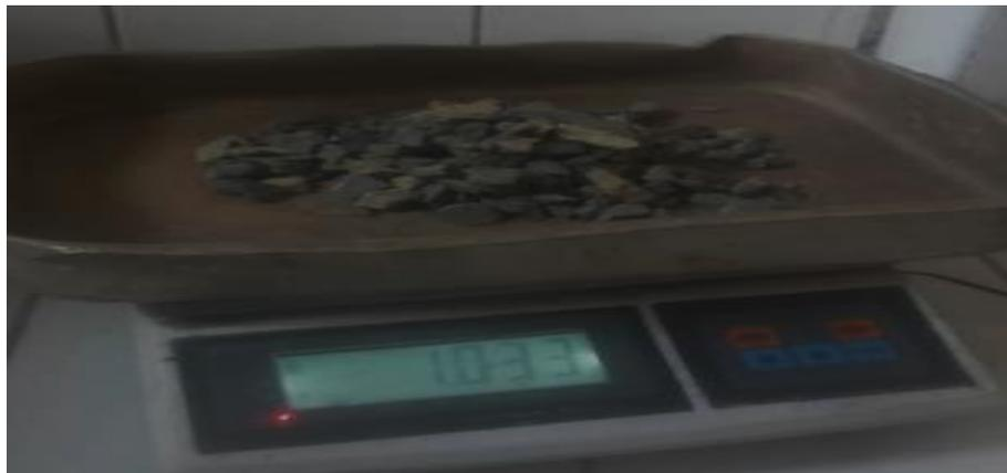
**FIGURA 9: Peso De Agregado Grueso Seco**
