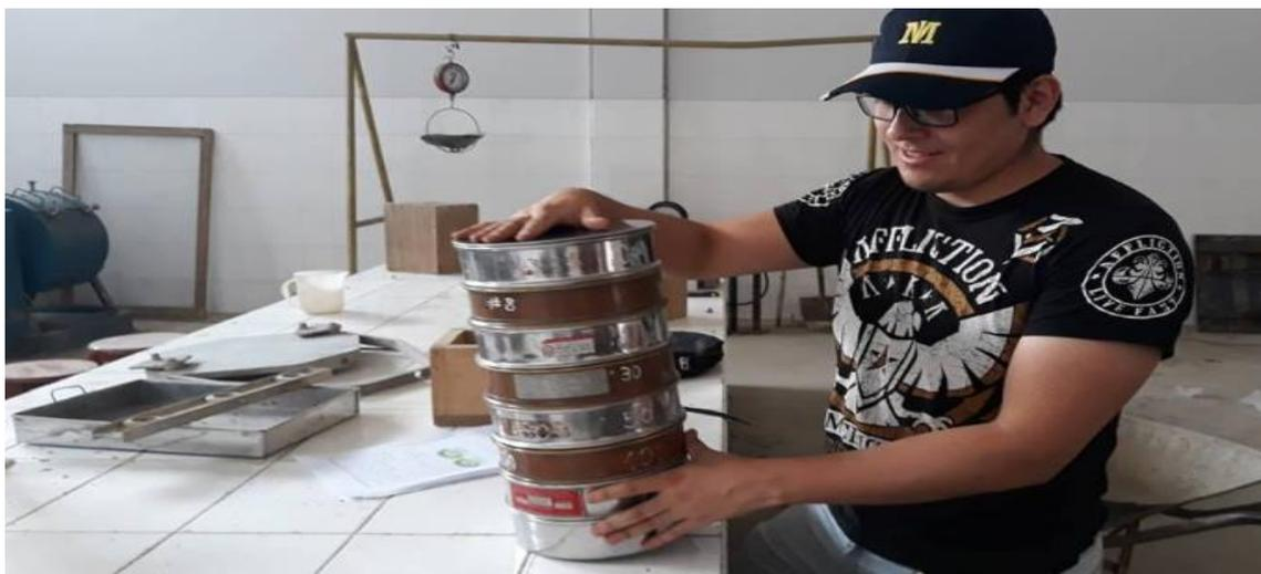
**FIGURA 7: Análisis Granulométrico Del Agregado Fino.**
