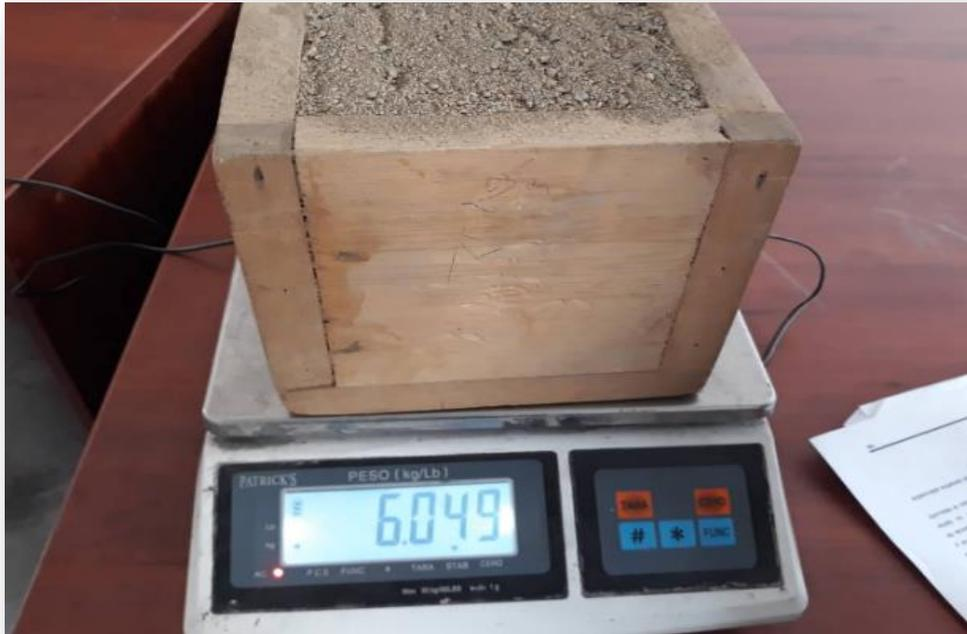
PENSANDO EL AGREGADO FINO PARA OBTENER EL PESO SUELTO..
