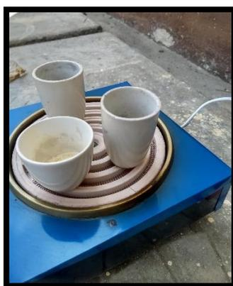
Figura 30 Determinación de cenizas
