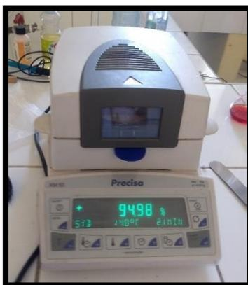
Figura 29 Determinación de humedad
