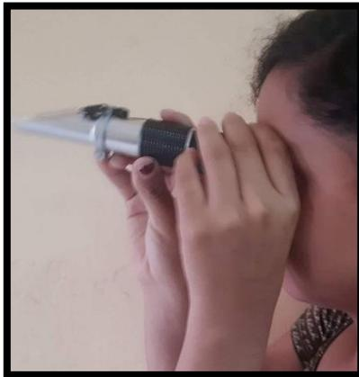
*Figura 33 Medición de Grados Brix*
