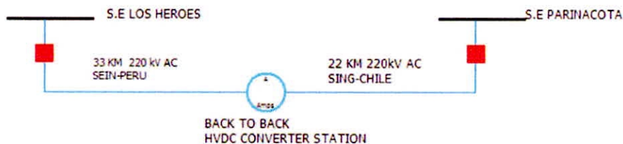
Figura N° 29 Arreglo de convertidor Back to Back de HVDC
