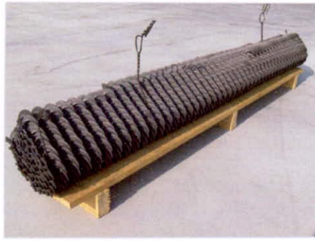
Figura 15. Fabricación y almacenamiento de turbulador tipo helicoide. Fuente. Coronel turbuladores
