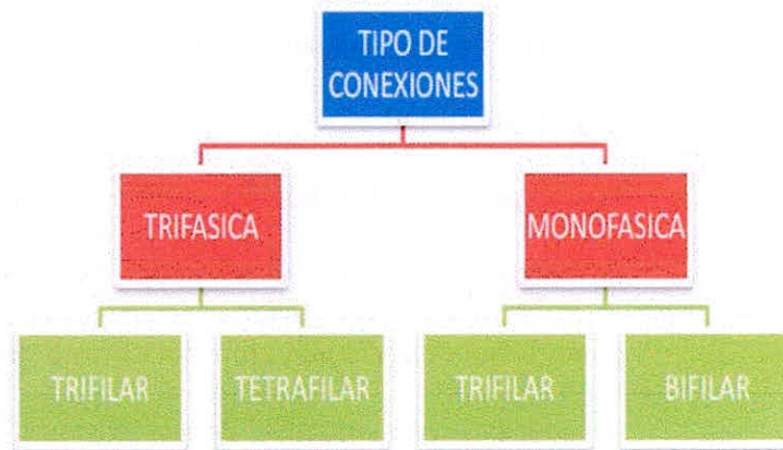
Figura II- 4 Tipo de conexiones
