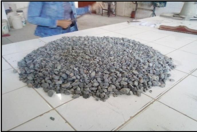
**FOTO N°4:** Se realizó la reducción del agregado grueso para la obtención de muestras representativas.
