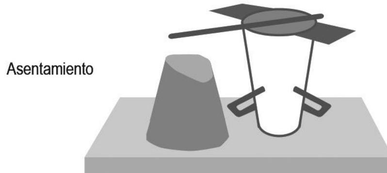
Figura 28. Medición del Asentamiento
