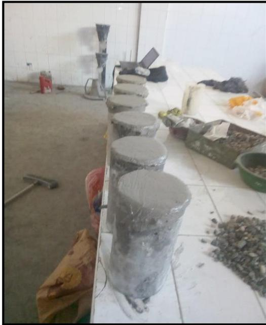
**FOTO N°31:** Secado del diablo fuerte durante 3-5 horas de realizar el ensayo de compresión.
