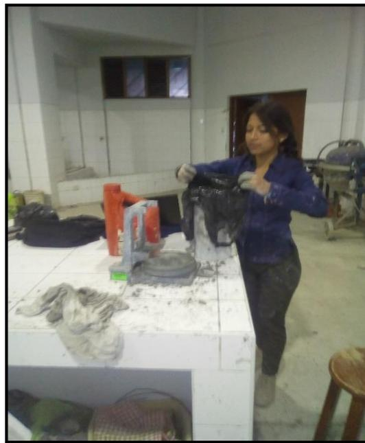
**FOTO N°30:** Vista, capping (preparación y colocación de diablo en la parte de la sección superior de los especímenes para obtener una superficie lisa, antes de la rotura de las probetas)
