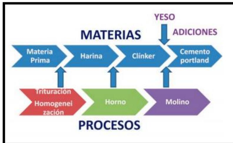
Figura 1. Esquema General de la Fabricación del Cemento
