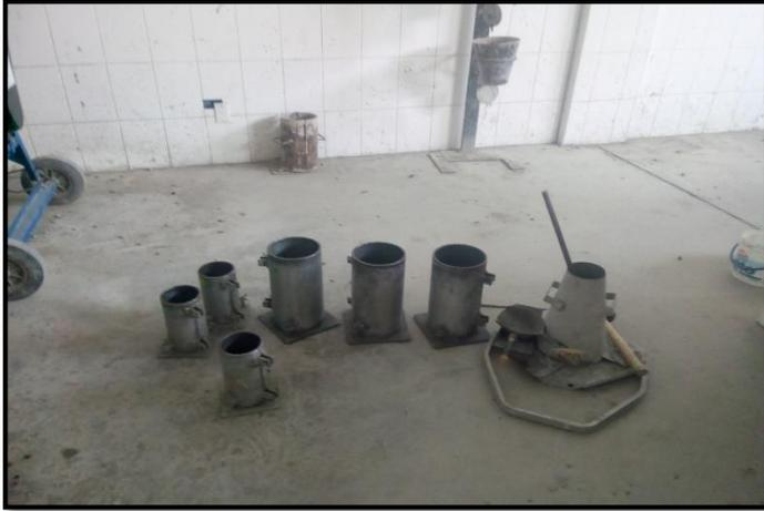
**FOTO N°19:** Vista de las probetas de 30cm \*15 cm, 20cm\*10cm y el cono de abrahms.
