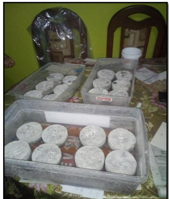
**FOTO N°37:** Colocación de las rodajas de concreto en un depósito con agua para saturar las muestras mediante la absorción capilar.
