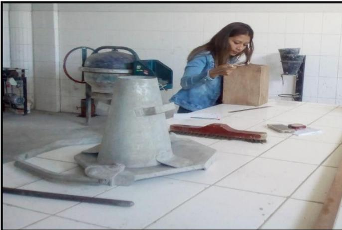
**FOTO N°8:** Se hallaron las medidas del molde de madera para calcular su volumen.
