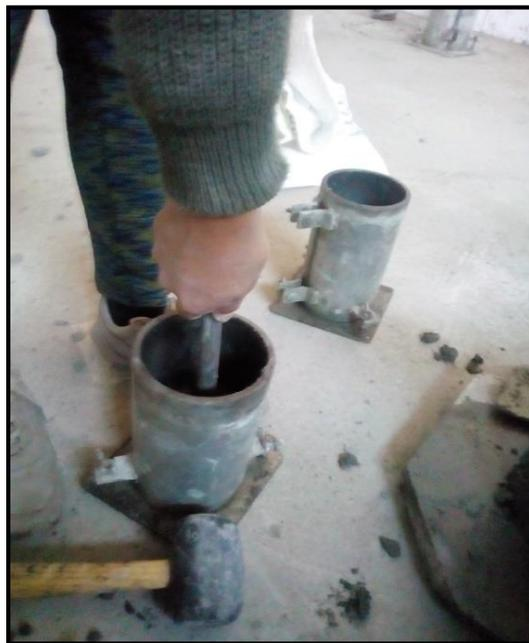
**FOTO N°24:** Compactación por el método de varillado
