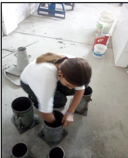
**FOTO N°18:** Se colocó petróleo como desmoldante en las probetas.
