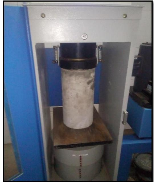
**FOTO N°32:** Rotura de probeta en la maquina electro-hidraulica, para obtención de la resistencia.
