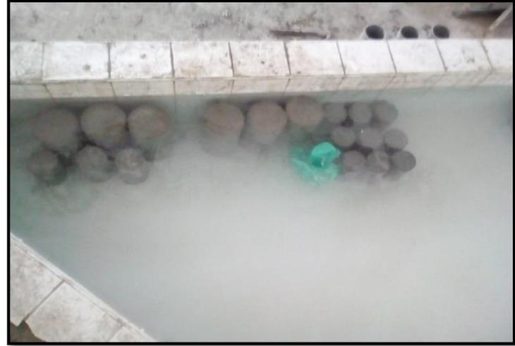
**FOTO N°29:** Colocación de los especímenes de concreto para su posterior curado en agua con cal.
