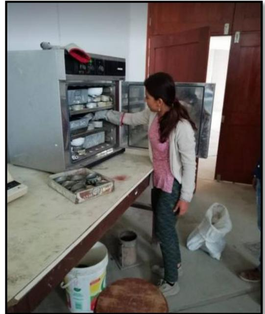
**FOTO N°35:** Colocación de las rodajas de concreto para el posterior secado de las muestras.
