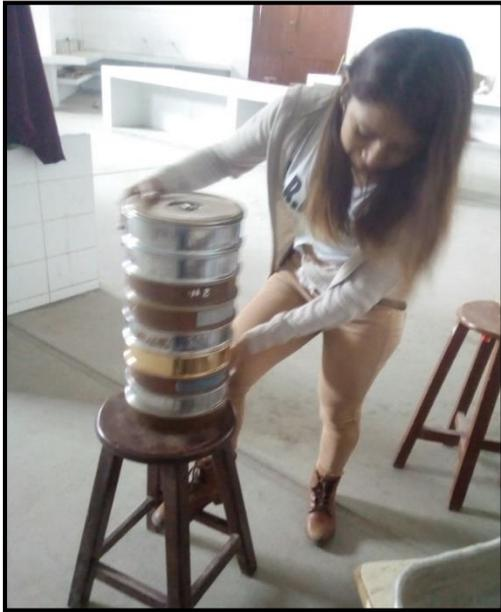
**FOTO N°7:** Vista de la granulometría del agregado fino.
