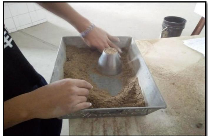
**FOTO N°14:** Vista de la obtención de la arena saturada superficialmente seca
