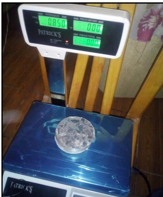
**FOTO N°36:** Pesos de las rodajas de concreto que se realizo progresivamente mediante un tiempo, hasta la saturación total de estas.
