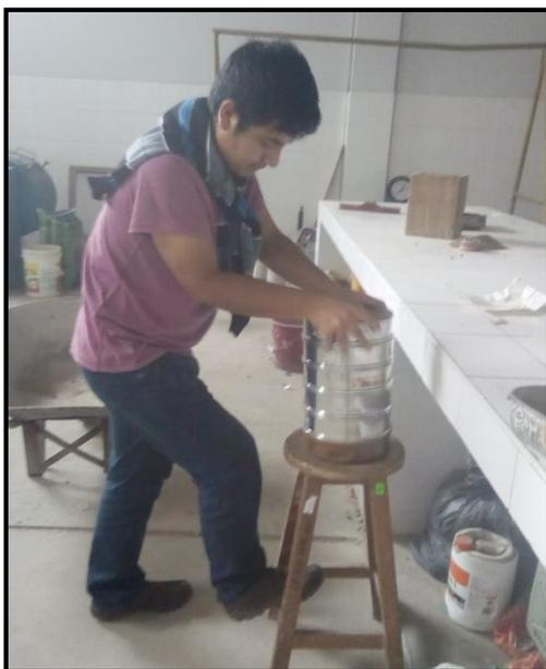
**FOTO N°6:** Vista de la granulometría del agregado grueso.
