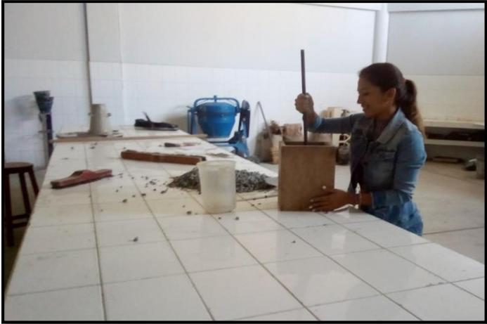
**FOTO N°10:** Vista de la compactación del agregado grueso en el molde, para determinar su peso unitario.
