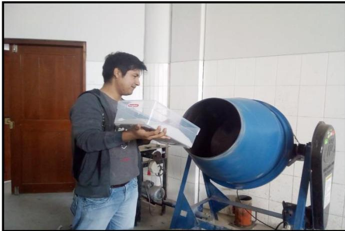
**FOTO N°22:** Se mezcló todos los materiales para la elaboración del concreto.
