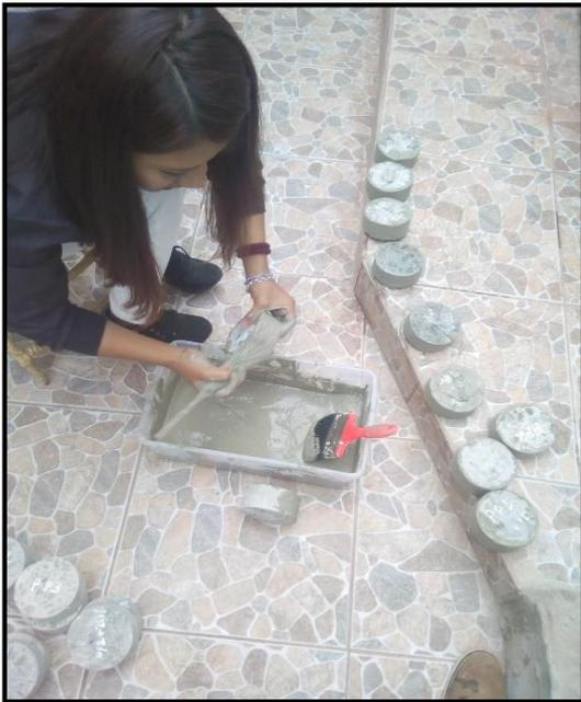
**FOTO N°34:** Impermeabilización de rodajas de concreto de 5 cm mediante un sellador antihumedad
