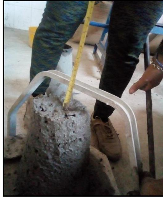
**FOTO N°26:** Vista medición del asentamiento del concreto (Slump).
