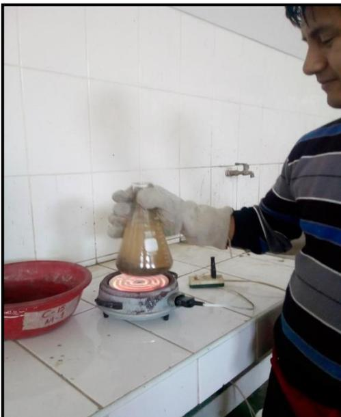
**FOTO N°15:** Vista del calentamiento de la fiola+agua+muestra para eliminar los espacios vacíos.
