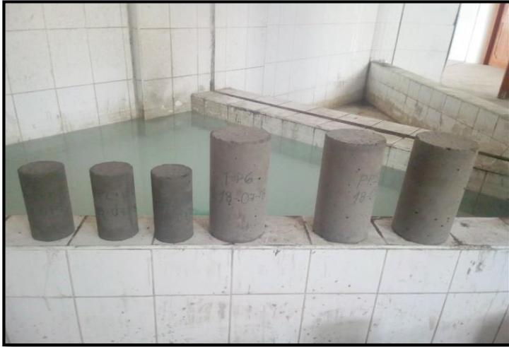
**FOTO N°28:** Desencofrado de los especímenes de concreto.
