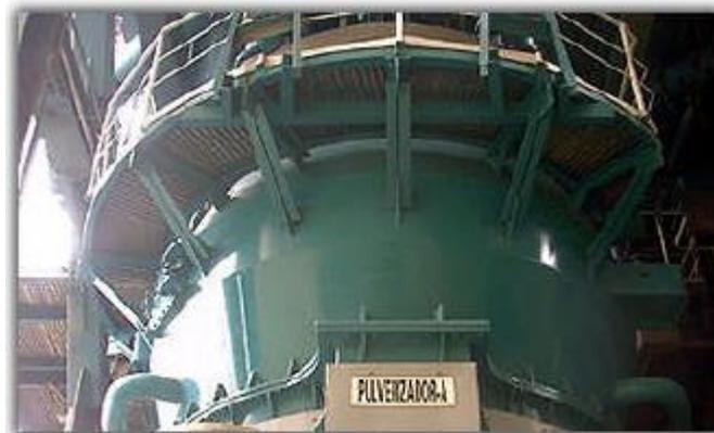
*Figura 12. Pulverizador*
