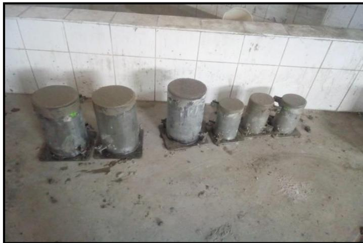
**FOTO N°27:** Vista secado de las probetas durante 24 horas.
