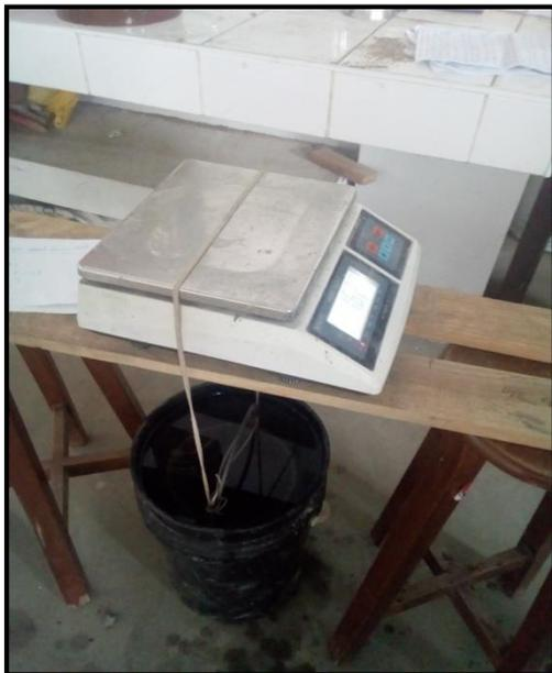
**FOTO N°12:** Vista del procedimiento para determinar el peso específico y absorción del agregado grueso.
