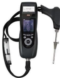
Figura 17. Analizador de gases marca Testo 350
