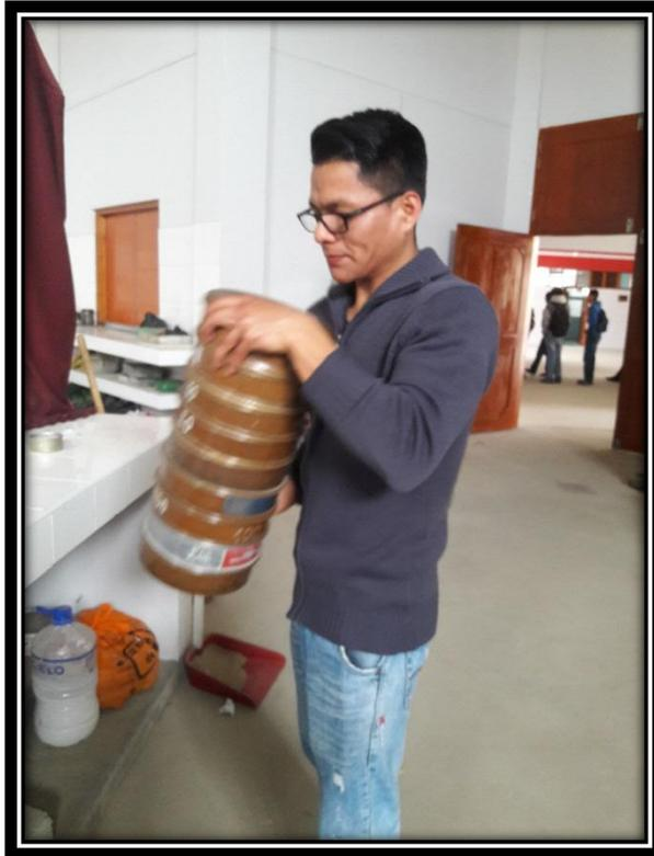
**Figura N°01:** Ensayo de laboratorio, granulometría de suelo, Calicata - 01.
