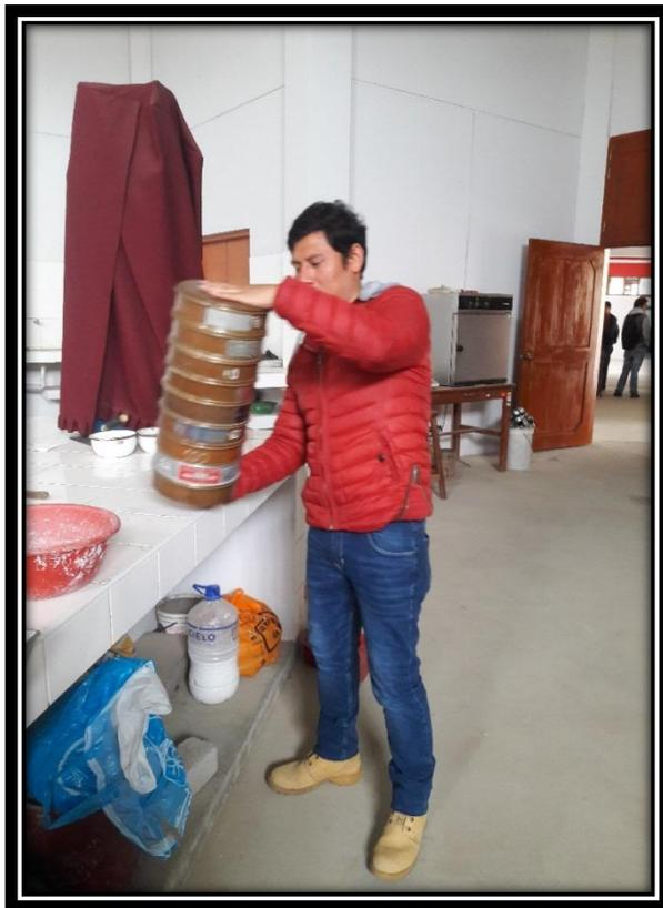
**Figura N°01:** Ensayo de laboratorio, granulometría de suelo, Calicata - 02.
