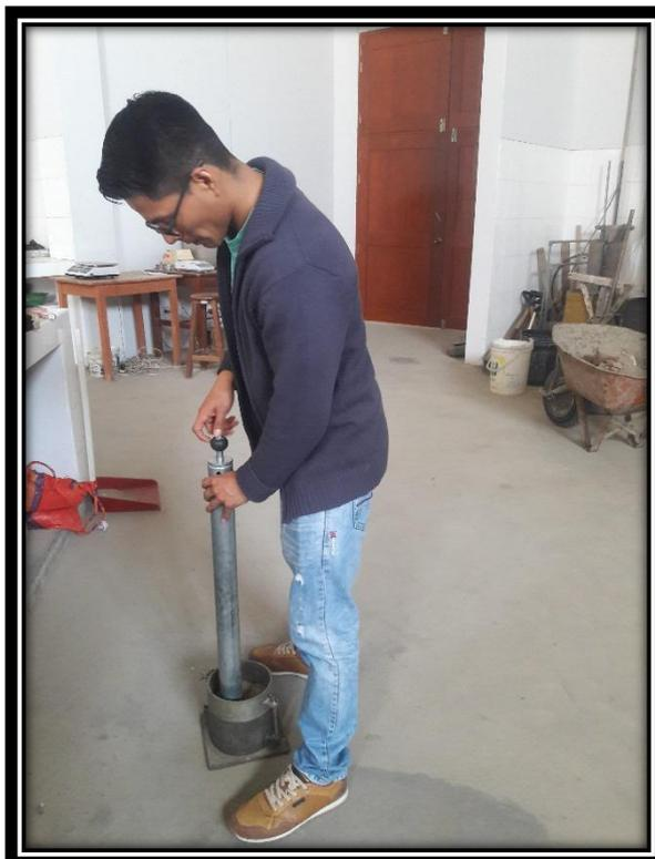
**Figura N°01:** Ensayo de laboratorio, peso volumétrico máximo.
