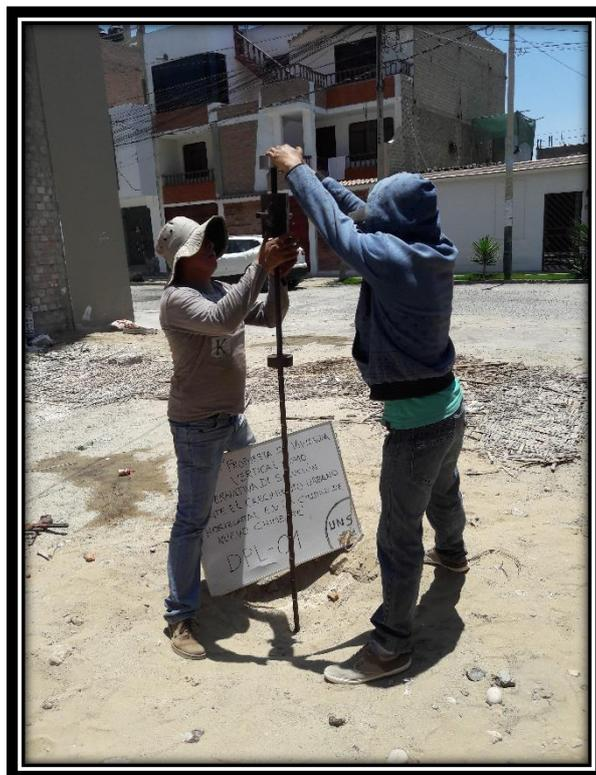
**Figura N°01:** Ensayo de campo, DPL- 01.
