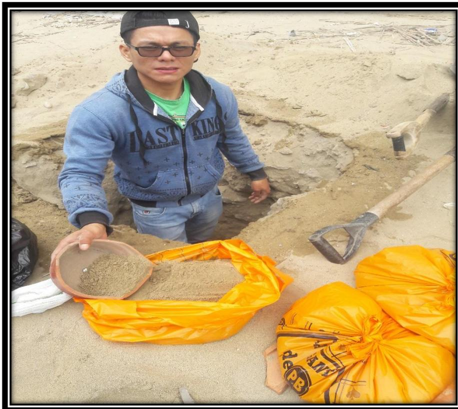
**Figura N°01:** Trabajo de campo, extracción de muestra de suelo C-2 para ensayos de laboratorio.
