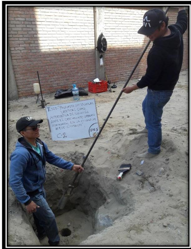
**Figura N°01:** Trabajo de campo, extracción de muestra a una profundidad de 3 metros en C-02.
