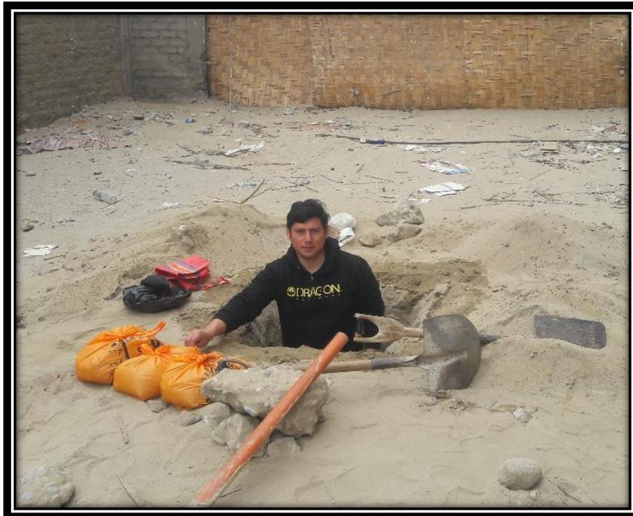
**Figura N°01:** Trabajo de campo, extracción de muestra de suelo C-1 para ensayos de laboratorio.
