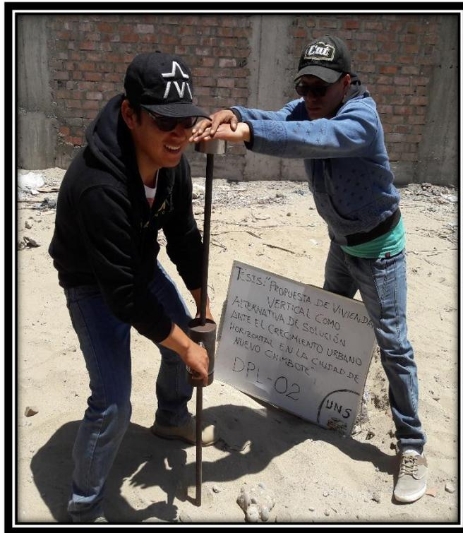
Figura N°01: Ensayo de campo, DPL- 02.
