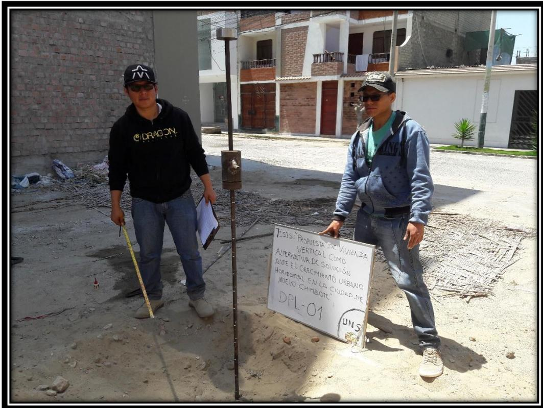
**Figura N°01:** Ensayo de campo DPL- 01, preparación del equipo.
