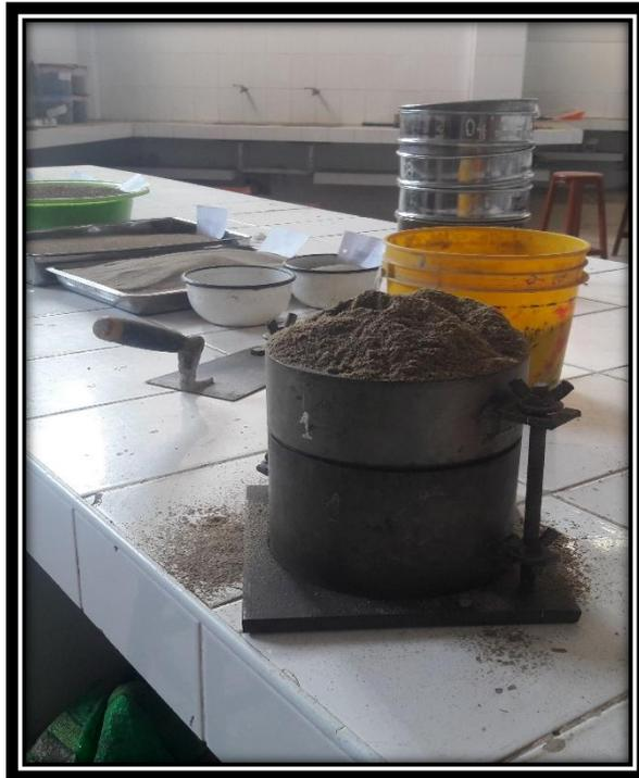
**Figura N°01:** Ensayo de laboratorio, peso volumétrico mínimo.
