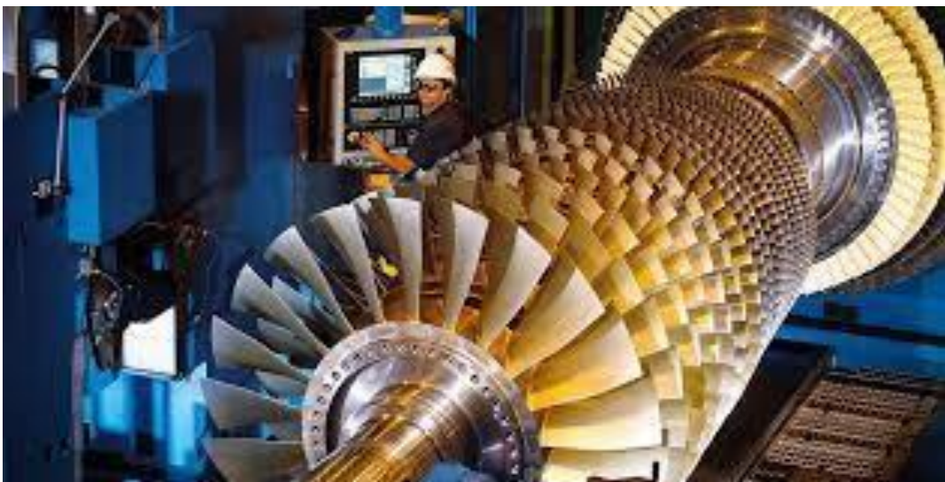
Figura N° 16 Turbina de gas heavy duty
